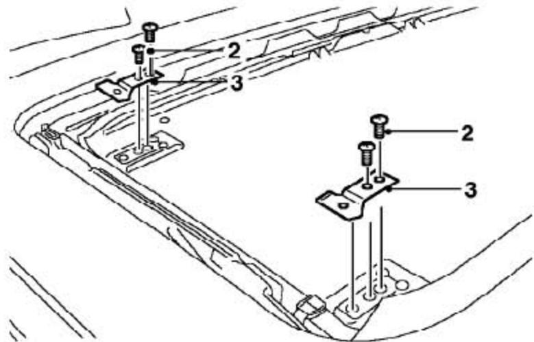
2). 拆下4个固定天窗左侧滑块的螺钉。
