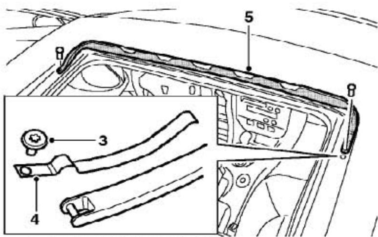
3). 拆下2个固定导流板片簧的螺钉。
