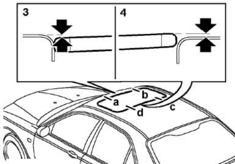
2). 将玻璃总成和车身对齐，对齐点应该在距车身中心线两边300mm的地方，如图上a, b, c, d。
