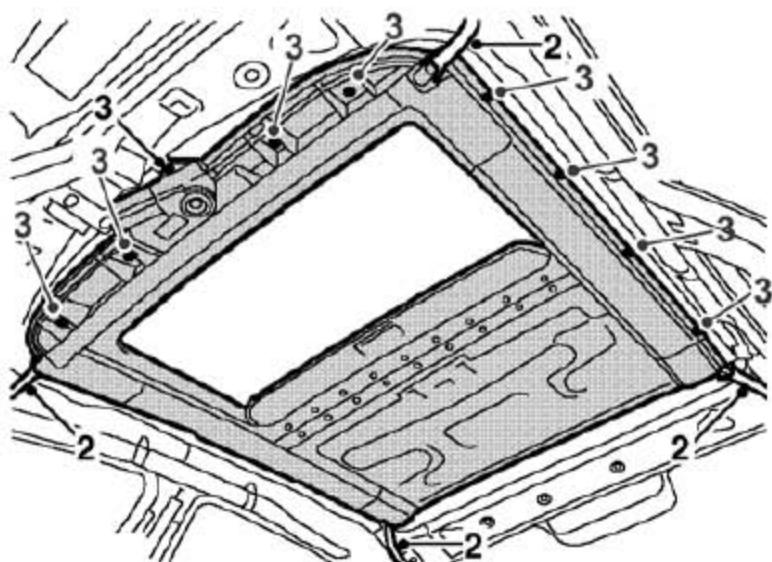
2). 从天窗总成上断开4个排水管的连接。
