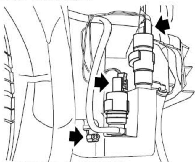
3). 从洗涤泵总成上断开连接器。
