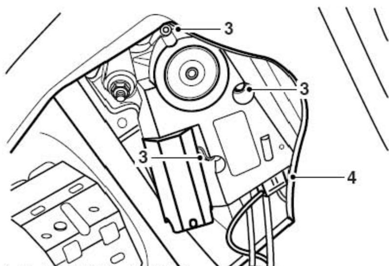
3). 拆下3个固定电机的螺钉。
