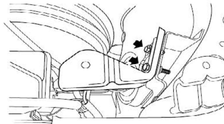
2). 取下2个将刮水器安装支架安装到车身上的螺钉，取下刮水器安装支架。
