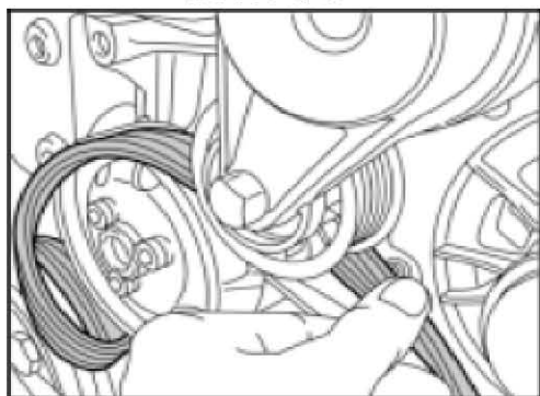
将传动带从张紧滚柱上拆下来。
