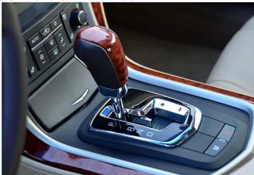
发动机远程启动功能对车辆本身会有一些限制，最重要一点就是只有自动变速器车型才可安装。其原因是自动变速箱会配有 TCU 控制单元，这个装置会将挡位信息告知于 ECU 发动机控制单元，只有当行车电脑确认挡位位于 P 驻车位置时才会启动发动机，这样做是为了防止车辆意外开动，后期加装的则无此保护功能。
