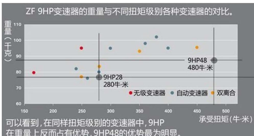
从ZF自己的分析对比图片来看, 9HP不仅在重量上毫不吃亏, 反而还具有一定的优势, 在同样扭矩级别的液力自动变速箱当中, 9HP 重量更轻, 比如9HP28, 含油液重量仅 78 千克, 要知道在重量上天生占有优势的大众和福特的两台干式双离合变速箱也不过 72-73 千克的水平。
