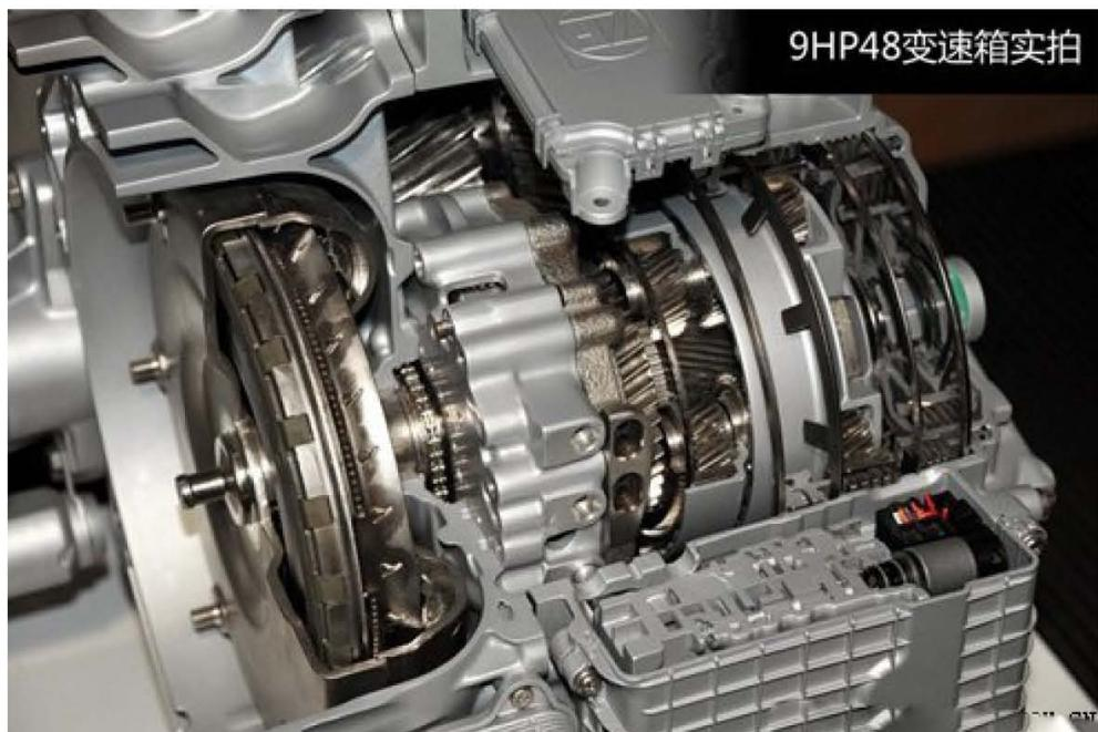
9HP 的液压控制单元（也就是滑阀箱）位于变速箱侧面，高精度的电磁阀是响应速度和换挡质量的保证。TCU--变速箱控制单元则布置于变速箱箱体的顶部，9HP 的 TCU 在运算性能上与采埃孚纵置的 8 速自动变速箱相当，并且还有提高速度的潜力。
