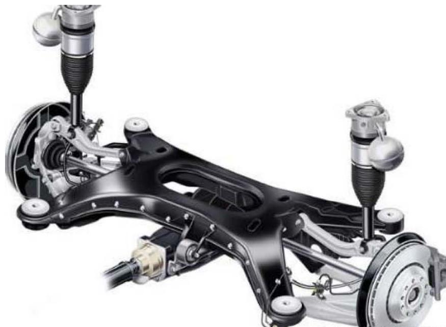
通常来讲，装备空气式可调悬架的车型前轮和后轮的附近都会设有离地距离传感器，按离地距离传感器的输出信号，行车电脑会判断出车身高度变化，再控制空气压缩机和排气阀门，使弹簧自动压缩或伸长，从而降低或升高底盘离地间隙，以增加高速车身稳定性或复杂路况的通过性。
