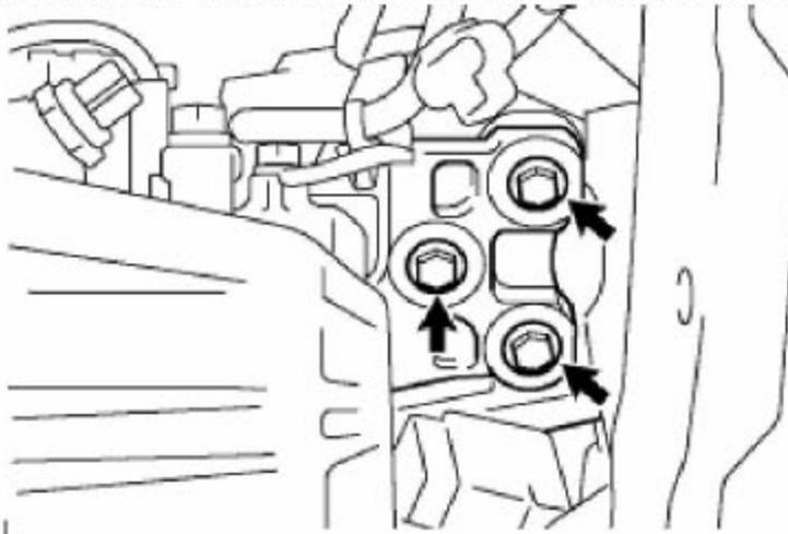
3). 拆除发动机左悬置软垫带支架总成与左前纵梁上的 3 个螺栓。
