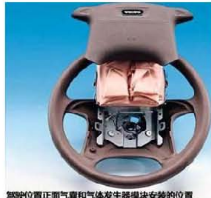
驾驶位置正面气囊和气体发生器模块安装的位置
