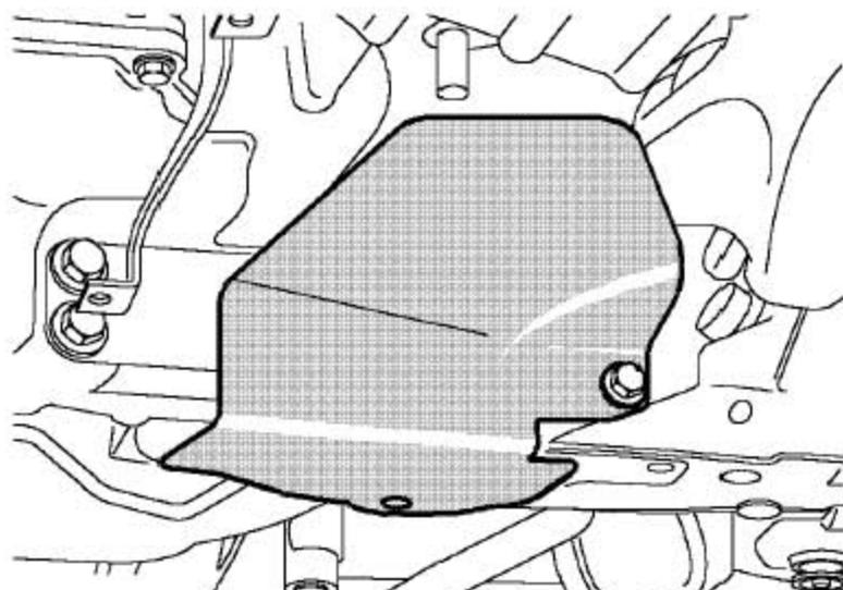
2). 拆下转向横拉杆隔热板螺栓和夹箍，取下转向横拉杆隔热板。
