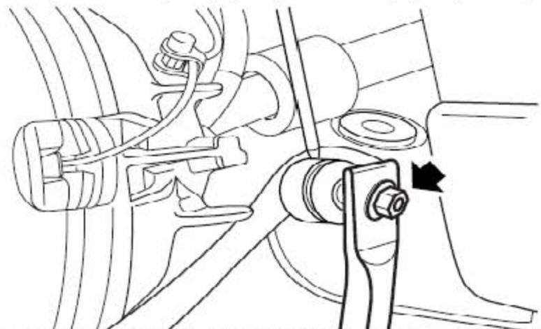
5). 拆下固定到前横向稳定杆连接杆上的螺母，并从前横向稳定杆上松开前横向稳定杆连接杆。
