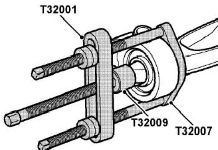
2). 用T32001, T32007 和T32009 拆下前下摆臂衬套和支架总成。
