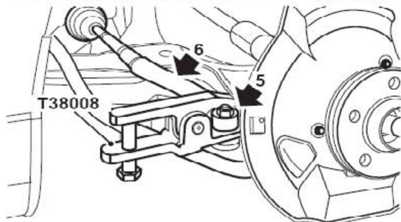
5). 拆下把转向横拉杆球节固定到转向臂上的螺母，给转向横拉杆球节装上M10的螺母，与端头平齐。
