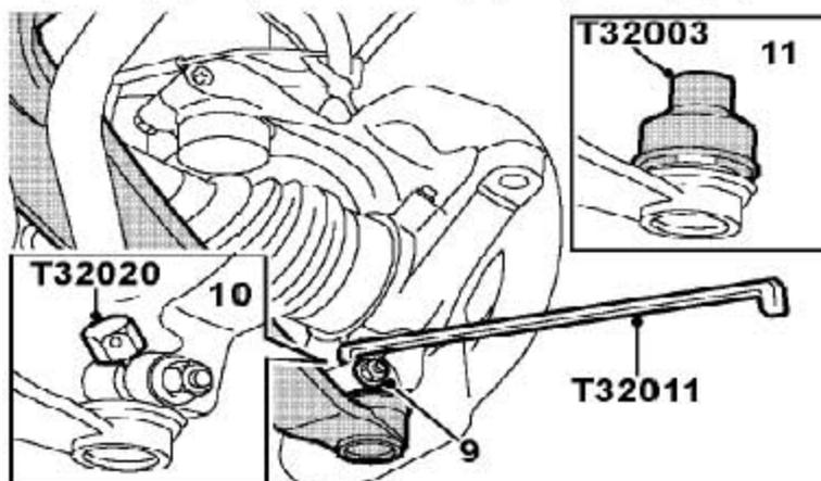
9). 拆下把前下摆臂外球节固定到前轮毂上的螺母和螺栓。
