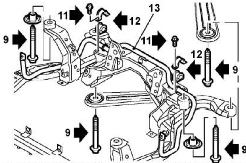
9). 拆下2个把前副车架总成和前副车架支撑杆固定到车身上的螺栓，拆下4个把前副车架总成固定到车身上的后螺栓，收好前副车架安全垫圈。
