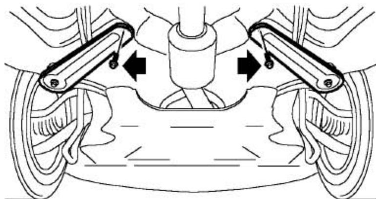
2). 拆下把前副车架支撑杆固定在车身上的螺栓，并废弃不用。
