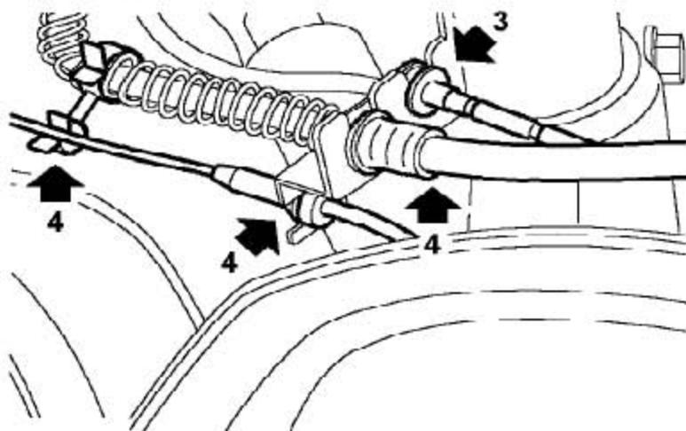
3). 针对右侧：从前减振器柱跨接支架上松开前制动衬块磨损传感器线束。
