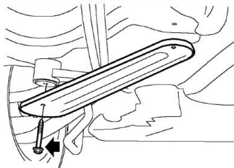
3). 拆下把前副车架支撑杆固定到前副车架总成上的螺栓并废弃，取下前副车架支撑杆。
