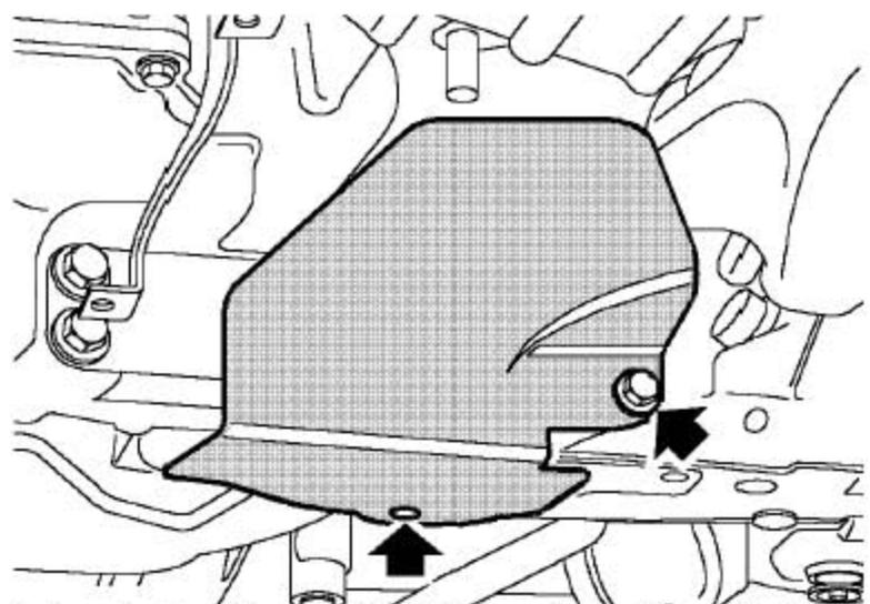
7). 拆下螺栓并松开把转向横拉杆隔热板固定到前副车架总成的夹子。
