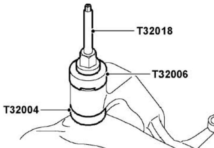
2). 用T32018， T32004 和T32006 装上新的前副车架橡胶衬套。
