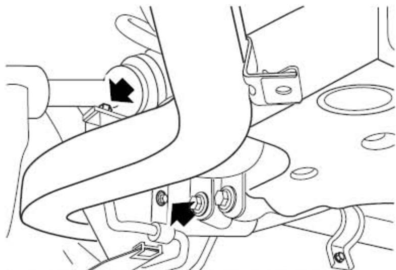
5). 拆下把动力转向机回油管支架固定到前副车架总成上的2个螺栓。
