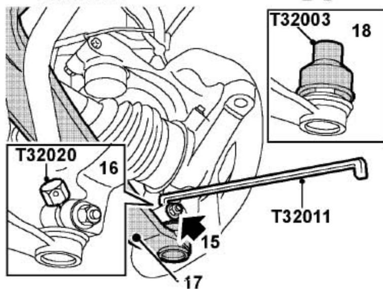
15). 拆下把前下摆臂外球节固定到前轮毂上的螺母和螺栓。
