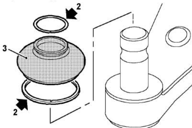
2). 拆卸并废弃2 个把前下摆臂外球节护套固定到前下摆臂外球节上的上下弹簧卡环。
