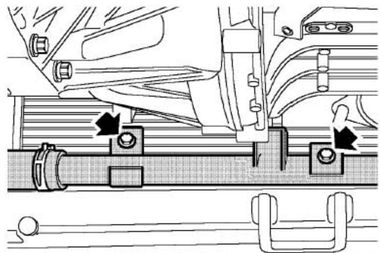
6). 拆下2个把底部软管的连接管固定到前副车架总成上的螺栓。
