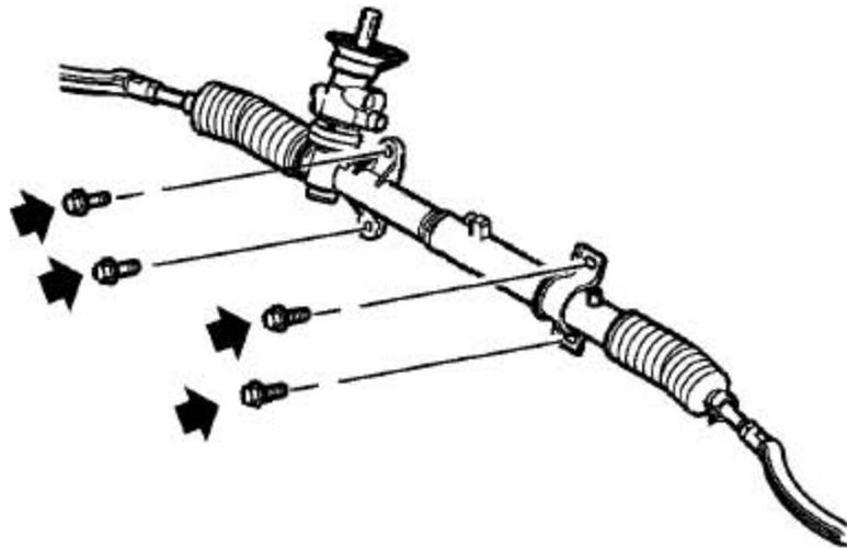
6). 拆下4个把转向机总成固定到前副车架总成上的螺栓并取下动力转向机总成。
