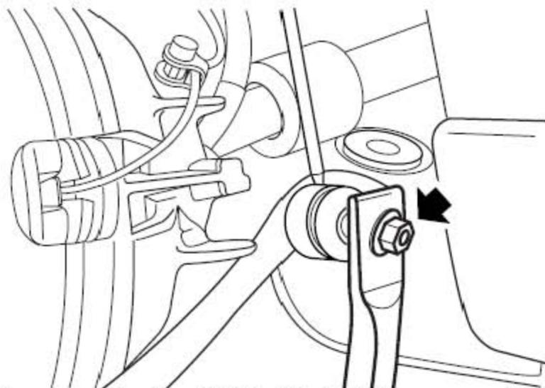
4). 用一开口扳手卡住前横向稳定杆连接杆，以防止前横向稳定杆连接杆球节转动。拆卸固定在前横向稳定杆连接杆上的螺母，并从前横向稳定杆上松开前横向稳定杆连接杆。
