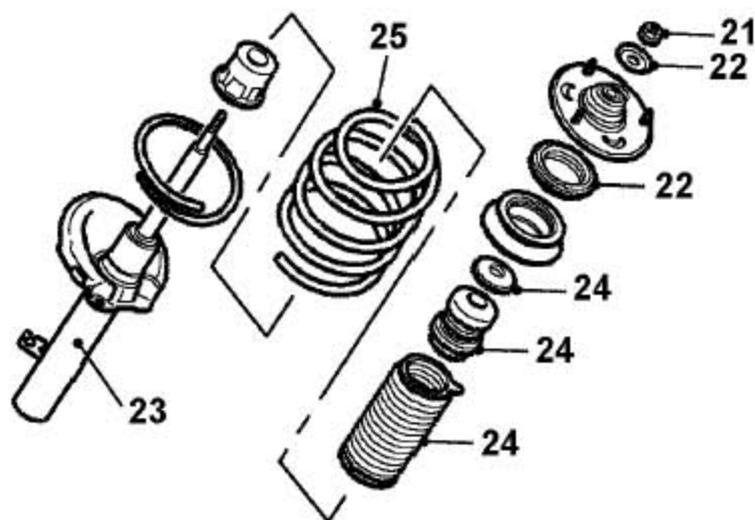
21). 用内六角扳手卡住前减振器柱顶部并拆下柱顶部螺母并废弃。
