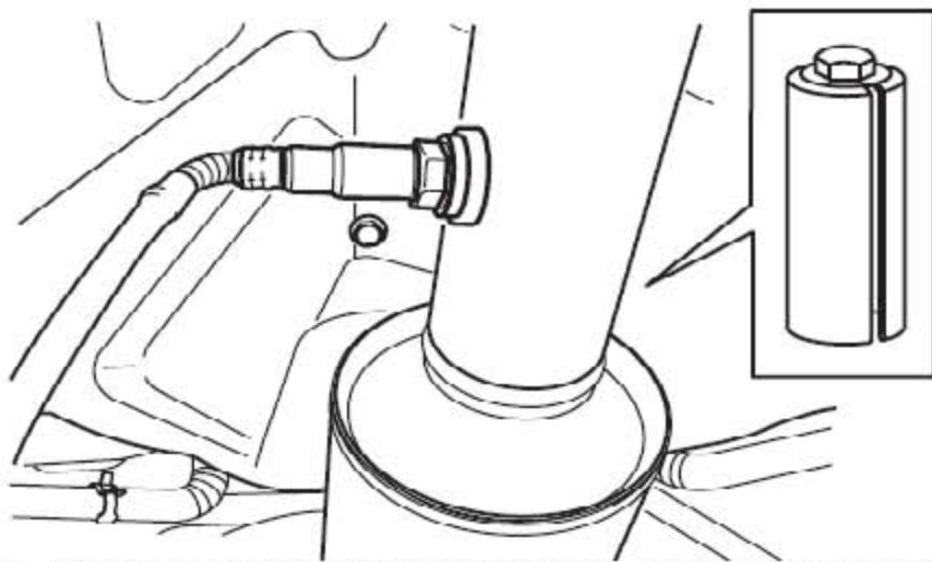
5). 松开并断开热氧传感器连接器的连接，用T16001取下热氧传感器并废弃密封垫圈。
