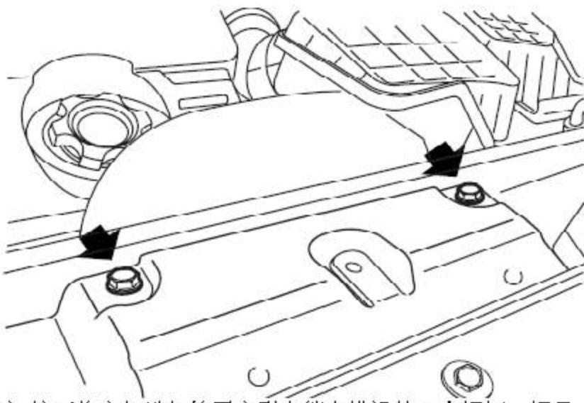
1). 拧下将空气进气管固定到水箱上横梁的二个螺钉，螺母。
