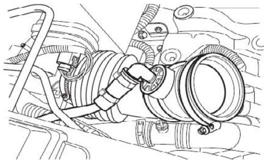
2). 松开把空气进气软管固定到空气滤清器总成上的夹箍（节气门侧）。
