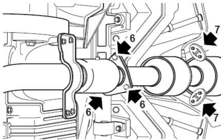
6). 拧下3个把前排气管法兰固定到排气系统上的螺母。
