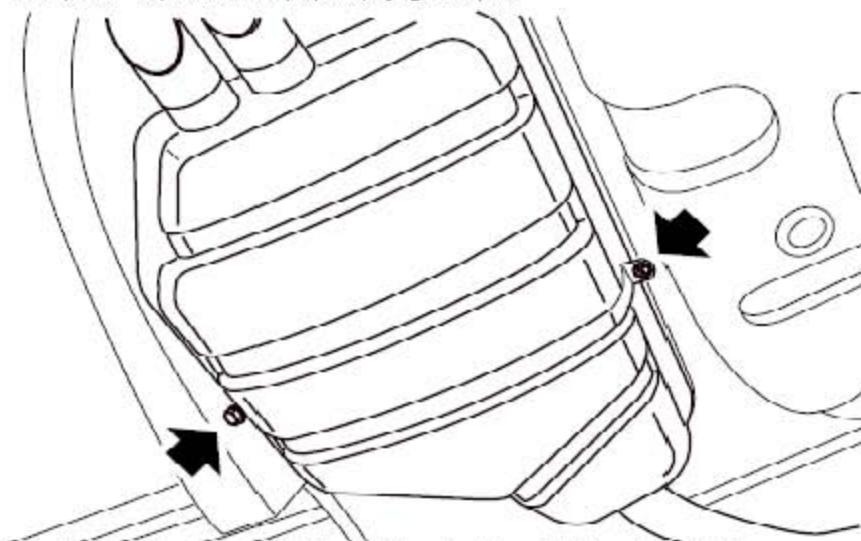
8). 从后消音器安装支架上拧下螺栓，收集好安装支架。
