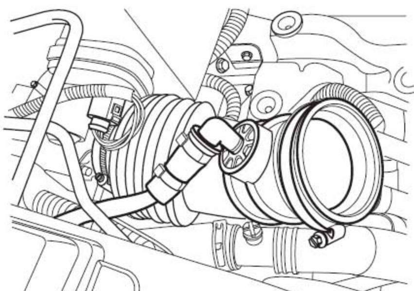
1). 松开把空气进气软管固定到节气门体上的夹箍。
