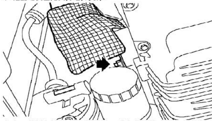
6). 从隔热板上拧下固定到发电机下支架的螺栓并拿开隔热板。
