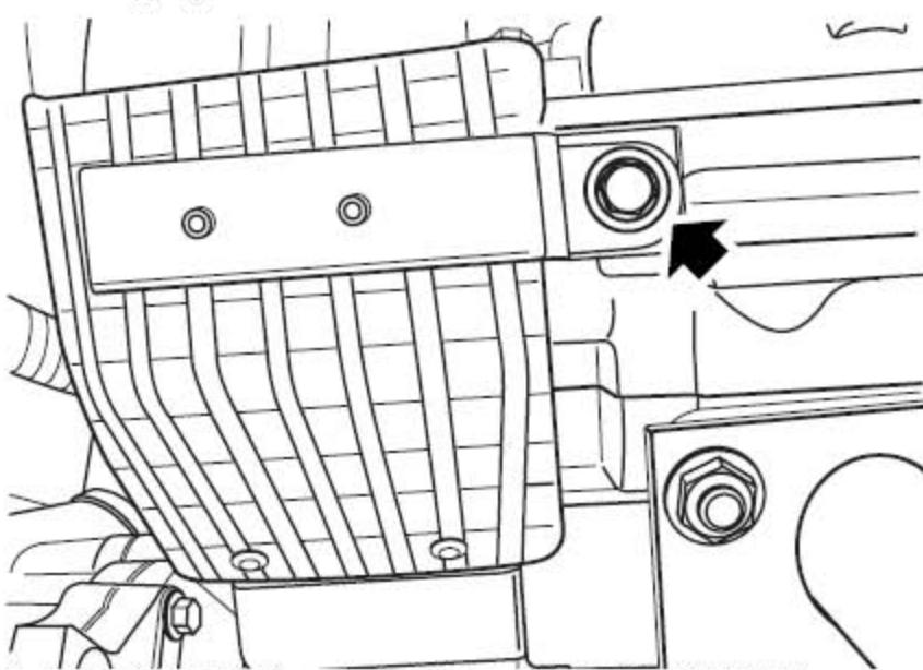
1). 拆下固定隔热板—正时皮带右后罩到排气管的螺钉。
