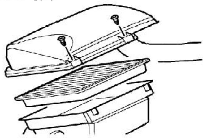
1). 拧下固定空气滤清器盖的2个螺钉。
