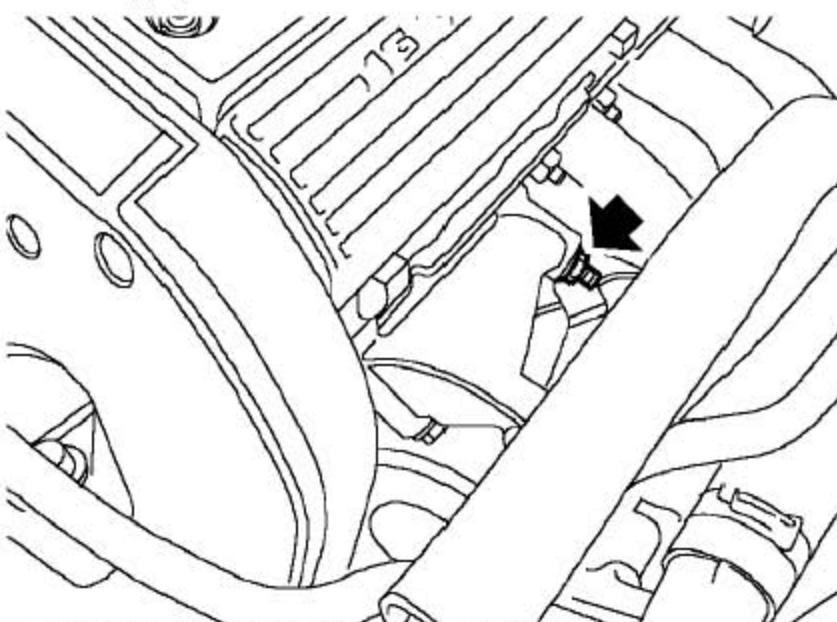
1). 拧下把隔热板固定到发电机上支架的螺母。
