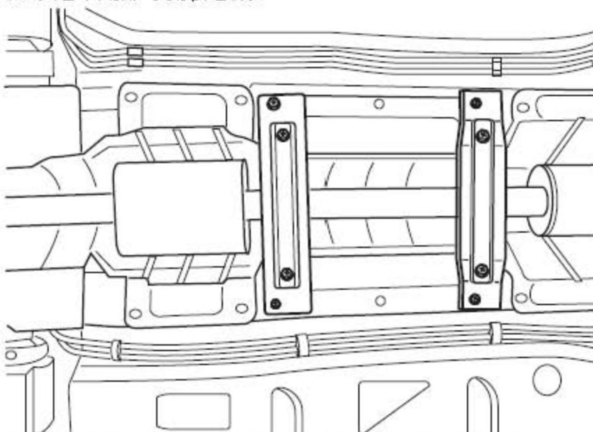
3). 拿开固定2个中央通道板的8个螺栓并拿开通道板。
