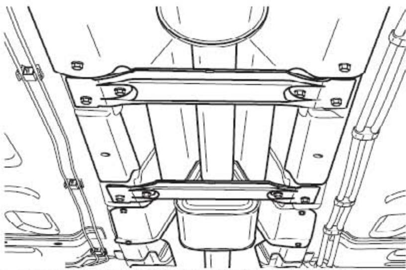
3). 拆下固定2个跨接支架的8个螺栓并拿开交叉支撑。
