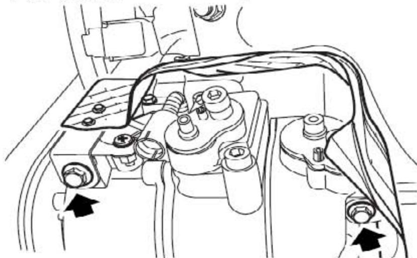
2). 拆下固定隔热板-空调压缩机的螺钉。
