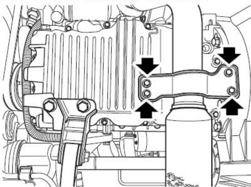
6). 从支架上拧下把前排气管固定到油底壳上的4个螺栓。
