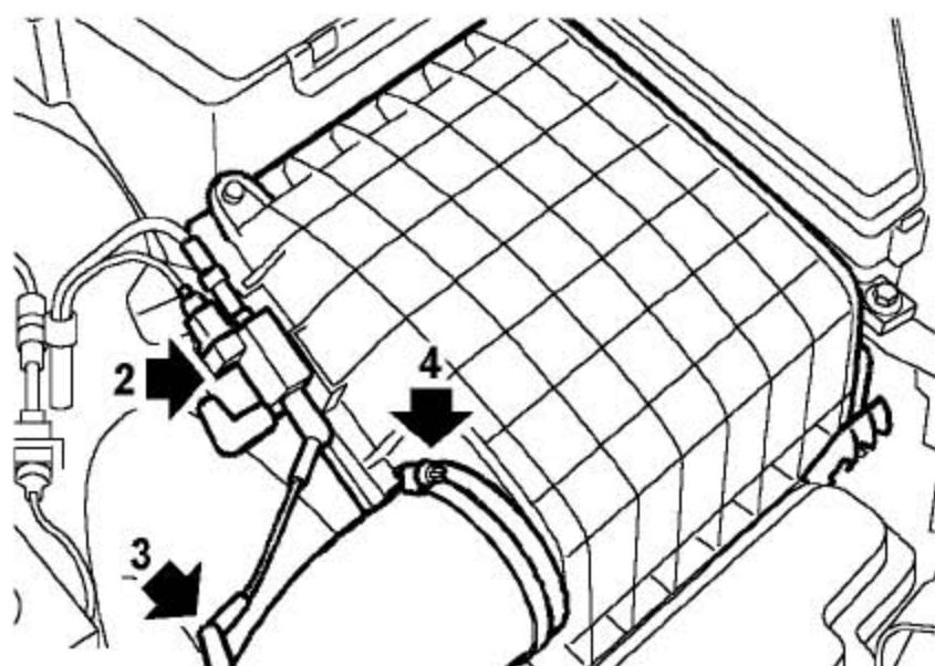
2). 从空气滤清器上松开增压控制电磁阀。
