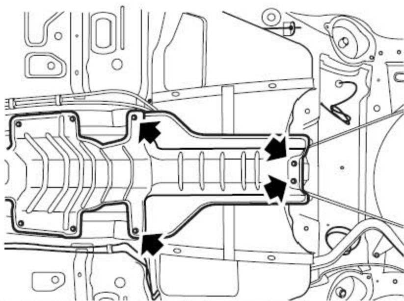
2). 拧下固定隔热板的14个螺钉，取下隔热板。
