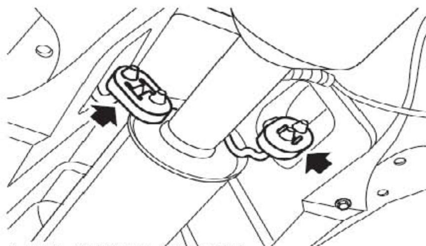
7). 从排气管的前面松开橡胶安装件。
