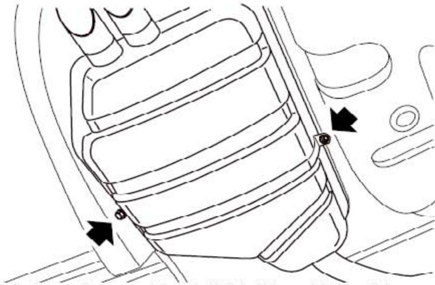
9). 拿开2个固定后消音器安装支架的螺母并收集好支架。
