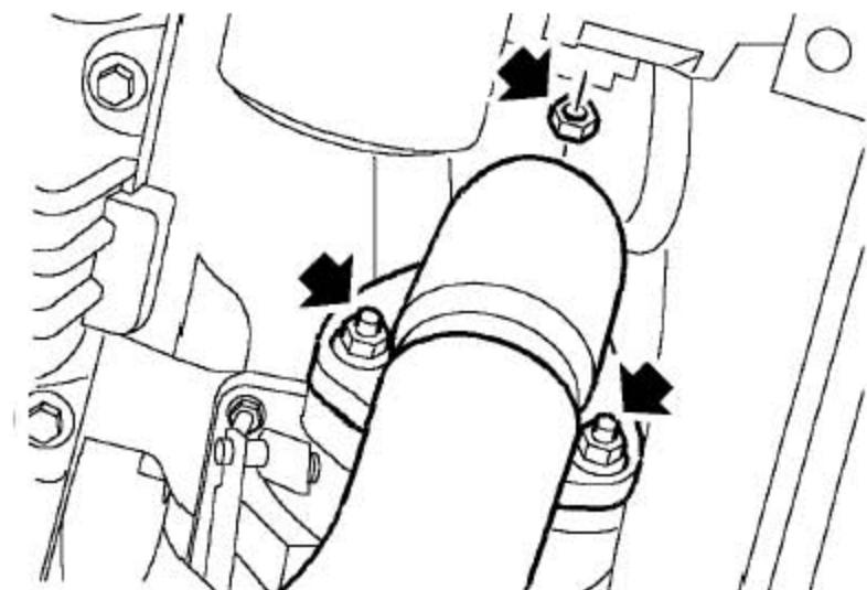
13). 针对1.8T 车型：拆下把排气管固定到涡轮增压器上的3 个螺母和螺栓。
