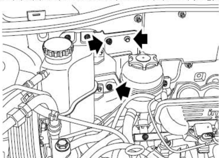
4). 针对1.8T 车型：拧下把动力转向储液罐固定到支架上的2 个螺母和1 个螺栓，松开固定动力转向储液罐出油管和回油管的2 个夹箍。
