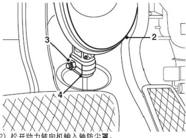
2). 松开动力转向机输入轴防尘罩。
