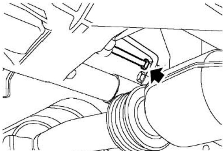
3). 拆下把动力转向机进油管固定到动力转向机上的对接螺栓，拆下密封垫圈并废弃。
