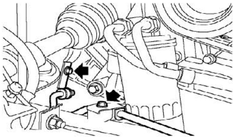
4). 拆下把动力转向机出油管固定到前副车架总成上的2个螺栓。
