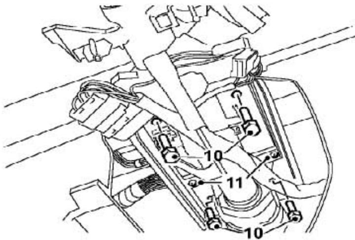
10). 拆下4个把转向管柱固定到转向管柱悬挂支架的螺栓。
