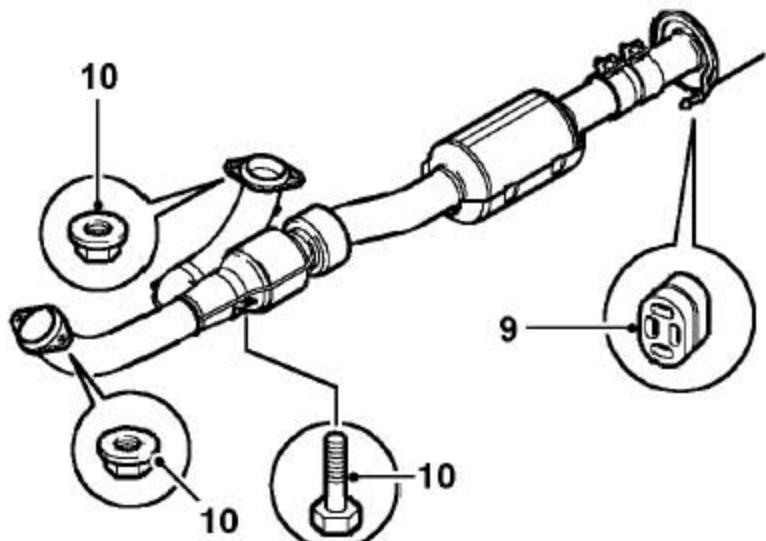
9). 松开排气系统总成的两个前管安装吊块。
