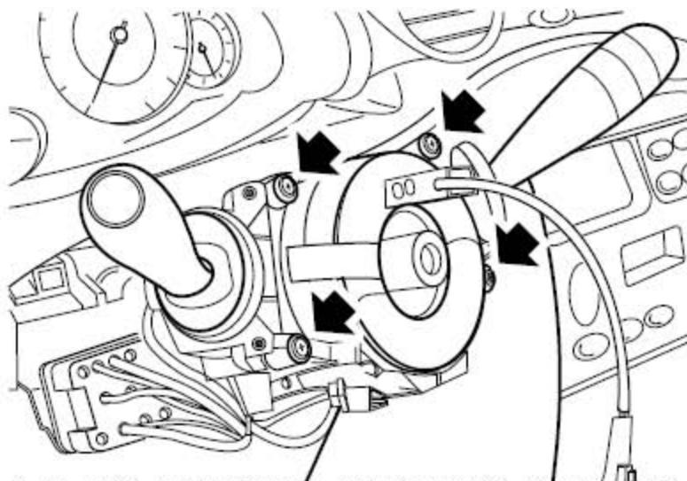
3). 拆下转向柱拨杆把组合开关固定到转向管柱的4个自攻螺钉。
