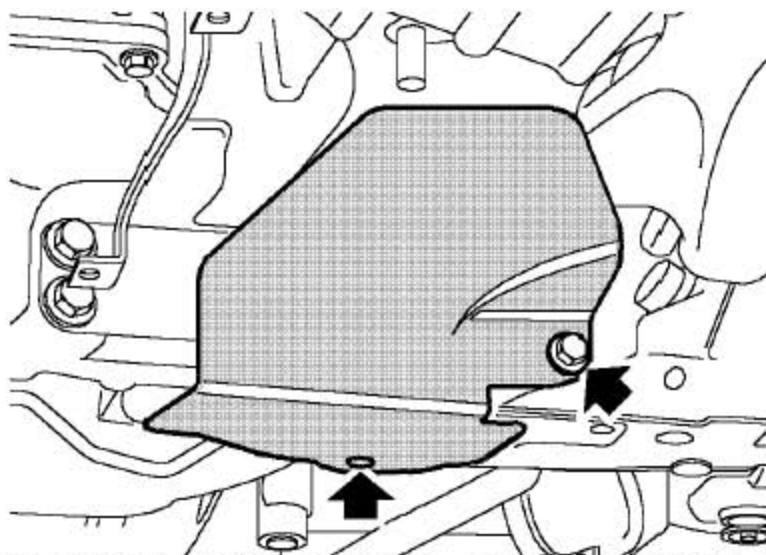
11). 拧下转向横拉杆隔热板螺栓, 拆下夹子, 取下转向横拉杆隔热板。
