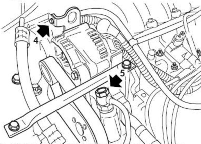
4). 拆下动力转向机进油管固定到支撑支架上的螺栓。
