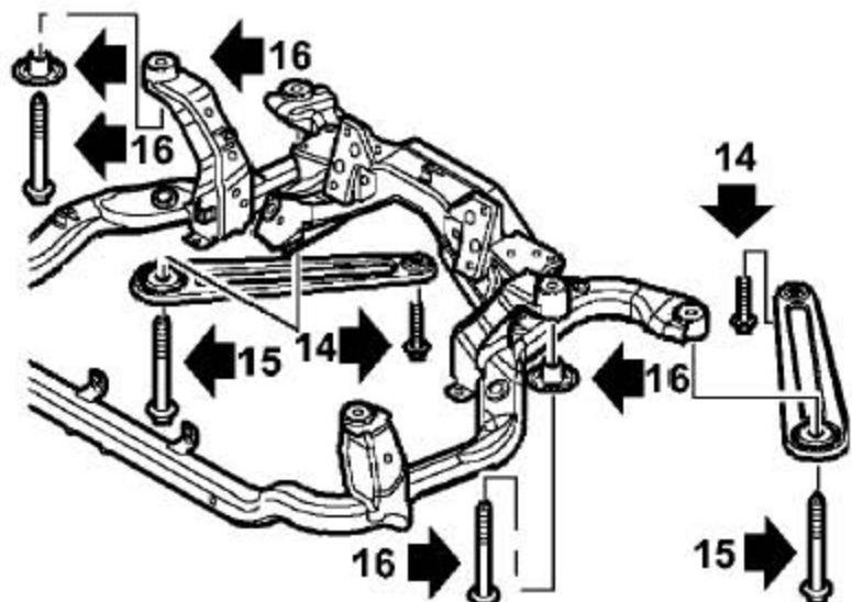
14). 用千斤顶支撑起前副车架的后部。
