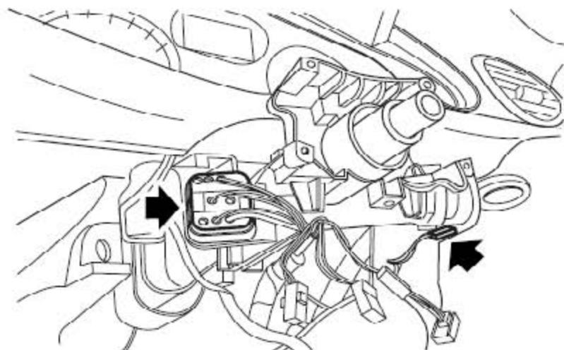
5). 断开点火开关和钥匙密码识别线圈的连接器。
