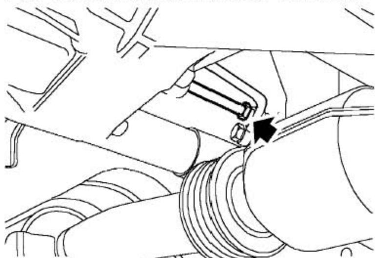
5). 松开把动力转向机出油管固定到转向机上的接头，从动力转向机上拆下动力转向机出油管，取下O形圈并废弃。
