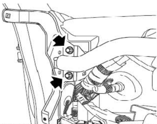
6). 拆下把仪表板骨架总成固定到安装支架总成上的螺钉。
