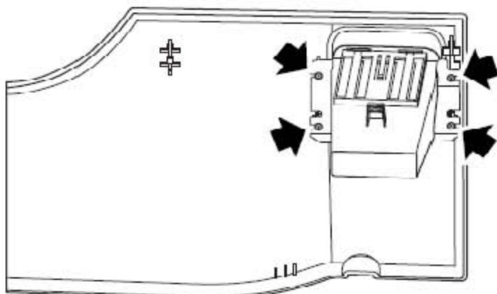
4). 拆下把储物盒总成固定到转向管柱下盖板总成上的自攻螺钉。
