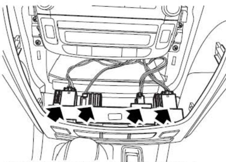
5). 断开开关连接器的连接，并拿开中央面板总成。
