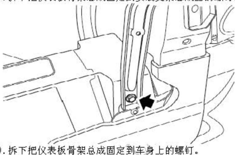
7). 拆下把仪表板骨架总成固定到车身上的螺钉。
