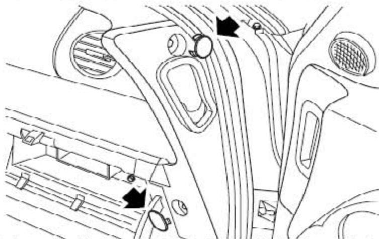
8). 打开手套箱,拿开2个仪表板侧安装护盖和1个仪表板下安装护盖。
