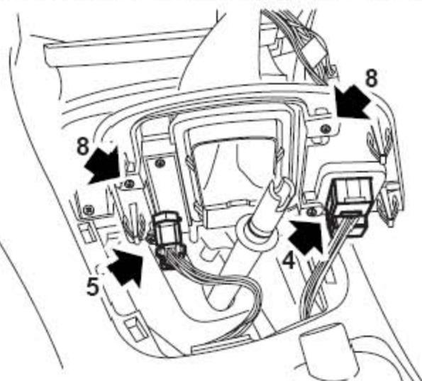
4). 断开变速箱模式控制开关的连接器的连接。
