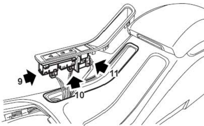
9). 断开报警灯开关的连接器的连接。
