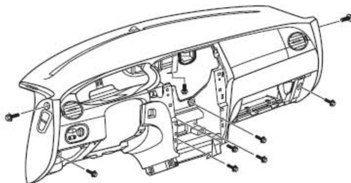
9). 拆下把仪表板总成固定到仪表板骨架总成上的9个螺钉。
