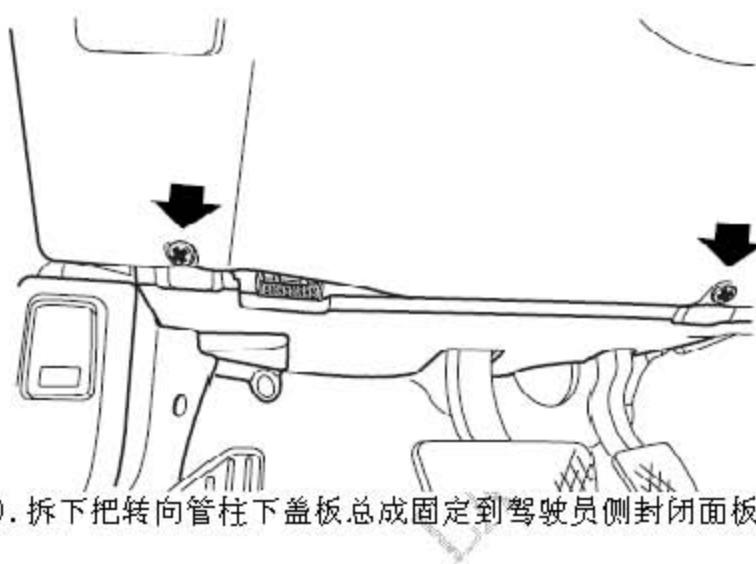
1). 拆下把转向管柱下盖板总成固定到驾驶员侧封闭面板总成上的自攻螺钉。
