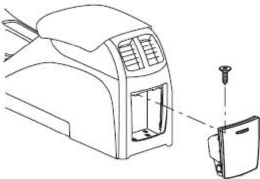
15). 拧开把后烟灰缸总成固定到中控台上的自攻螺钉，拿开后烟灰缸总成。
