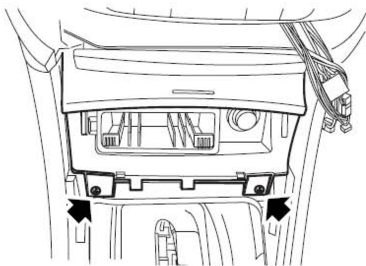
4). 拧开把前烟灰缸总成固定到中控台上的2个自攻螺钉。
