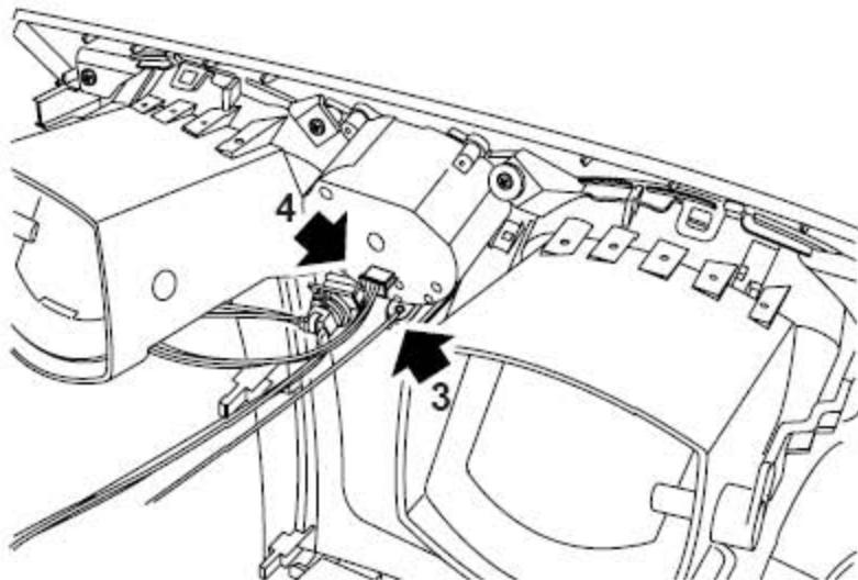
3). 断开冷气旁通拨轮组合件拉线和冷气旁通拨轮组合件的连接。
