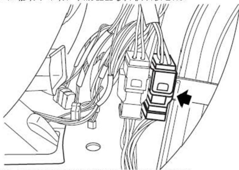
11). 断开主线束和仪表板线束的连接器的连接。
