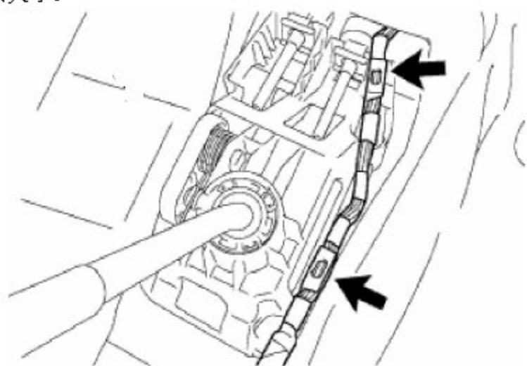
B). 拆下 4 个螺栓和换档支座。
