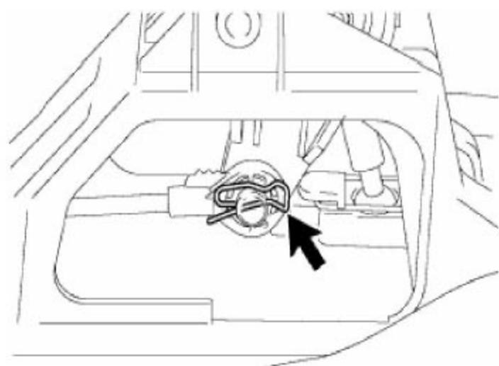
4).拆下换档操纵机构支架组件
