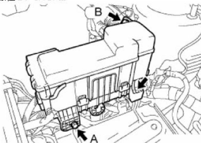
8) 安装电池卡扣的螺栓
