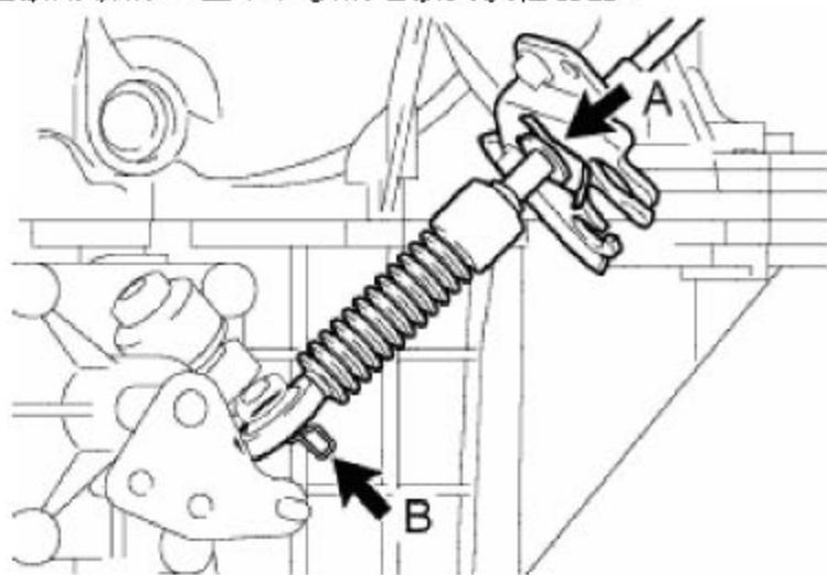
B). 将换档拉索用新的 E 型卡和锁销连接到换档器上。
