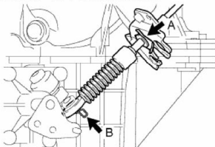
B).将换档拉索用新的 E 型卡和锁销连接到换档器上。
