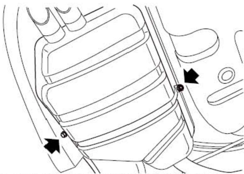
6). 拆下2个固定后排气管安装带的螺母和螺栓并取下后排气管安装带，放低并支撑住排气管总成。
