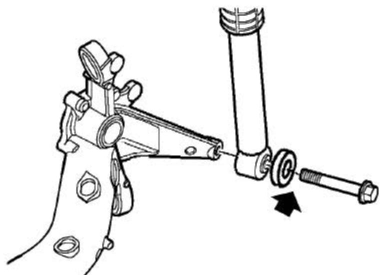
7). 拆下把后减振器总成固定到纵臂总成上的螺栓和后轴动力缓冲器。
