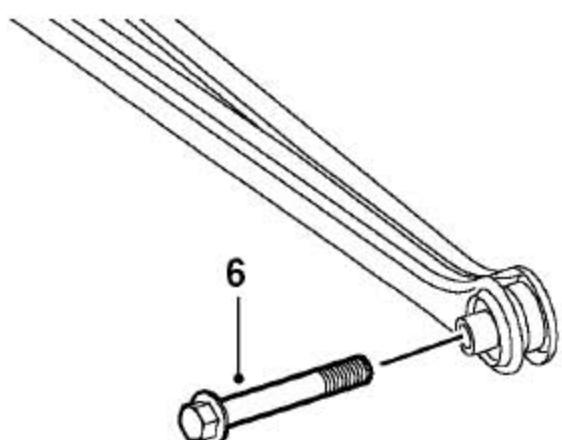
6). 拆下把后下摆臂总成连接到后副车架总成上的螺栓。
