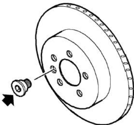
5). 拆下固定后鼓式制动通风盘的沉头螺钉。
