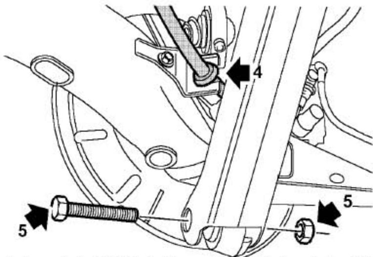
4). 从纵臂总成的支架上松开后制动软管并用千斤顶支撑起纵臂总成。不要把纵臂总成挂在制动软管上。
