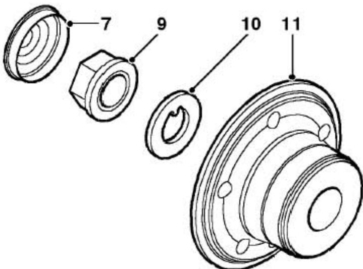
7). 从后轮毂总成上拆下后轮毂油脂帽并废弃。
