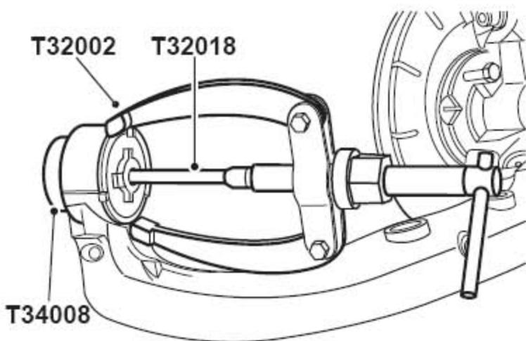
5).用工具T32002，T32018和T34008拆下纵臂衬套。
