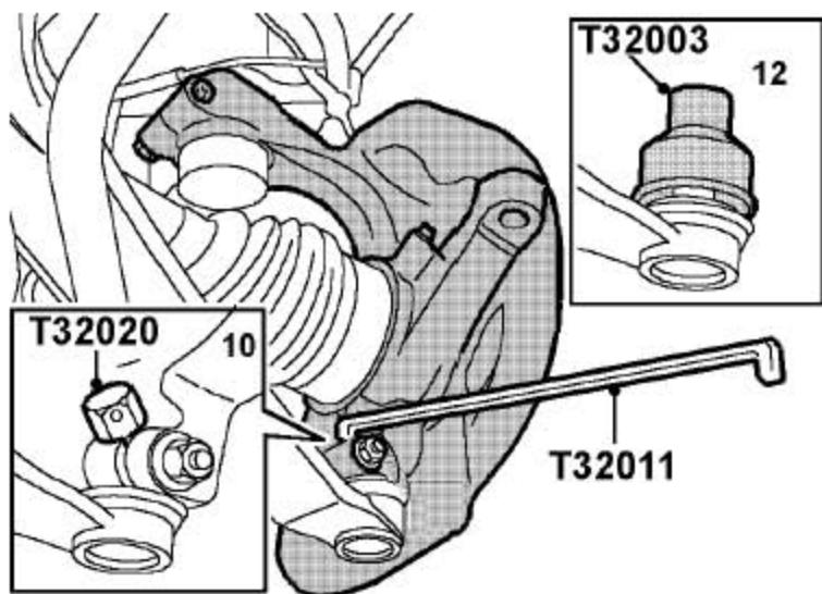
11). 拆下把前轮毂固定到前下摆臂上的螺母和螺栓。
