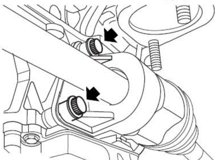
3). 拧下把右驱动轴轴承座固定到发动机缸体的2个螺栓。 (1.8T 此处有3 个螺栓)
