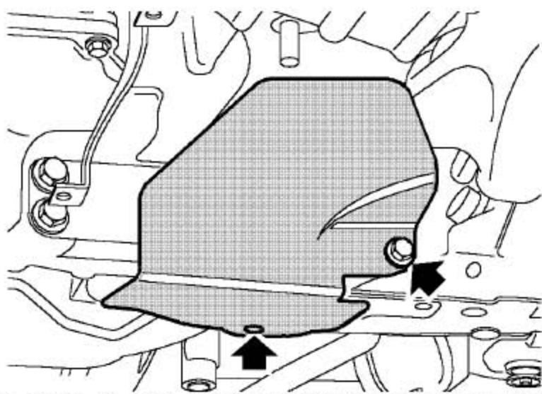
2). 针对2.5L 车型，拧下螺栓并松开转向横拉杆隔热板卡扣，取下转向横拉杆隔热板。
