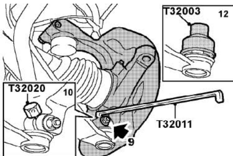
9). 拆下把前轮毂固定到前下摆臂上的螺母和螺栓。
