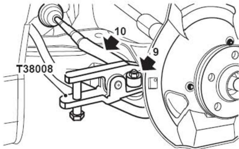
9). 从转向横拉杆端部拆下螺母，把M10 的螺母装到转向横拉杆球节上，与球节的端面平齐。
