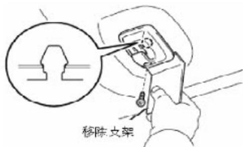
提示:对于两边的固定支架,采用同样的方法移除。
