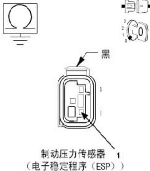
9). 检查 (B84) 制动压力传感器信号电路输出
