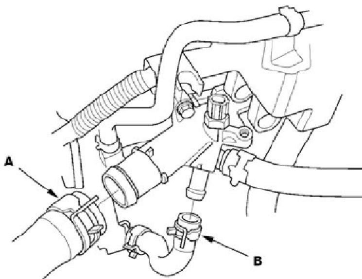
6) . 连接发动机温度(ECT)传感器1插头。
