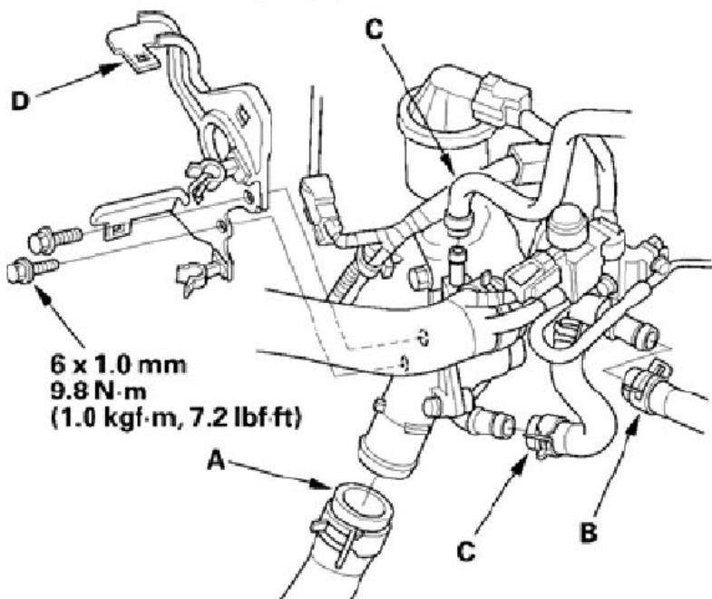
7) . 向散热器内加注发动机冷却液，打开加热器阀，排放冷却系统内的空气。
