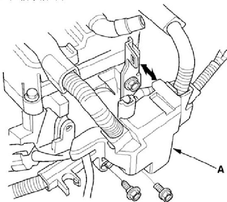
4) . 断开发动机冷却液温度(ECT)传感器1的插头。
