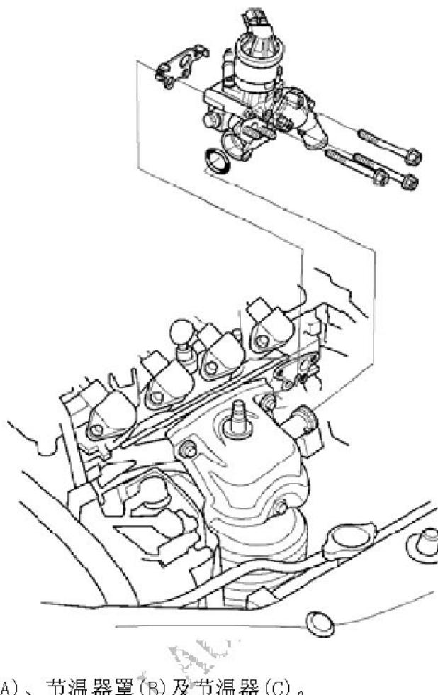
6). 拆下EGR 阀(A)、节温器罩(B)及节温器(C)。
