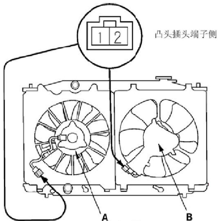
2) . 将蓄电池电源与2号端子相连，并将1号端子与地线相连，测试电机。
