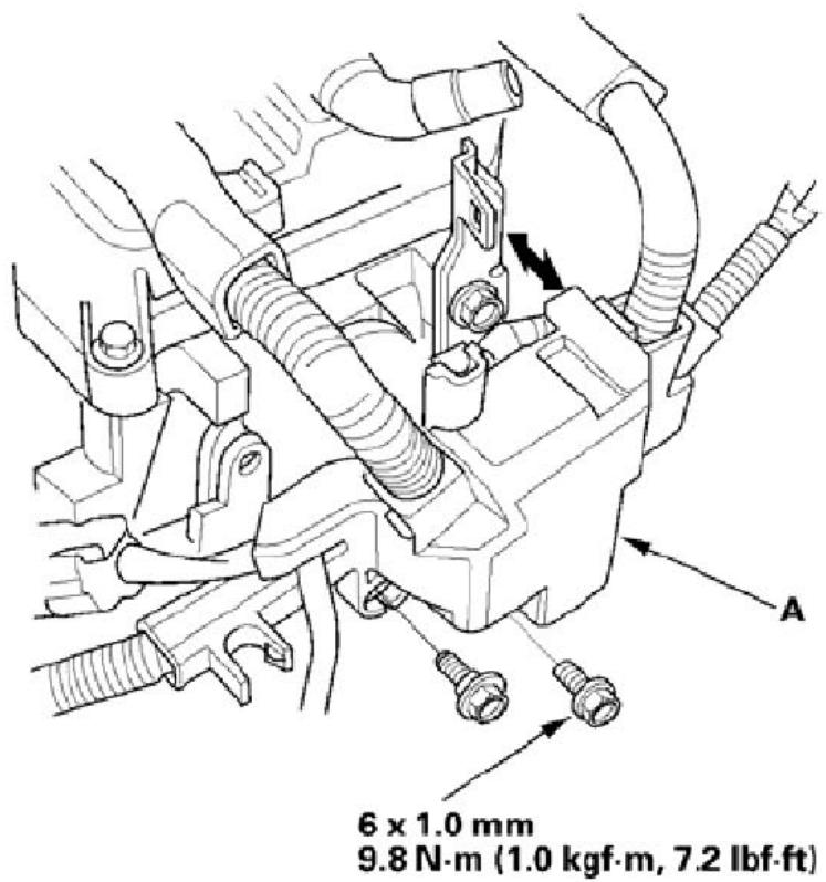
8) . 安装发动机装配座控制电磁阀装配螺栓。
