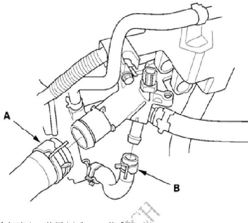
6) . 拆下冷却液出口装置(A)和ECT 传感器1(B)。
