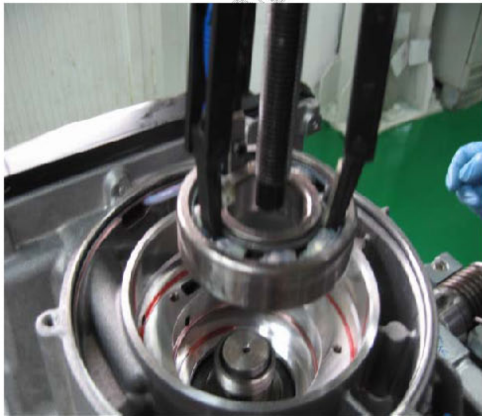
图 6-6: 拆下主动锥轮轴轴承
