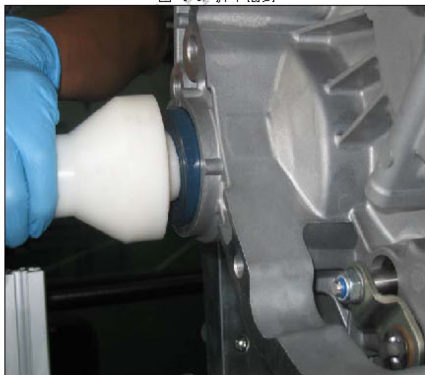
图 1-2 用特殊工具安装新的油封
