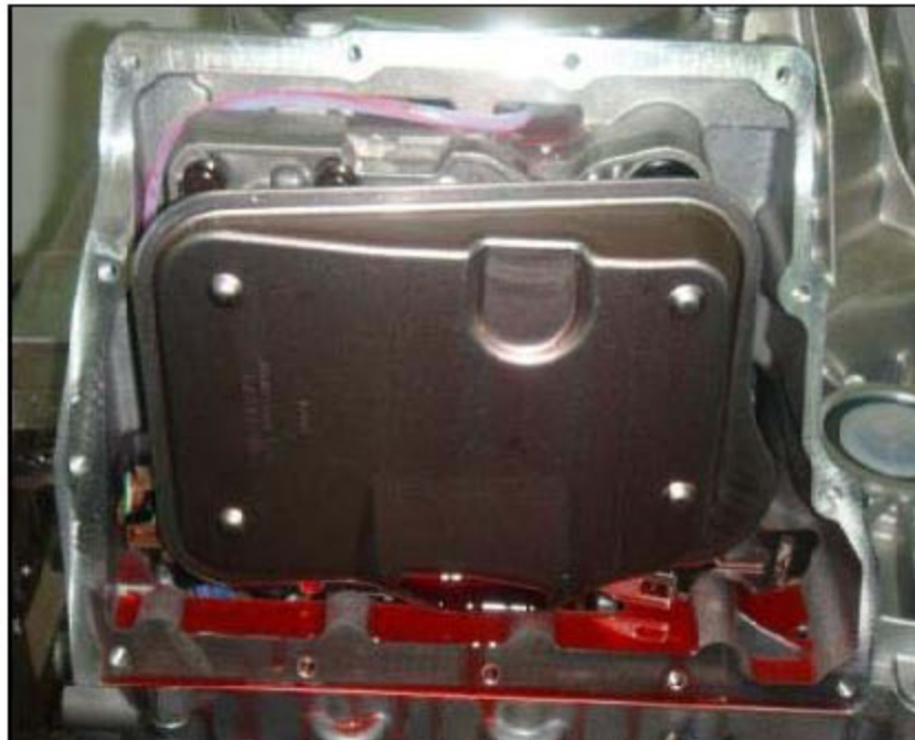
图 9-2: 将滤清安装到位
