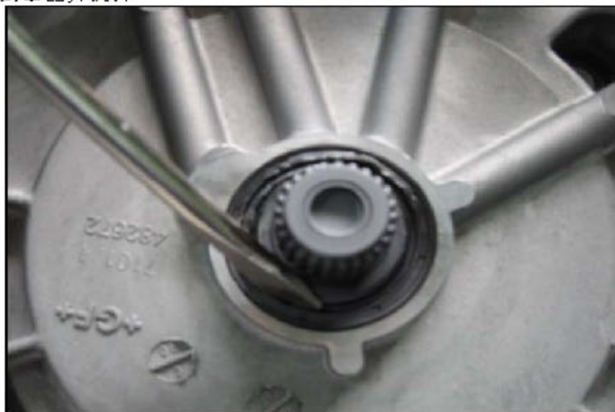
图 2-1: 拆掉输入轴油封
