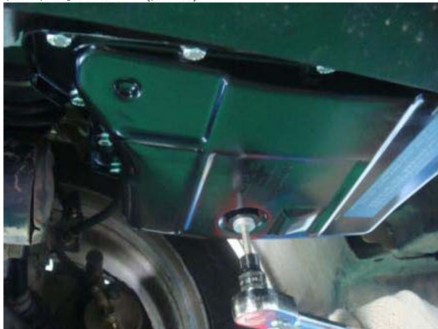
图 8-1 拆下放油螺塞
