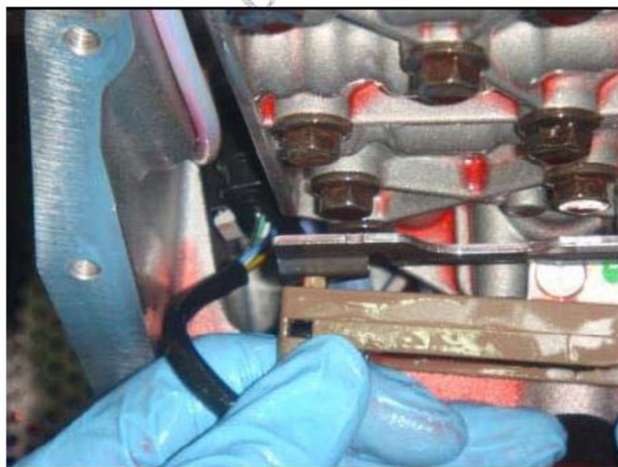
图 10-2: 将传感器往下压并取出
