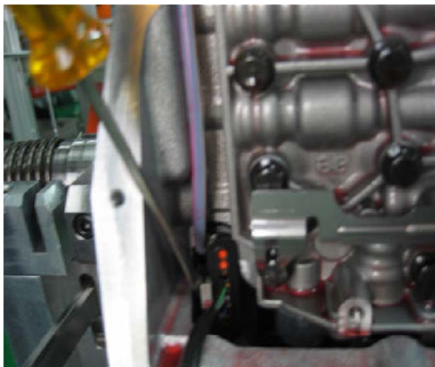
图 10-3: 将驾驶模式传感器拆下
