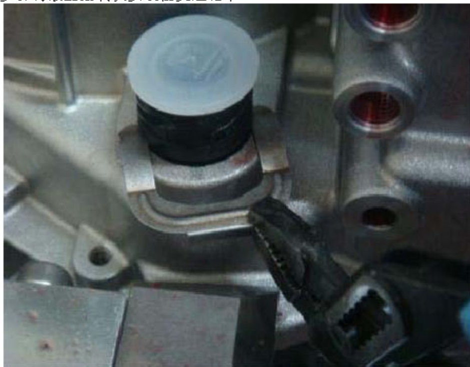
图 13-1: 将卡扣从主接头上取下
