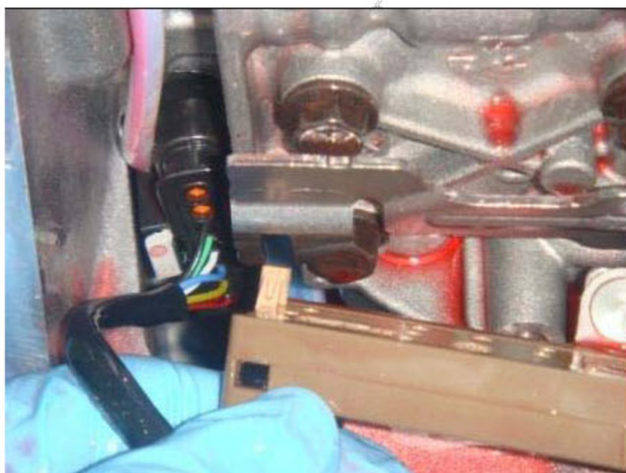
图 10-4: 销子要安装在金属滑片上的正确位置
