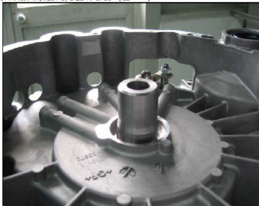
图 2-2: 将特殊工具装在输入轴上(480129)
