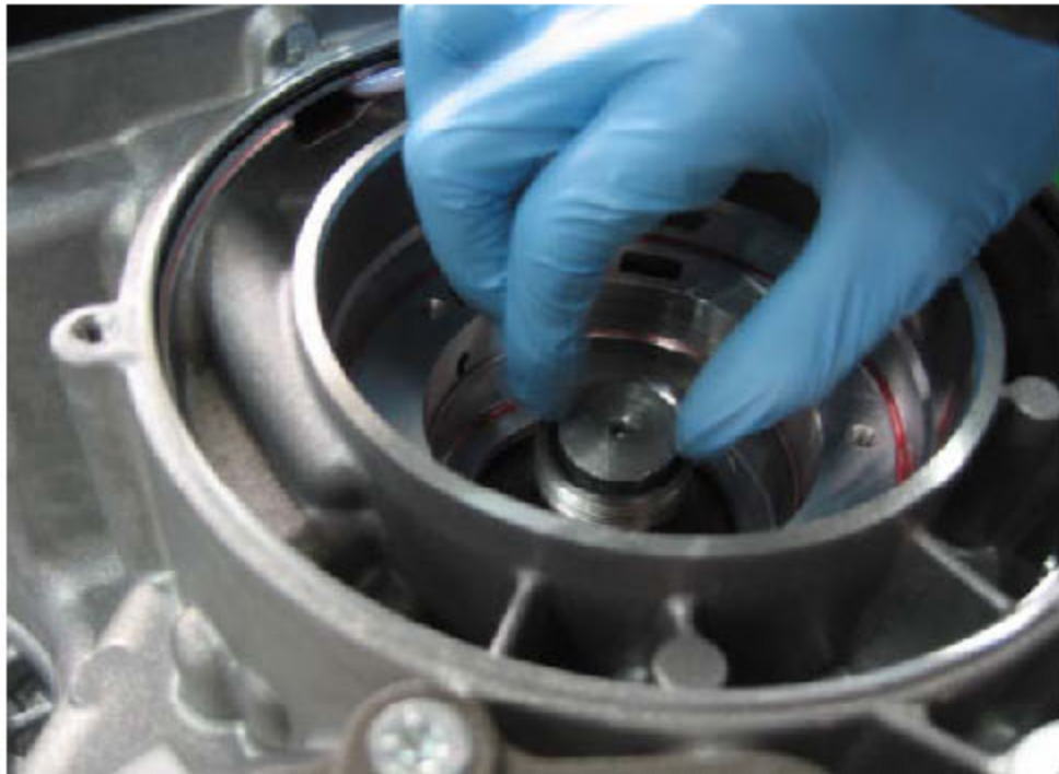
图 6-3: 将专用工具放在轴上 (主动锥轮塞子 T00222)
