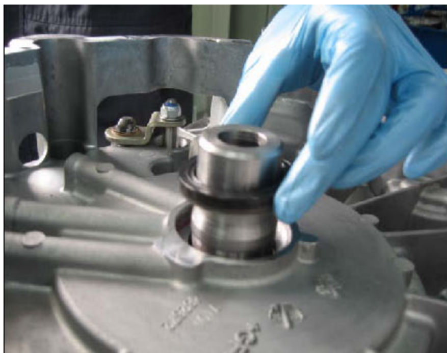
图 2-3: 将油封压下去
