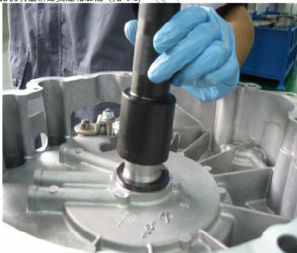
图 2-4: 用专用工具安装油封 (480130)
