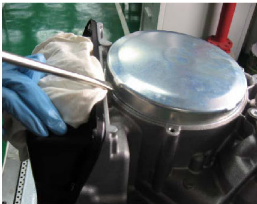
图 4-1: 拆卸主动锥轮轴端盖
