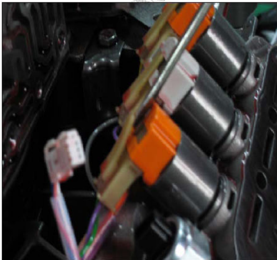
图 11-3: 用小的一字起将四个接头拆下
