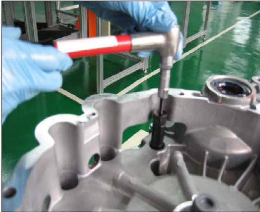
图 3-3: 旋转小螺栓将油封拉出
