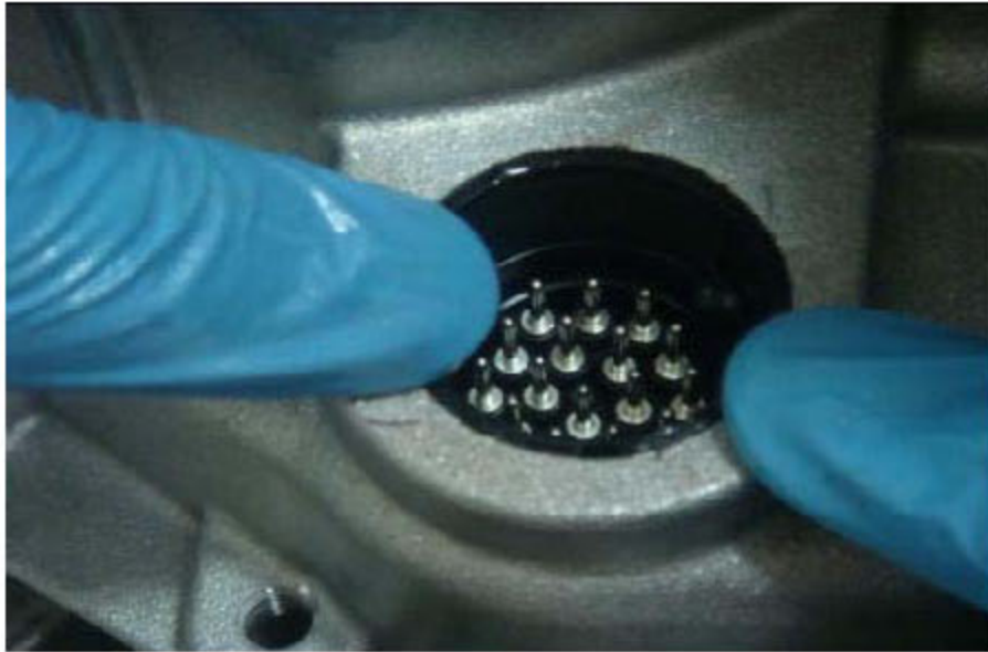
图 13-2: 将主接头压进变速箱内部
