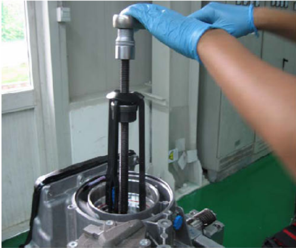
图 6-5: 旋紧中间的螺栓以拉出轴承
