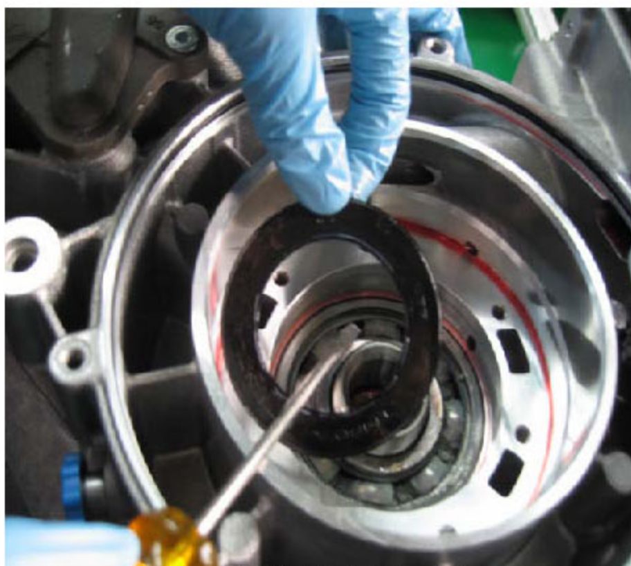
图 6-2: 将主动锥轮轴承上的防尘罩取出
