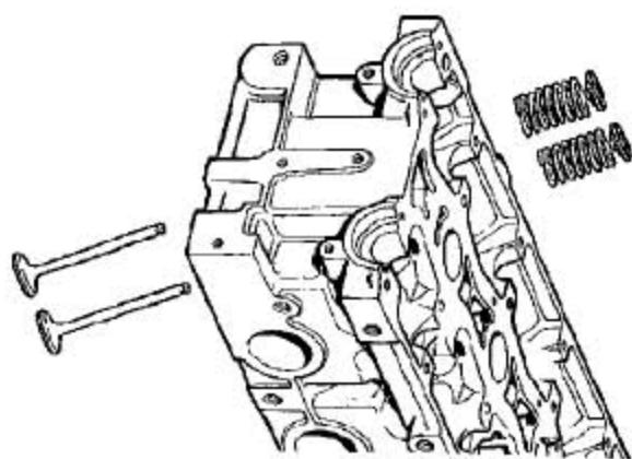
30). 取下剩下的气门弹簧，弹簧盖和气门。按原来的安装顺序，把气门和弹簧放好。
