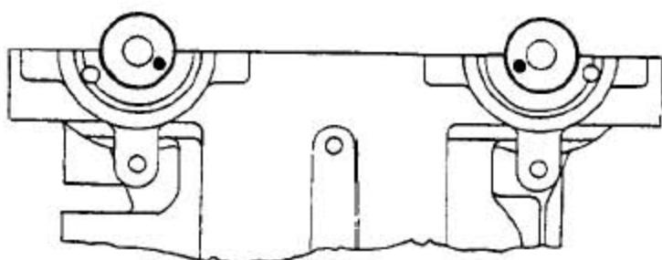
6). 润滑轴承，装上凸轮轴并固定进气驱动销于4点（120度）的位置，把排气凸轮轴驱动销固定于8点（240度）的位置。
