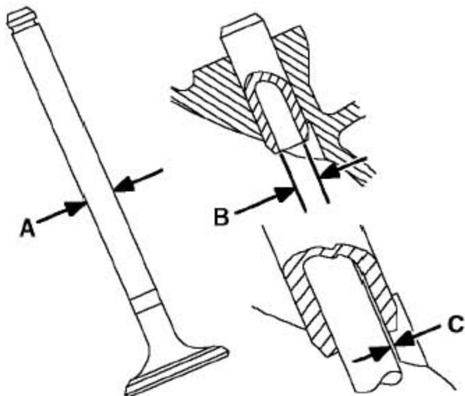
39). 检查现有的气门杆的直径。用新的气门检查气门导管的间隙。(参照“规格”)
