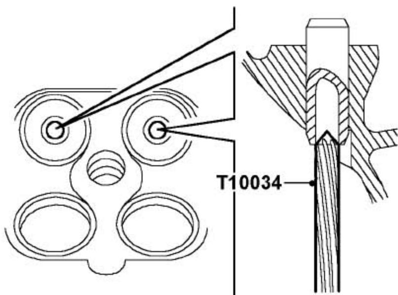
37). 用铰刀T10034 从气门导管上清除掉沉积物。
