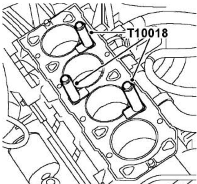
35). 把平缸夹T10018 装到缸体上并用缸盖螺栓固定。确保平缸夹的底部没有突到缸套口的内径。
