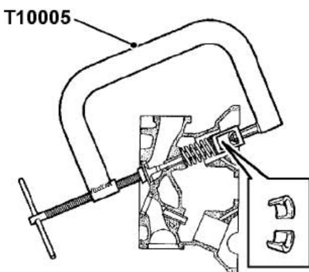
26). 用工具T10005 压缩气门弹簧。
