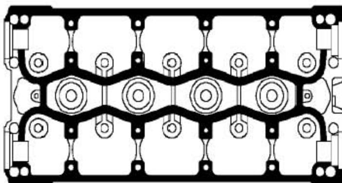
7). 如图所示，在凸轮轴支架路径上涂上连续的密封剂，部件号FLM90017A，然后用滚轮涂抹成均匀的薄膜。
