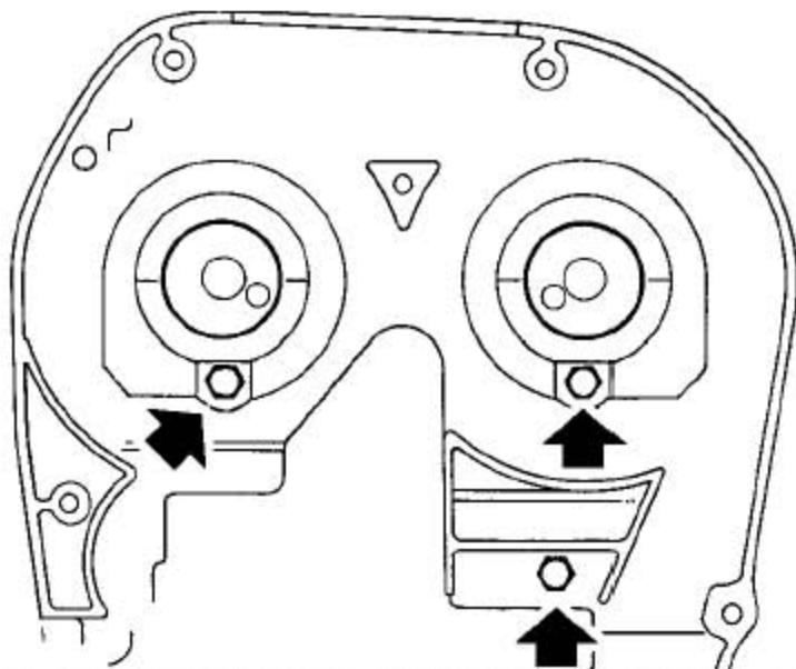
32). 拧下把正时带轮后上盖固定到缸盖上的螺钉，拿开盖子。
