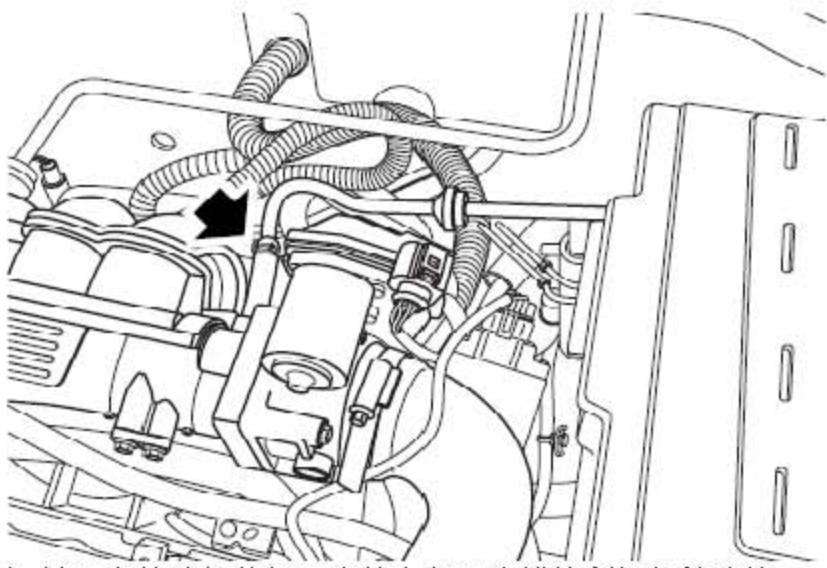
19). 松开夹箍并从节气门壳体上断开炭罐控制阀软管连接。
