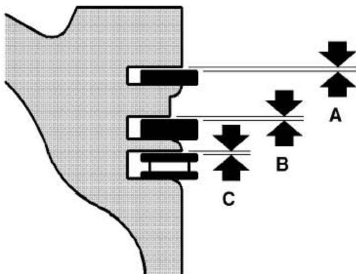
13). 检查新的活塞环至环槽的间隙。（参照“规格”）
