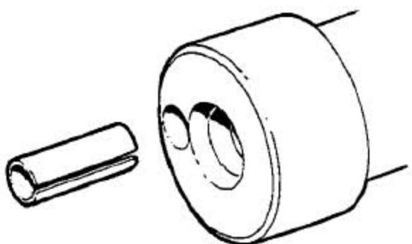
24). 从旧的凸轮轴上拿开驱动销，装上新的销，注意缺口朝凸轮轴的中心。
