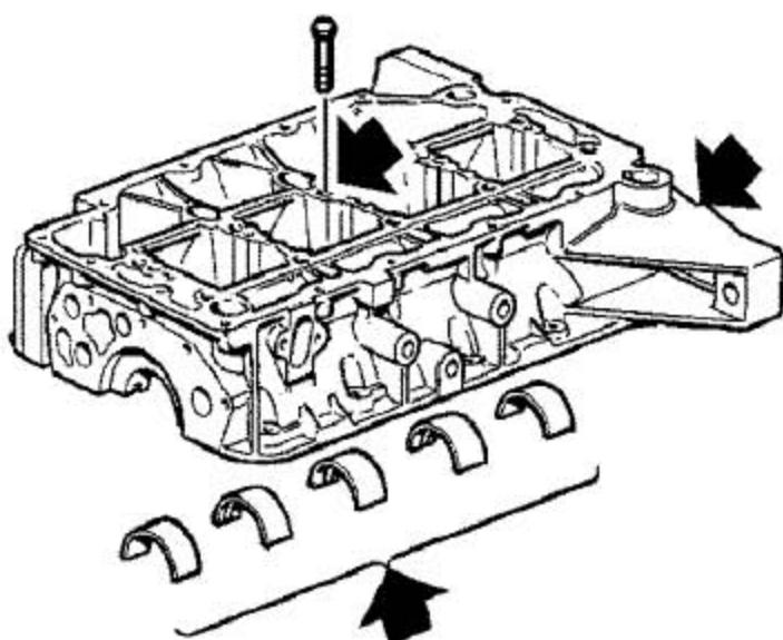
33). 拧下10个把轴承座固定到缸体上的螺栓，拿开轴承座，并从轴承座上取下主轴瓦。
