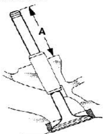
47). 检查气门杆的配合高度。（参照“规格”）
