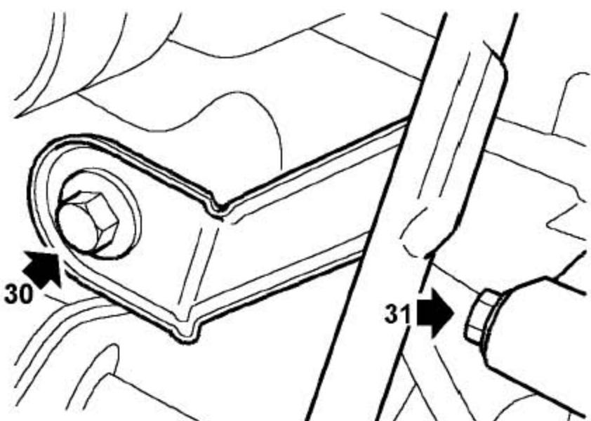
30). 拧下固定油标尺管支架的螺栓。
