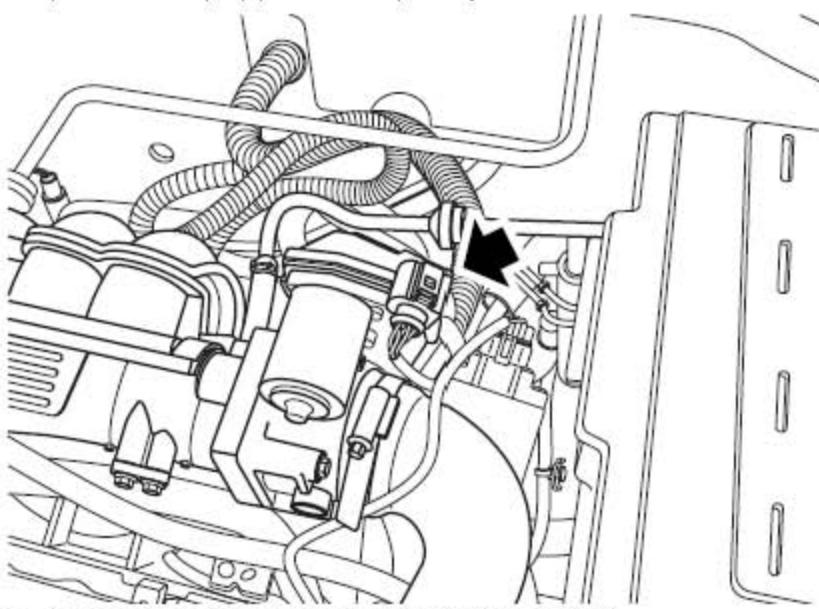
14). 从电子节气门传感器上断开连接器的连接。
