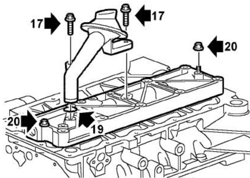
17). 拧下2个把机油集滤器固定到机油轨上的螺栓。
