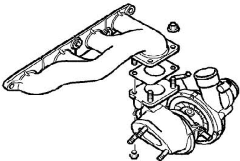
6). 拧下4个把排气岐管固定到涡轮增压器上的螺母。
