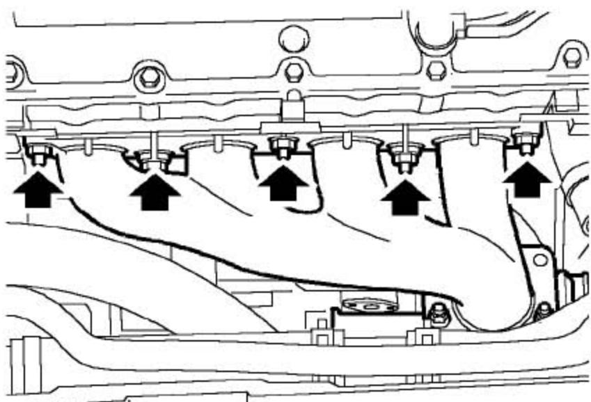
19). 把新的排气歧管衬垫装到缸盖上，装上岐管，装上螺母并按所示的顺序拧紧到45Nm。
