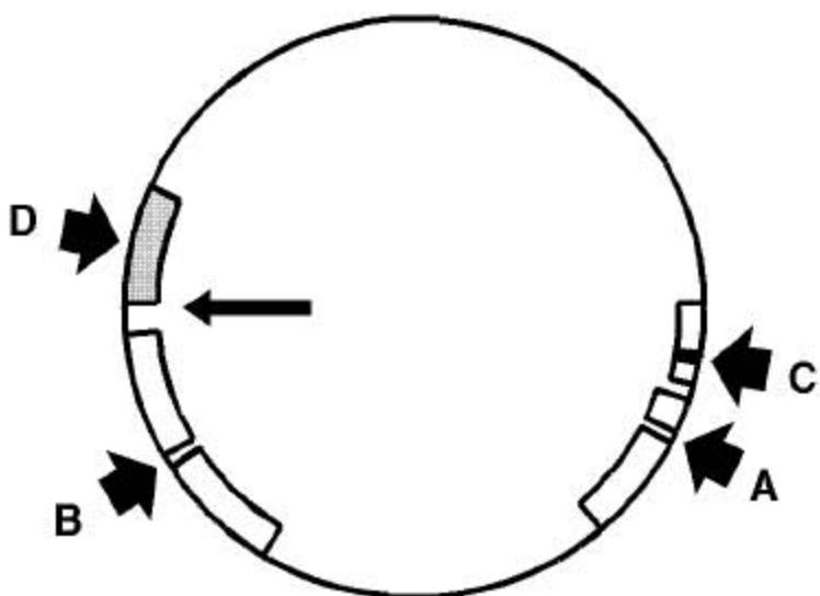
11). 确保活塞环能自由转动，把两个气环的缺口A 和B彼此相对120° 的放置，并远离活塞的止推侧。
