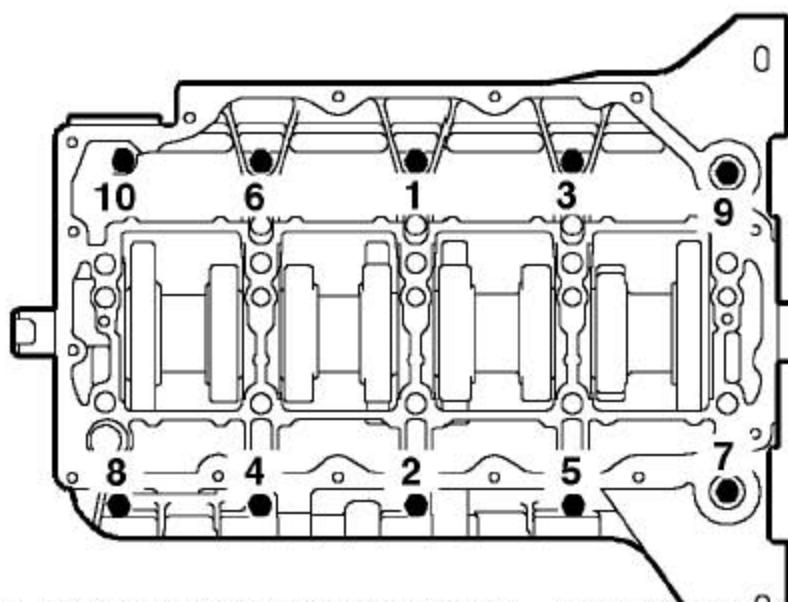
18). 用发动机机油润滑曲轴主轴瓦轴颈。把轴承座装到缸体上，装上螺栓并确保带凸缘头的螺栓安装到位置10上。
