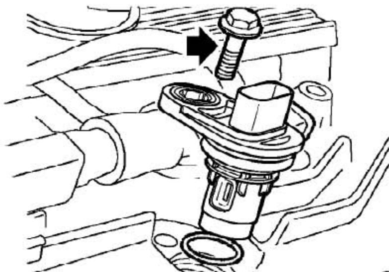
5). 拧下固定CMP 传感器的螺栓并取下传感器。
