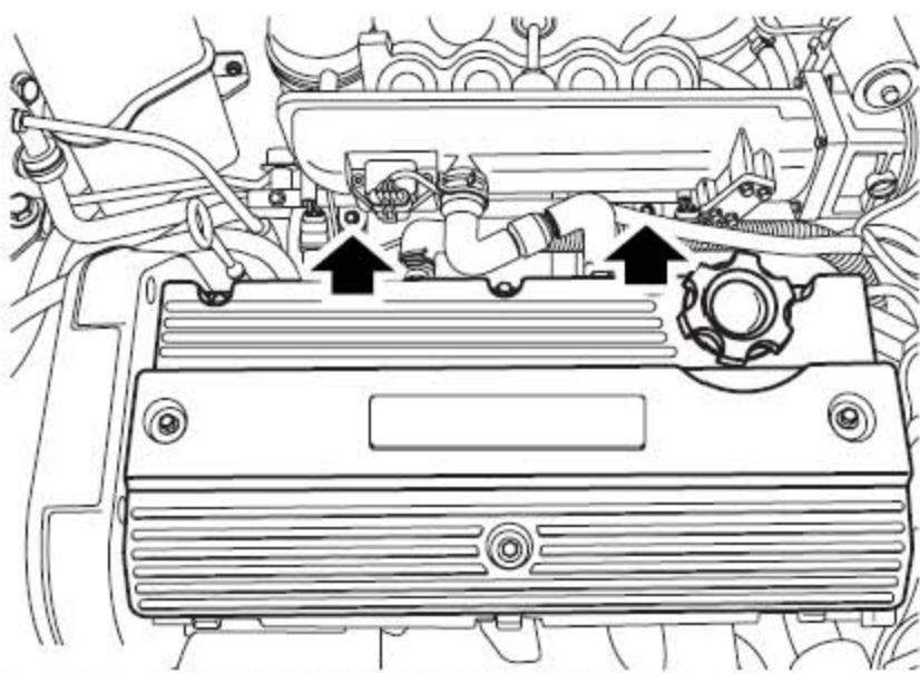
5). 拧下2个把燃油轨固定到进气歧管上的螺栓。
