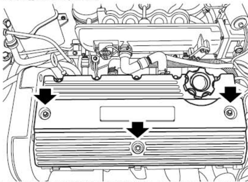
2). 拧下3个把火花塞盖固定到发动机上的螺栓并取下火花塞盖。
