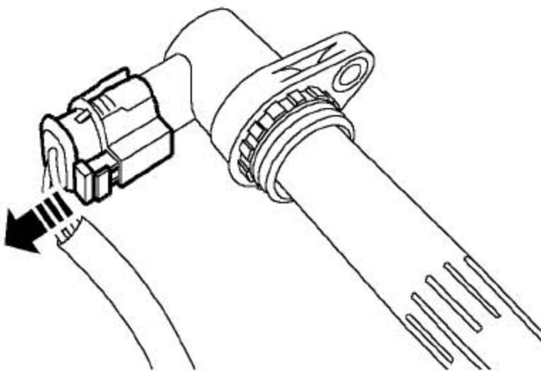
4). 滑开背部黄色的锁止夹，推下标签，从线圈上断开连接器。
