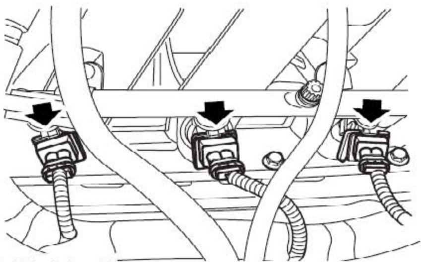
3). 拔出喷油器连接器。
