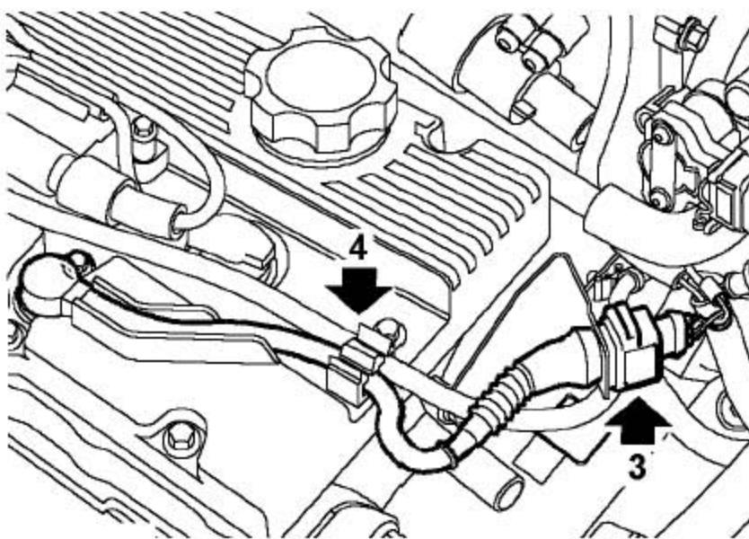
3). 从支架上松开CMP 传感器连接器，并断开连接器的连接。
