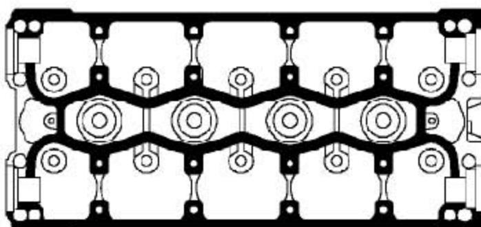
23). 在如图所示的凸轮轴支架路径上涂上的密封剂，部件号为FLM90017A，然后用滚轮把密封剂涂成均匀薄膜。
