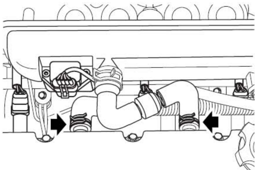
2). 松开2个夹箍，从凸轮轴盖上断开2个通气软管。
