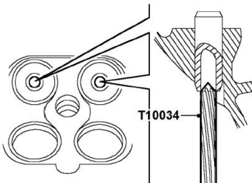
1). 用铰刀T10034 从气门导管中清除掉沉积物。
