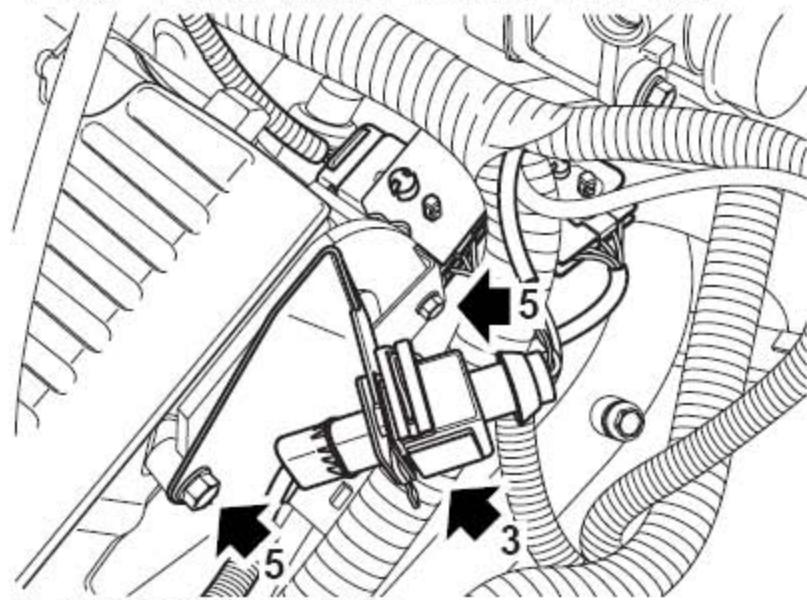
3). 断开凸轮轴传感器连接器。
