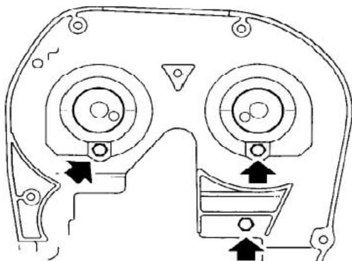
15). 拧下把正时带后上盖固定到发动机上的螺栓。
