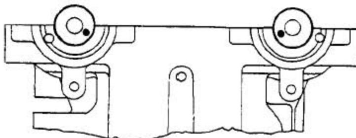
5). 装上凸轮轴并固定进气驱动销于4 点（120 度）的位置，把排气凸轮轴驱动销固定于8 点（240 度）的位置。
