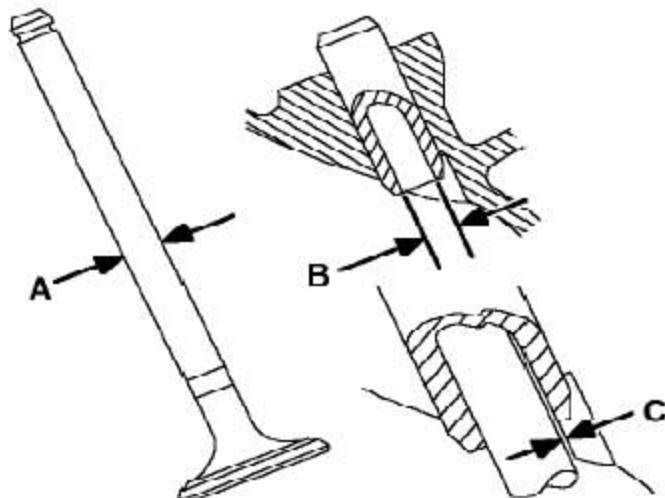
3). 检查现有的气门杆的直径。用新的气门检查气门导管的间隙。(参照“规格”)
