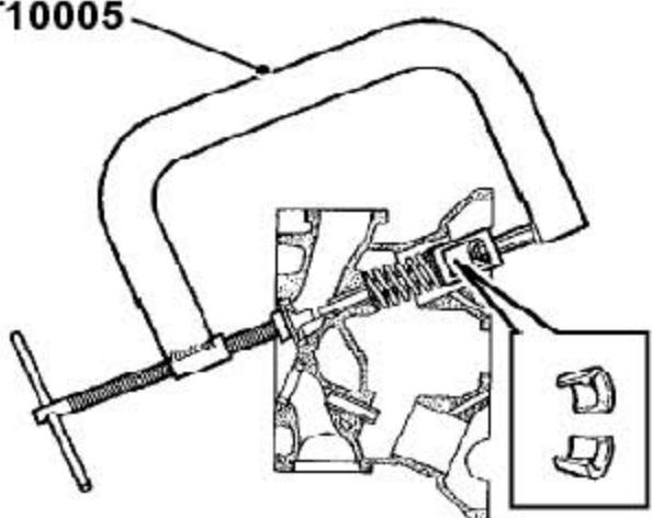
13). 用工具T10005 压缩气门弹簧。
