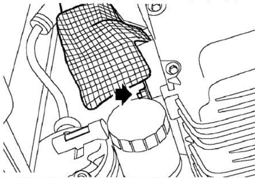
6). 拧下把发电机隔热钣固定到发电机下支架上的螺栓并取下隔热钣。
