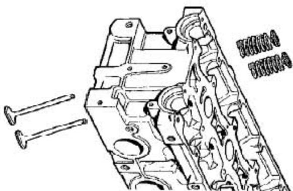
16). 取下气门弹簧，气门弹簧盖和气门。
