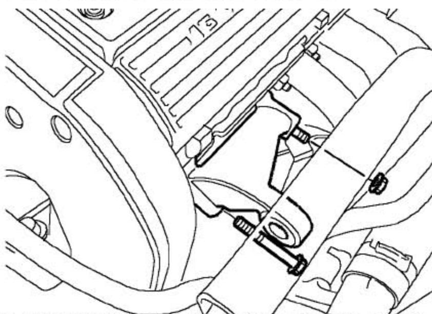
4). 拧下固定隔热板到发电机上支架的螺母和固定上支架到缸盖的螺母和螺栓。
