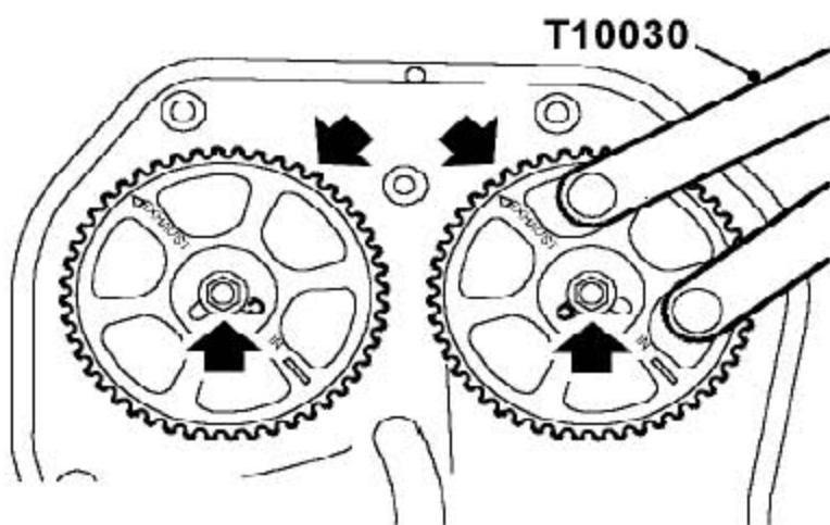
15). 给凸轮轴装上凸轮轴带轮，确保正时标记对准，并将驱动销置于正确的带轮切槽。
