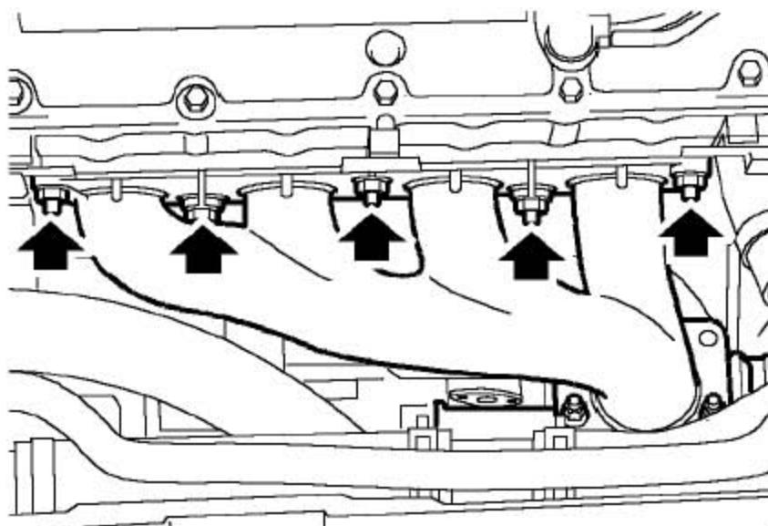
3). 按所示的顺序，拧下5个把排气歧管固定到缸盖上的螺母。
