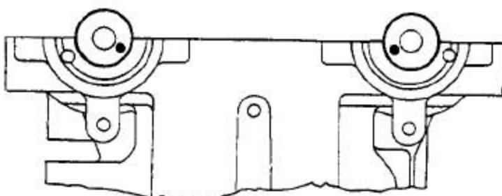
22). 装上凸轮轴并固定进气驱动销于4点(120度)的位置，排气凸轮轴驱动销固定于8点(240度)的位置。
