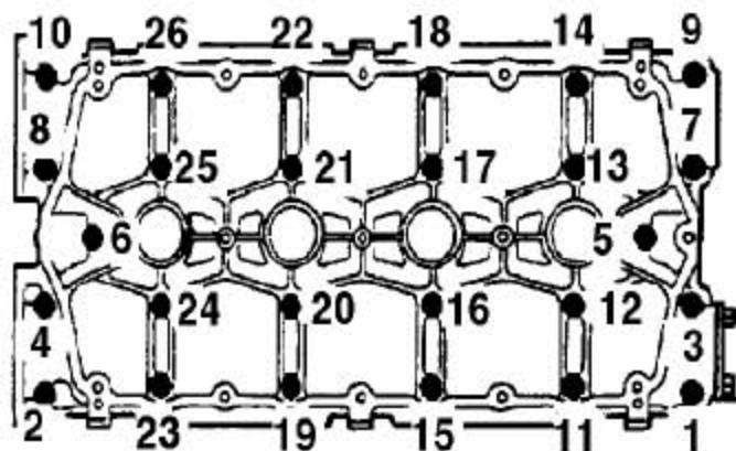
24). 装上凸轮轴支架，并把凸轮轴支架固定到缸盖上的螺栓逐渐按所示的顺序，依次拧紧到10Nm。
