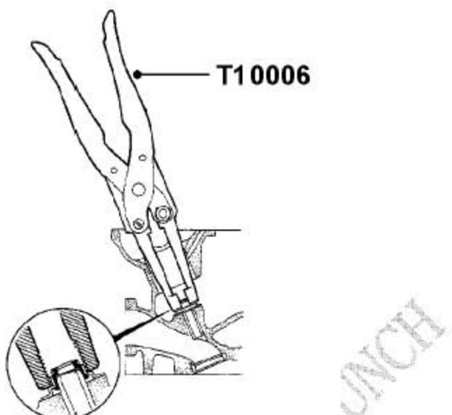
15). 用T10006 把气门杆油封装到气门导管上。
