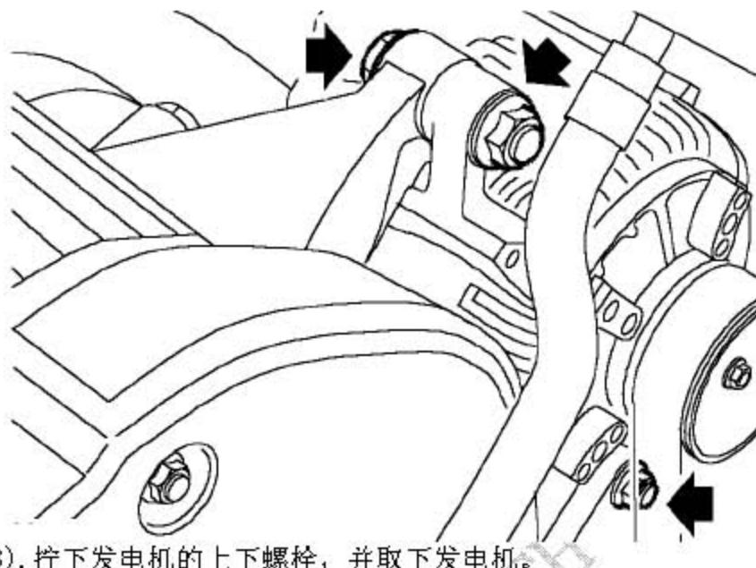
3). 拧下发电机的上下螺栓，并取下发电机。
