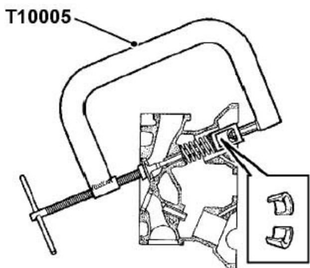
16). 装上气门。装上弹簧和弹簧盖，把T10005 固定到气门和压缩弹簧上。
