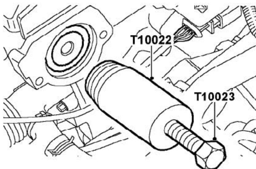
4). 用T10022 和中心螺栓T10023 取下凸轮轴油封。
