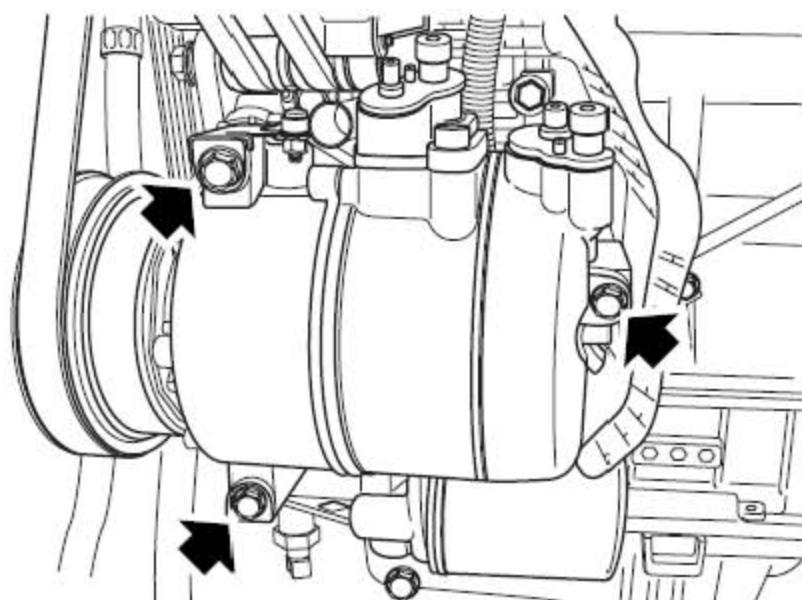
5). 拧下把空调压缩机固定到发电机下支架的3个螺栓，并拆下压缩机。
