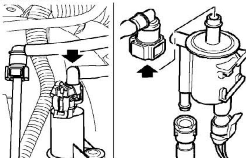
2). 从炭罐控制阀上断开炭罐通气软管的连接。
