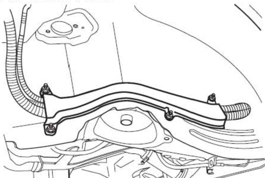
3). 拆下燃油系燃油管护板。
