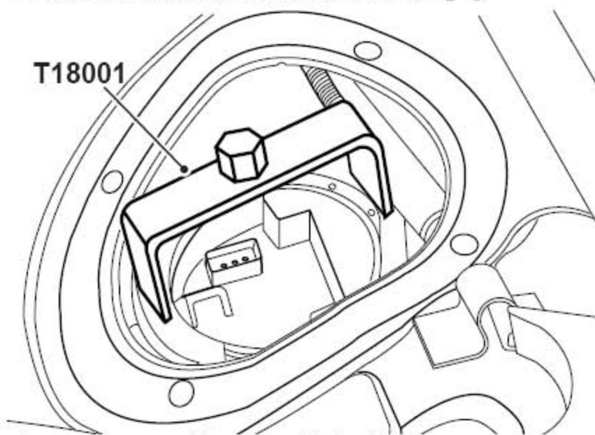
7). 用工具T18001松开并拿开燃油泵锁闭环。
