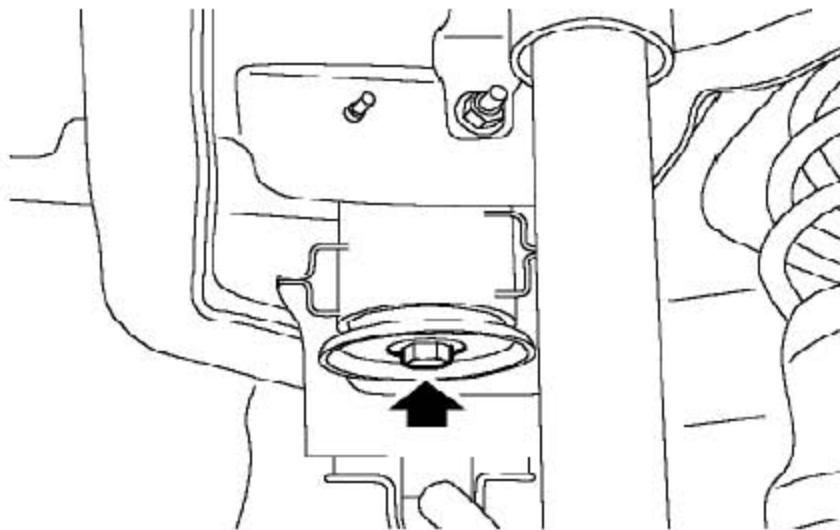
8). 支撑起后副车架的重量，松开2个固定副车架后部的后螺栓。
