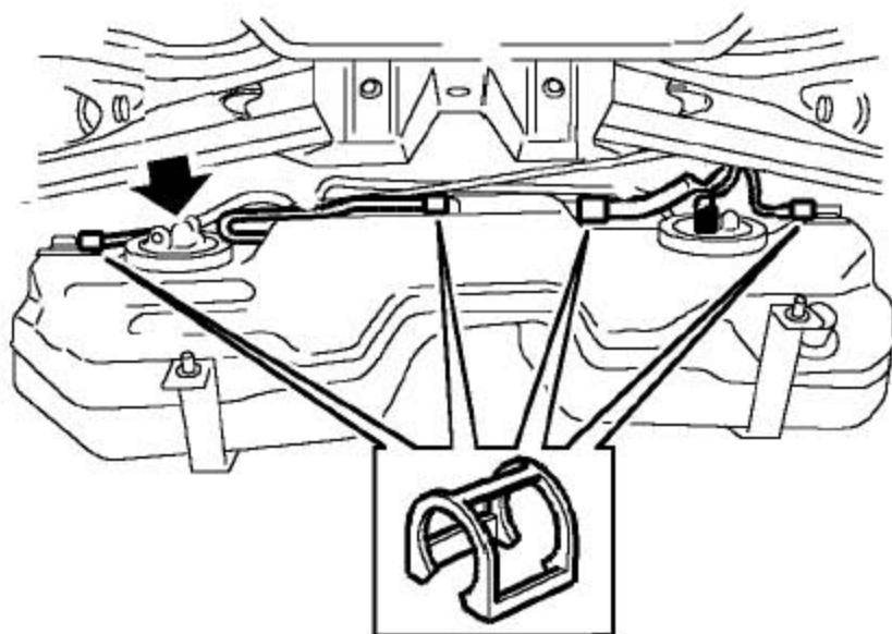
5). 拆开燃油管与燃油箱的连接。
