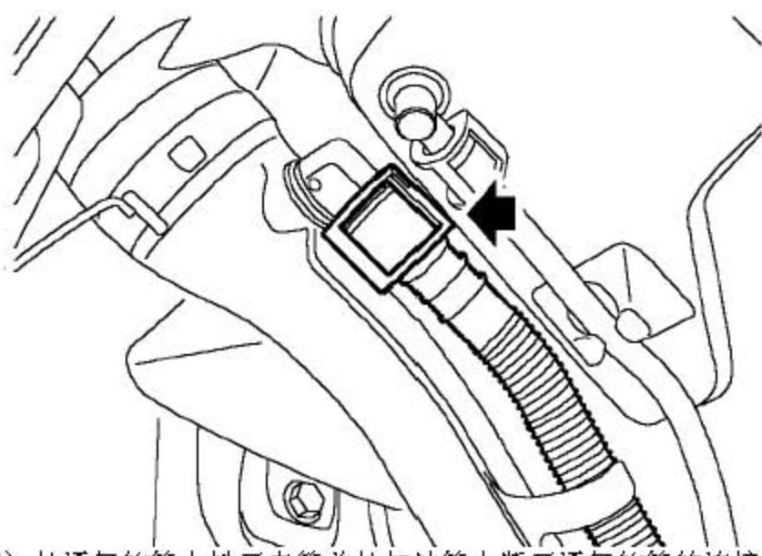
6). 从通气软管上松开夹箍并从加油管上断开通气软管的连接。
