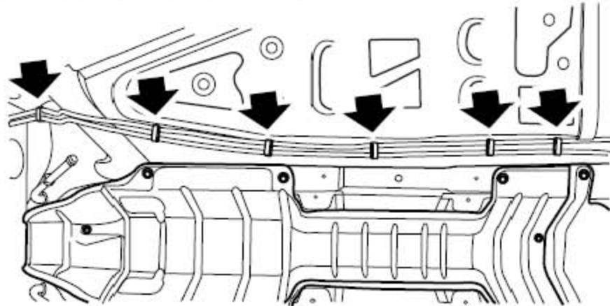
6). 拆下将地板下燃油管总成固定到车底的8个固定卡。
