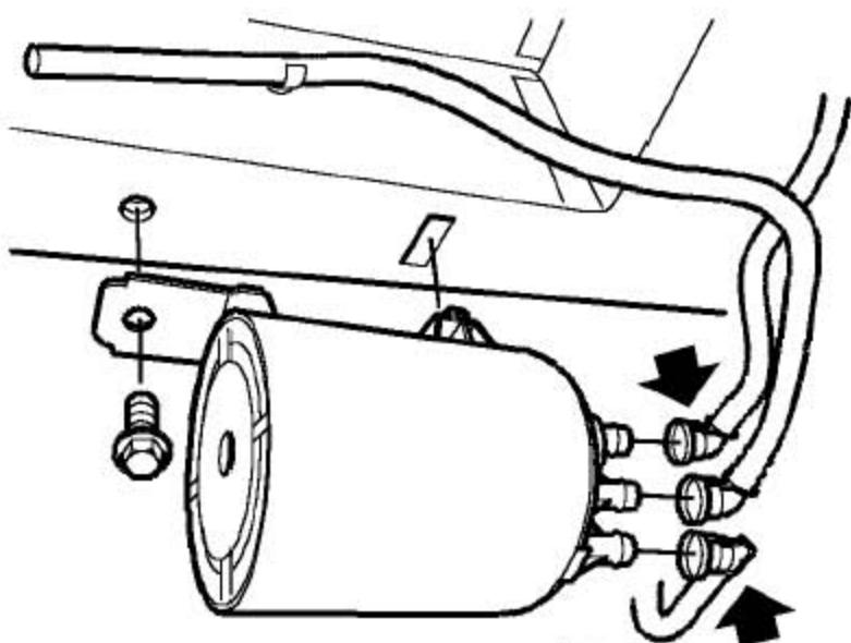
3). 拿开把炭罐固定到底盘上的螺栓并拿开炭罐。
