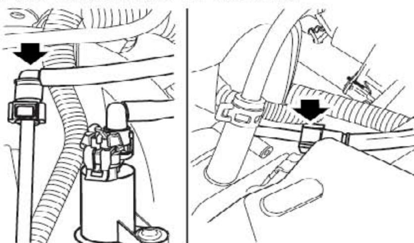
3). 针对2.5L：断开燃油管与燃油管系进油管的连接。针对1.8T：从燃油轨上松开燃油进油软管。
