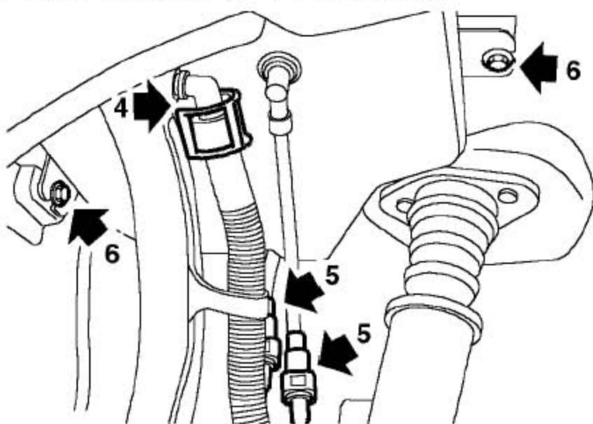
4). 拿开卡箍，从加油管上断开粗燃油箱通气管的连接。
