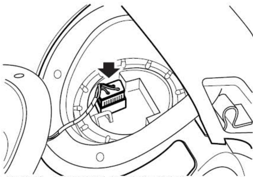
5). 松开插销，并从燃油泵上断开连接器的连接。
