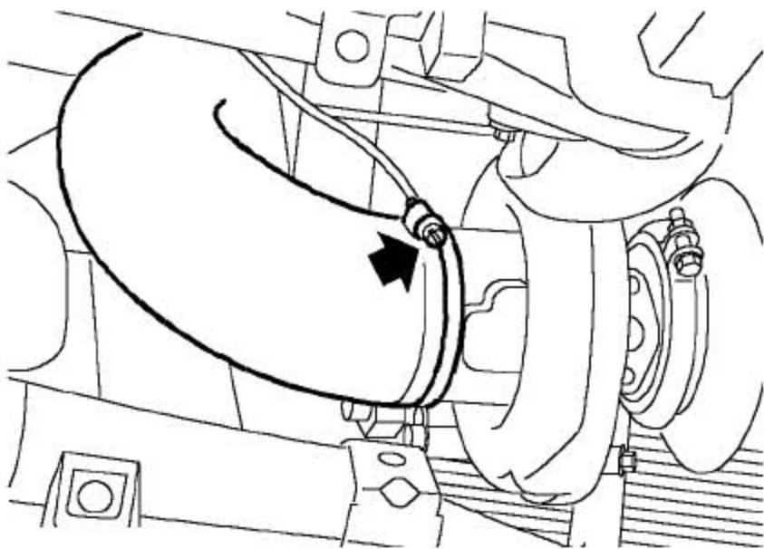
44). 松开把空气进气软管固定到涡轮增压器上的夹箍，并拿开软管。
