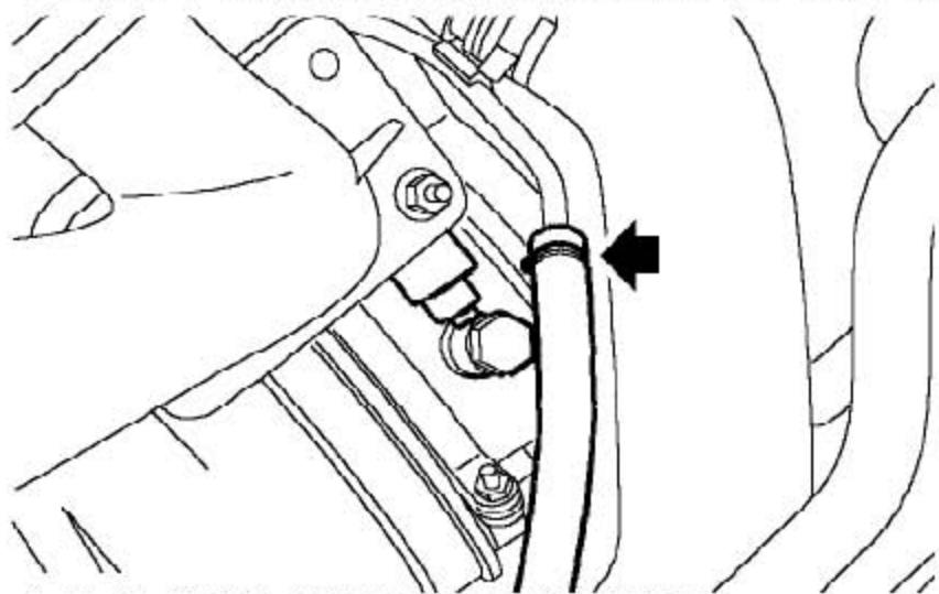
46). 松开夹箍并断开增压器冷却液回液管的连接。
