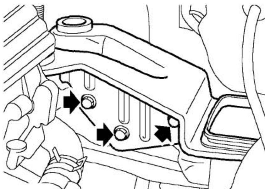
8). 拧下3个固定空气滤清器安装支架到车身上的螺栓并取下支架。
