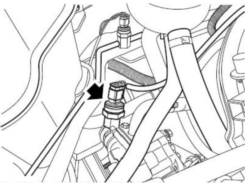
32). 断开PAS 压力传感器连接器的连接。
