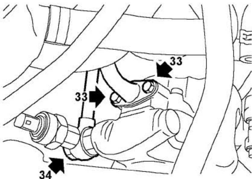
33). 拧下2 个把进液软管固定到PAS 泵上的螺栓, 松开软管, 取下O 型圈并废弃。
