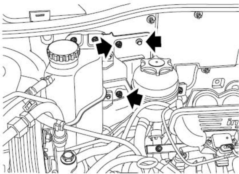
37). 拧下2个把PAS储液罐固定到防水壁上的螺母和1个螺栓，取下储液罐并放在旁边。
