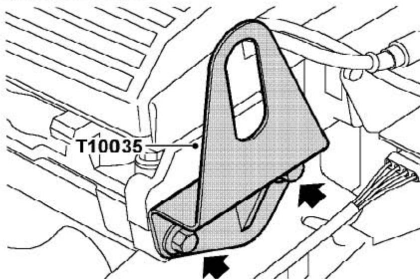
70). 拧下2个螺栓并拿开凸轮轴盖板。
