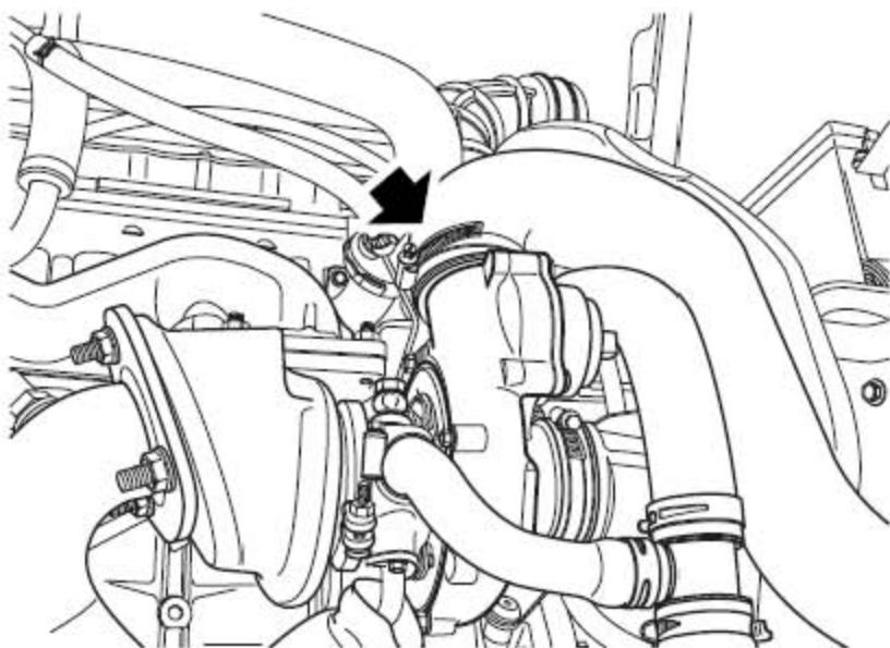
46). 松开把空气出气软管固定到涡轮增压器上的夹箍，并拿开软管。
