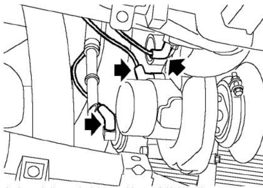
45). 从涡轮增压器和废气口处松开压力控制软管。
