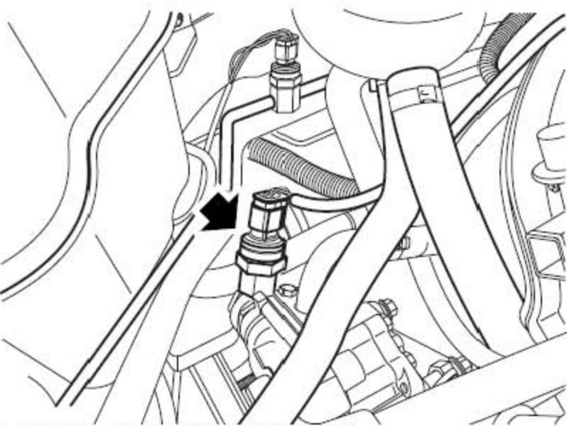
30). 断开PAS 压力传感器连接器的连接。
