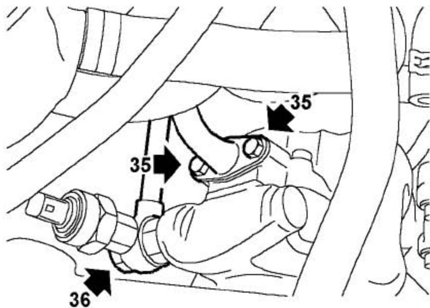
35). 拧下2 个把进液软管固定到PAS 泵上的螺栓, 松开软管, 取下O 型圈并废弃。
