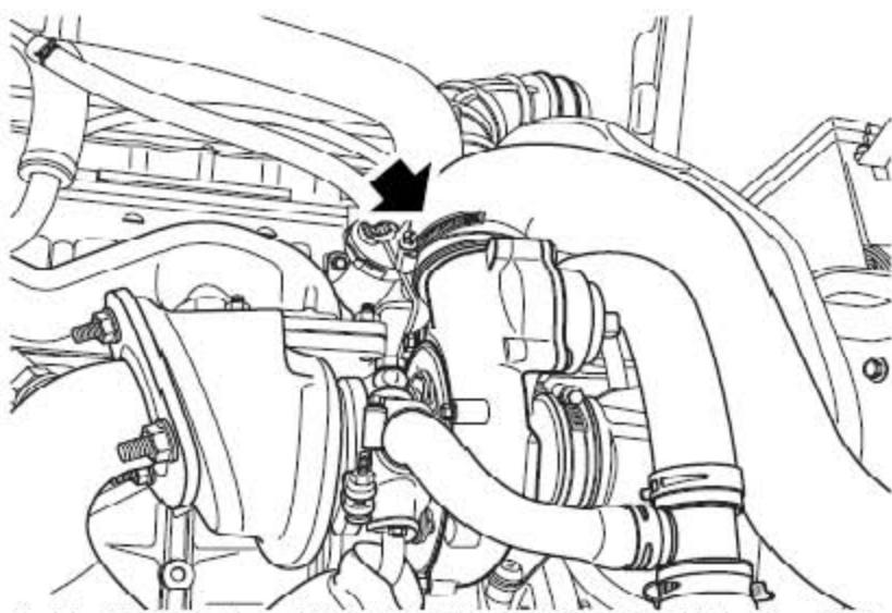
44). 松开把空气出气软管固定到涡轮增压器上的夹箍，并拿开软管。
