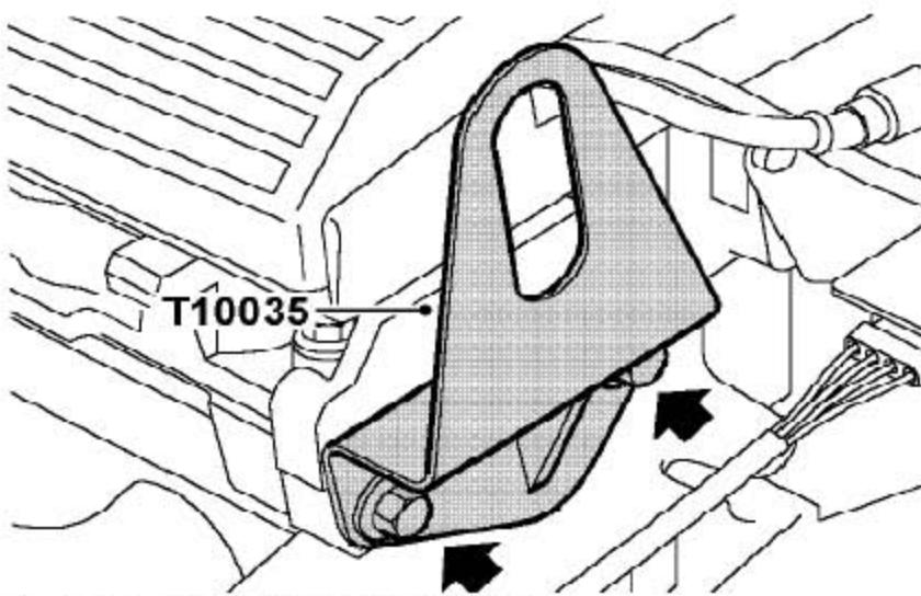
73). 拧下2个螺栓并拿开凸轮轴盖板。
