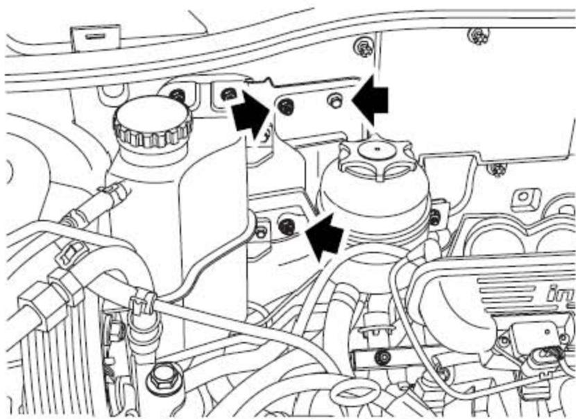
35). 拧下2个把PAS 储液罐固定到防水壁上的螺母和1个螺栓，取下储液罐并放在旁边。
