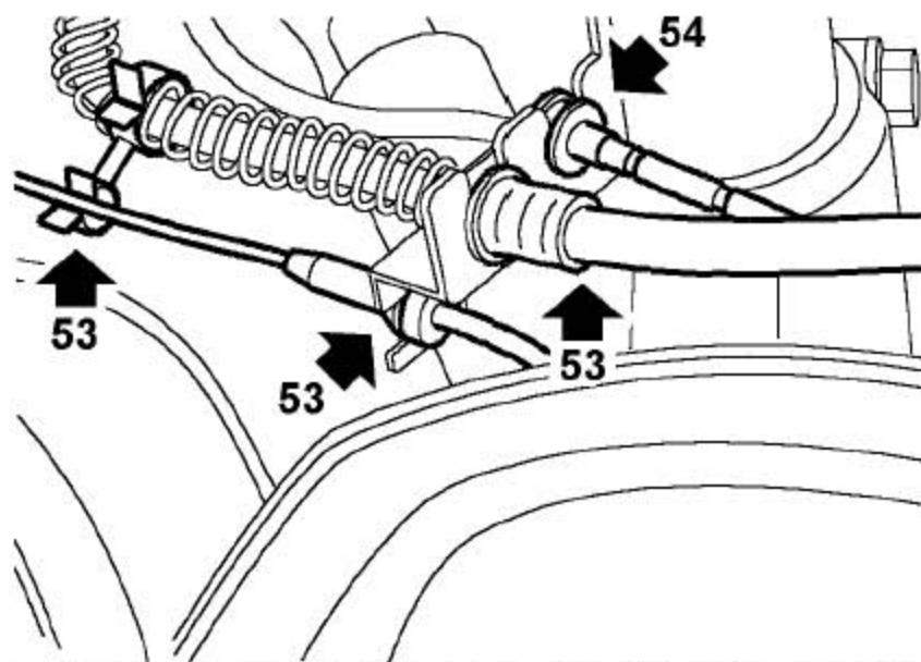
53). 取下固定右制动软管的夹子，从支撑支架上松开制动软管盒ABS 传感器线束上的夹子。松开制动蹄磨损传感器线束，从支撑支架上松开ABS 传感器线束。
