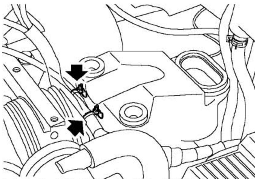
7). 把发动机线束和接地端固定到空气滤清器支撑支架上的夹子松开。
