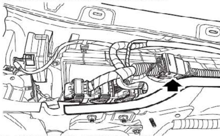
19). 从主线束连接器上断开发动机线束的连接。
