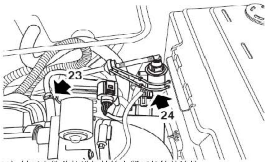
22). 松开夹箍并从进气歧管上断开软管的连接。
