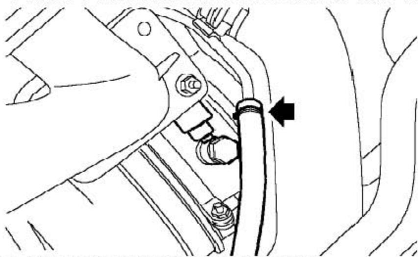
48). 松开夹箍并断开增压器冷却液回液管的连接。
