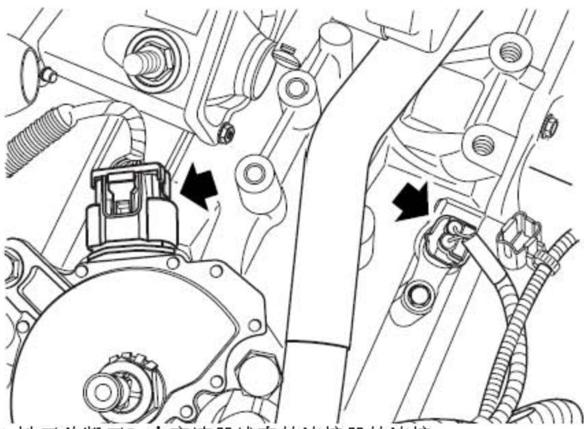
9). 松开并断开2个变速器线束的连接器的连接。
