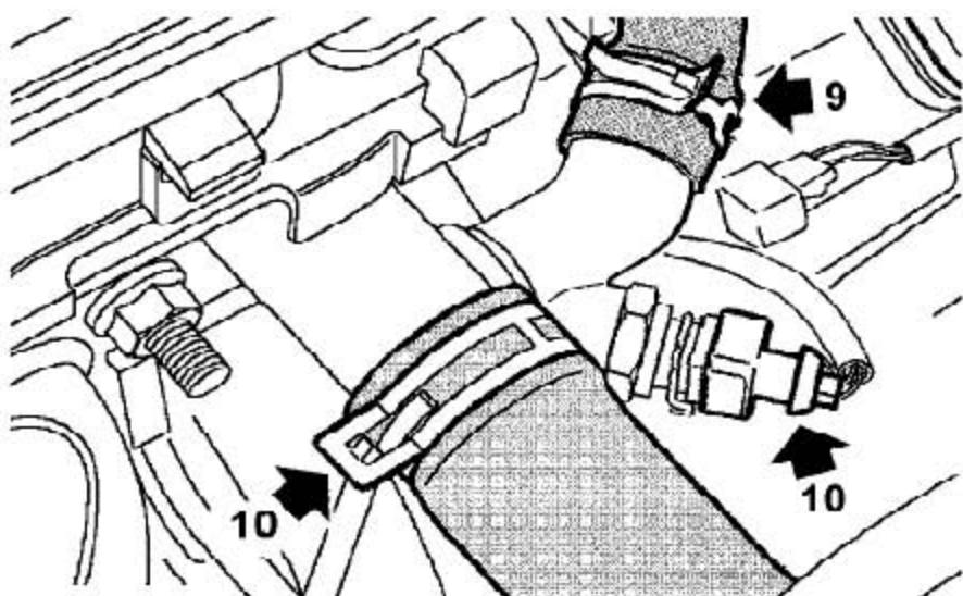
9). 松开把软管固定到冷却管出口弯管接头的夹箍，并断开软管的连接。
