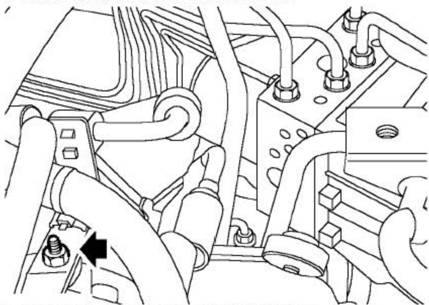
25). 拿开把PAS 软管支撑支架固定到冷却导管上的螺栓。
