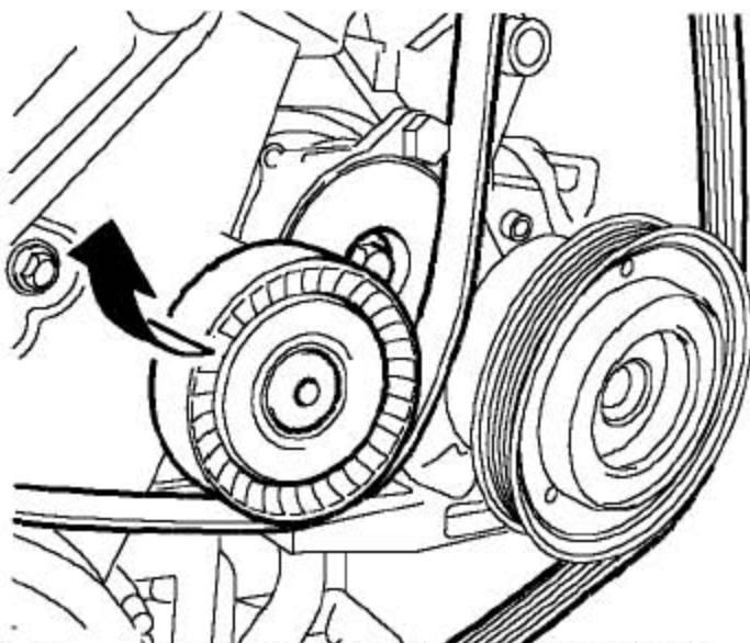
40). 用一13mm的扳手，转动张紧器以放松张紧力，把辅助传动带从空调压缩机皮带轮上拿开。
