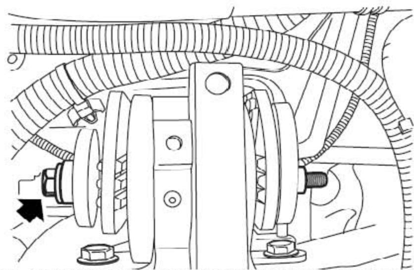
79). 拧下把发动机左安装支架到变速器左液压悬置的贯穿螺栓。
