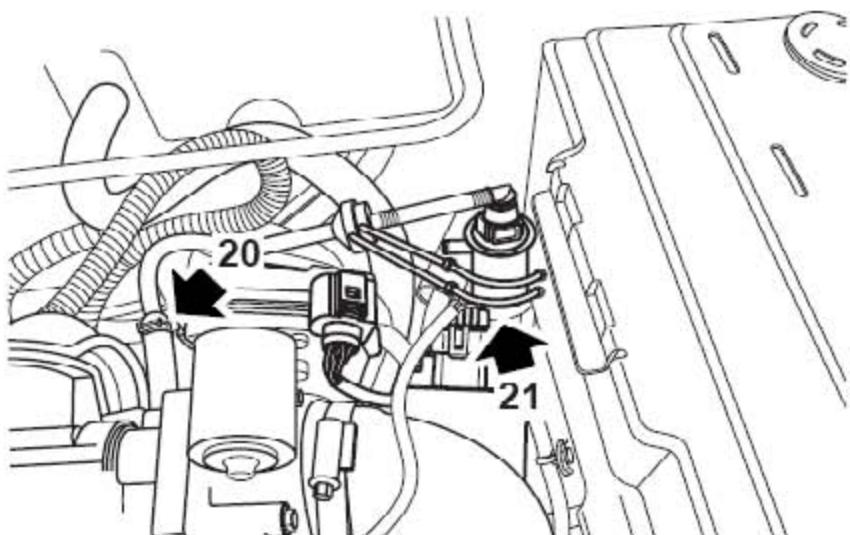
20). 松开夹箍并从进气歧管上断开软管的连接。
