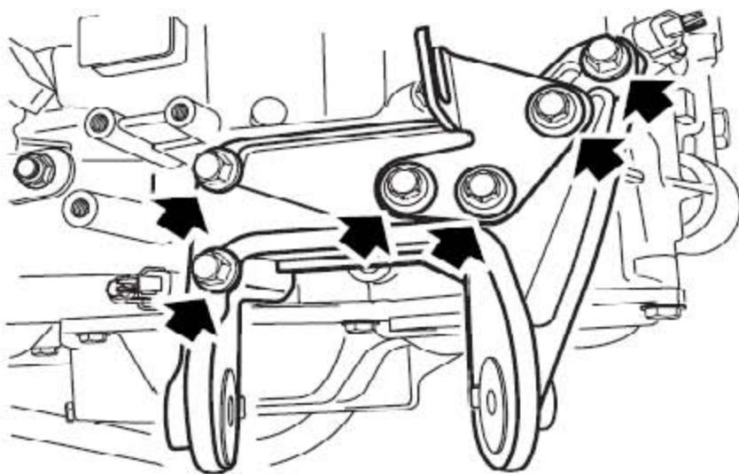
80). 拧下6个固定左安装支架到变速器上的螺栓并拿开支架。
