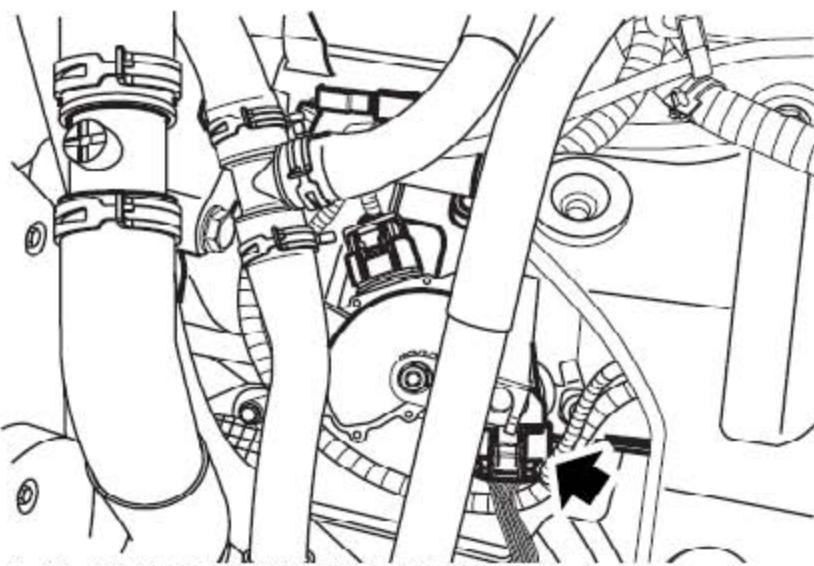
10). 断开变速器上起动电机电磁阀的连接。
