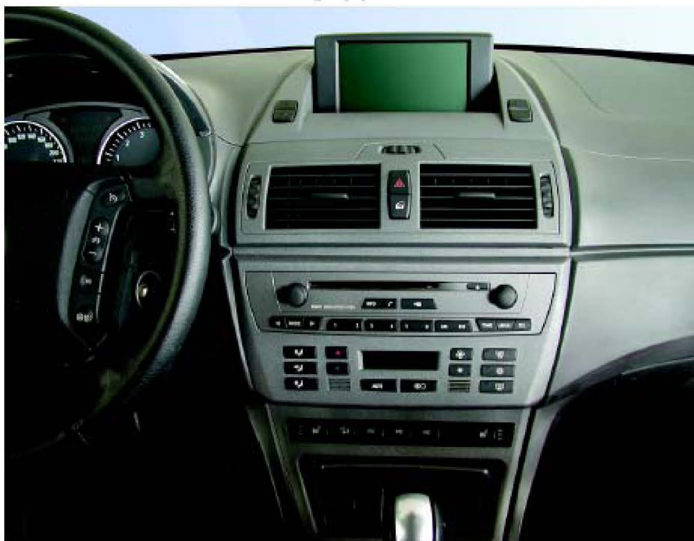
BMW CID 收音机的安装位置 (SA 609)
