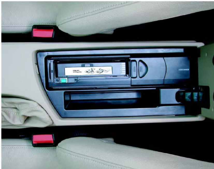
位于前部座椅之间的 CD 光盘转换匣的安装位置。
