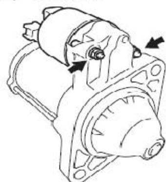
D). 将引线连接到电磁起动机开关上，并用螺母将其拧紧。
