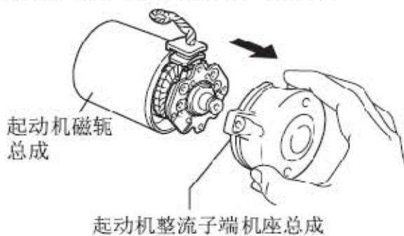
3). 拆卸起动机电枢总成
