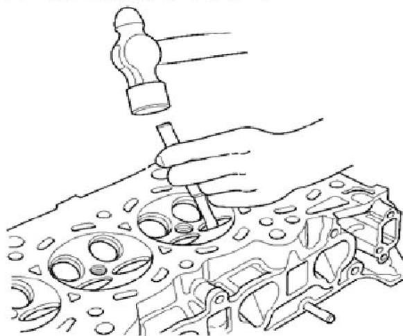
7) .如果导管无法冲出，则使用8mm (0.3 in.)钻头将其钻出，然后再试一次。
