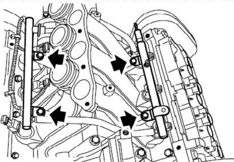
15). 拧下4个把燃油导轨总成固定到进气岐管上的螺栓。
