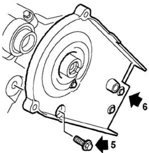
5). 拧下4个固定凸轮轴正时皮带盖背板的螺栓。
