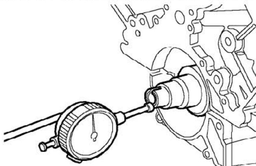
12). 用DTI 检查曲轴的轴向间隙。从DTI 一侧推开曲轴，使DTI 调零，朝表盘方向推曲轴。
