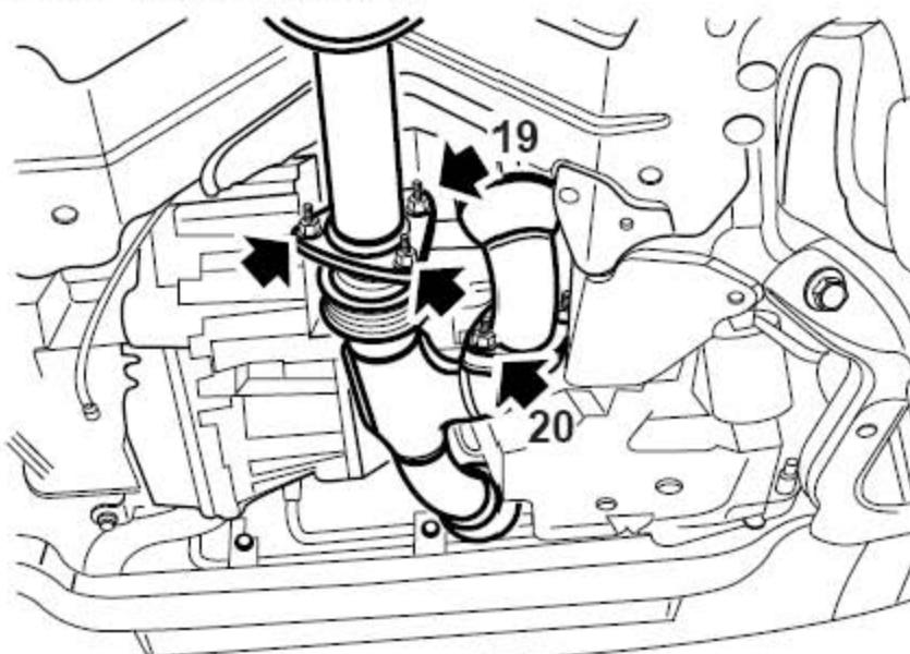
19). 拧下固定排气管到排气歧管法兰上的3个螺母。
