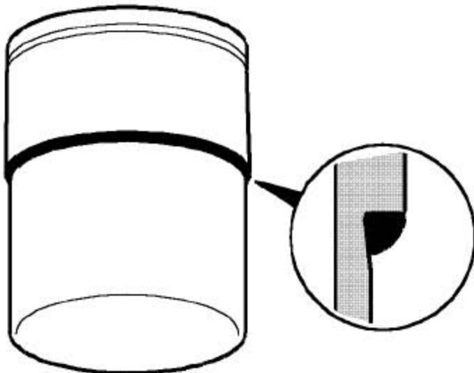
10). 沿缸套的肩部，涂上 $2.0\text{ mm}$  厚的连续的密封剂，密封剂部件号为FLM 90002A。
