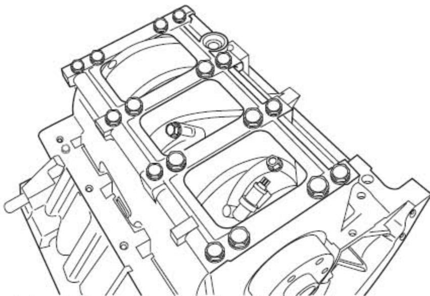
13). 拆下把轴承座固定到缸体的16 个螺栓并废弃。
