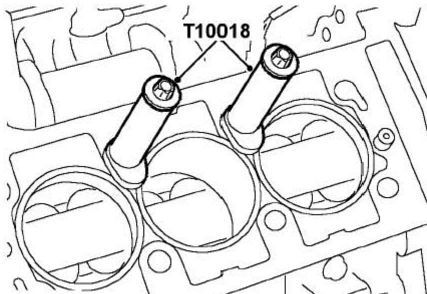
12). 为了防止缸套错位，装上平缸夹T10018，并用缸盖螺栓固定好。
