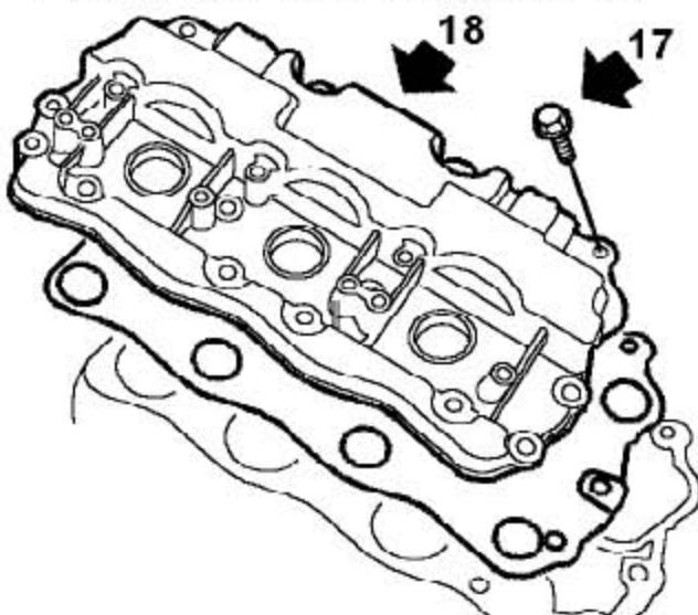
17). 逐渐松开固定右凸轮轴盖的14个螺栓并拿开。
