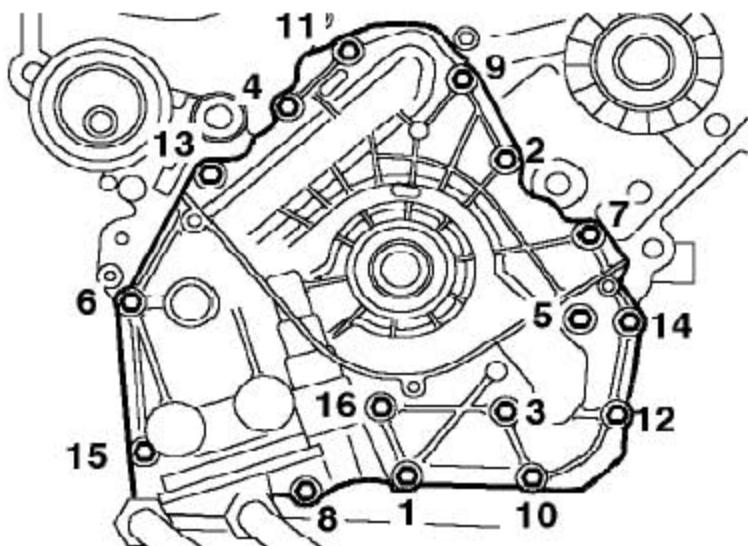
28). 装上新的固定机油泵到缸体上的Patchlok 螺栓，并按所示的顺序，拧紧到25Nm。
