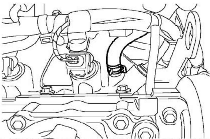
14). 松开夹子，从进气歧管上断开冷却放液软管的连接，并把软管放到旁边。
