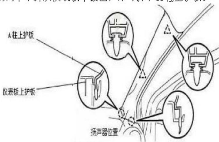
提示: 使用前, 先用软胶条包裹平口起子, 以免划伤护板。(下同)
