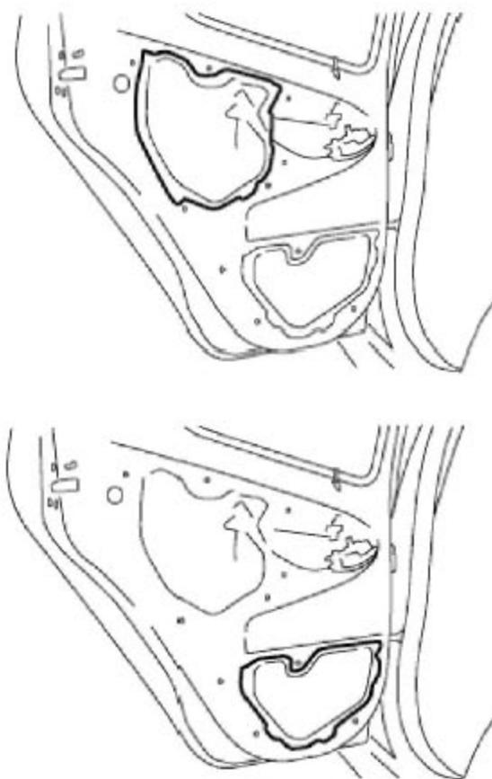
5).拆除左后门内扣手总成
