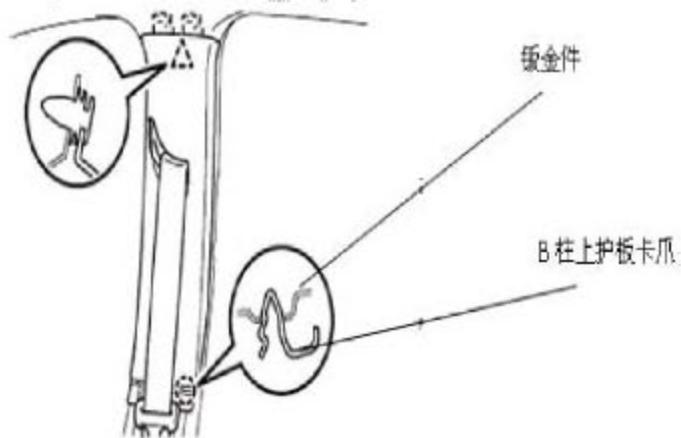
C).在平口起子的辅助下拔出搭在 B 柱下护板上的 C 柱下护板一端，然后用平口起子脱开 B 柱下护板的两个卡扣，即可拿下整个 B 柱护板。
