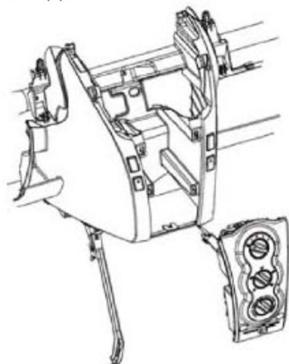
2). 松开仪表板下护板与管梁及车身的安装螺栓, 拨掉仪表板下护板与管梁两侧的固定卡扣
