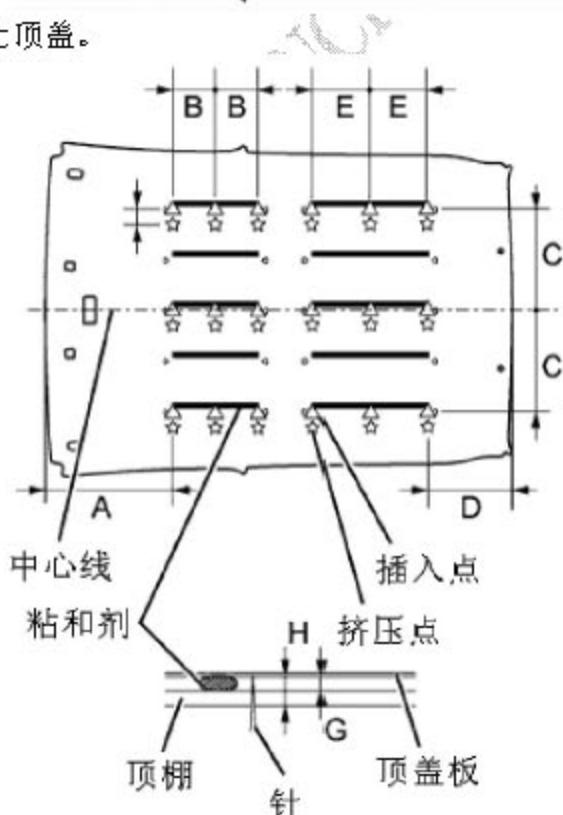
D). 将顶盖内饰压上顶盖, 直到如图所示的 18 个点内饰和钣金之间的间距都小于 4mm 为止。
