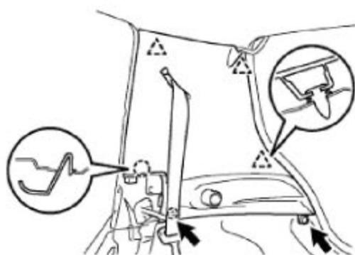
B).用平口起子脱开如下图三角形所示处和箭头所示处卡扣,在平口起子的辅助下用力把C柱下护板从B柱下护板上拔出,这样便可取出整个C柱护板。在C柱上、下护板连接处,稍微用力,便可分开C柱上、下护板。
