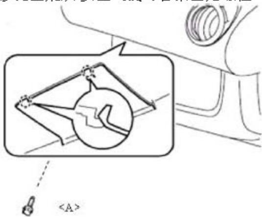
B). 按图示拔出安全气囊连接线束
