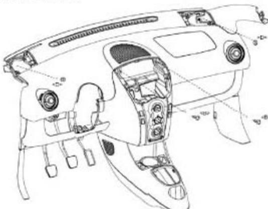
6). 轻撬上下护板卡扣安装点，松开卡扣
