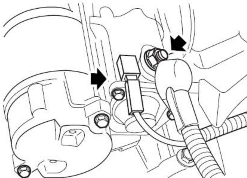
11). 拿开螺母并从起动机电机上断开蓄电池导线的连接。
