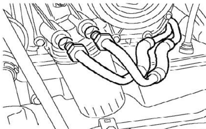
35). 从机油滤清器上松开并拿开发动机机油冷却器管接头，拿开并废弃掉2个O形圈。从发动机上拿开机油冷却器。
