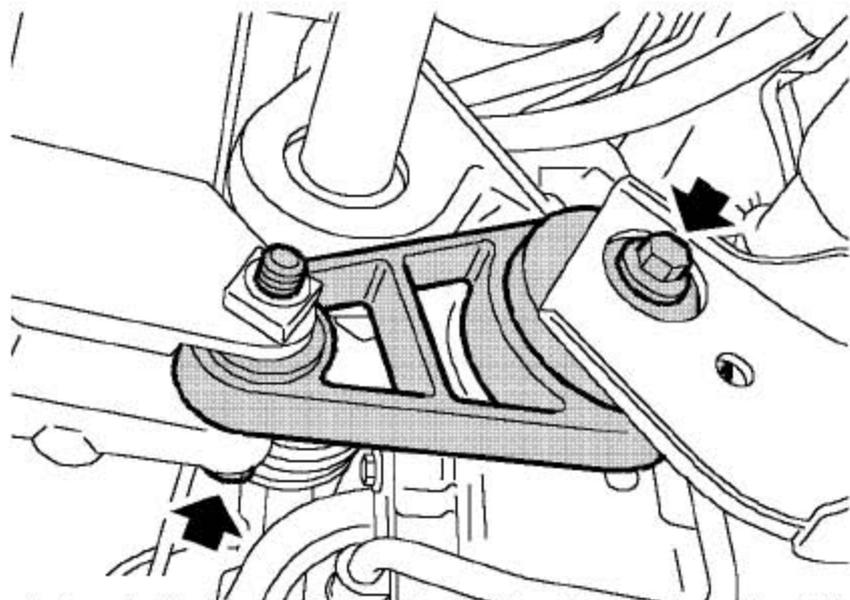
43). 拿开把发动机下后系杆固定到油底壳和副车架上的2个螺栓，拿开下后系杆。
