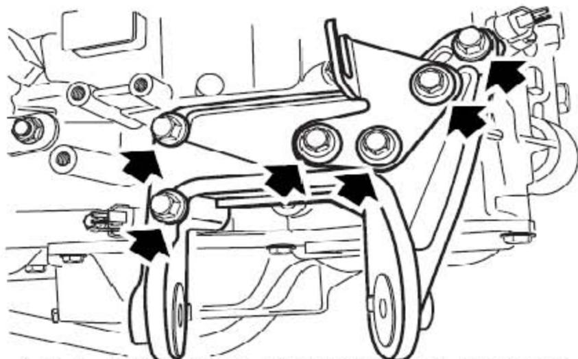
77). 拿开6个固定变速器左安装支架到变速器上的螺栓并拿开支架。
