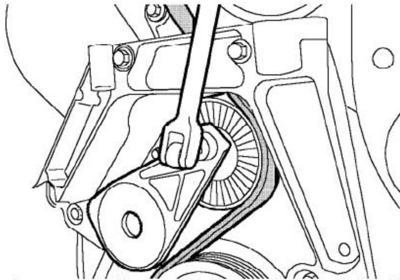
27). 用一“3/8”的方形驱动套筒杆，提起辅助驱动皮带张紧器，从皮带轮上松开驱动皮带。
