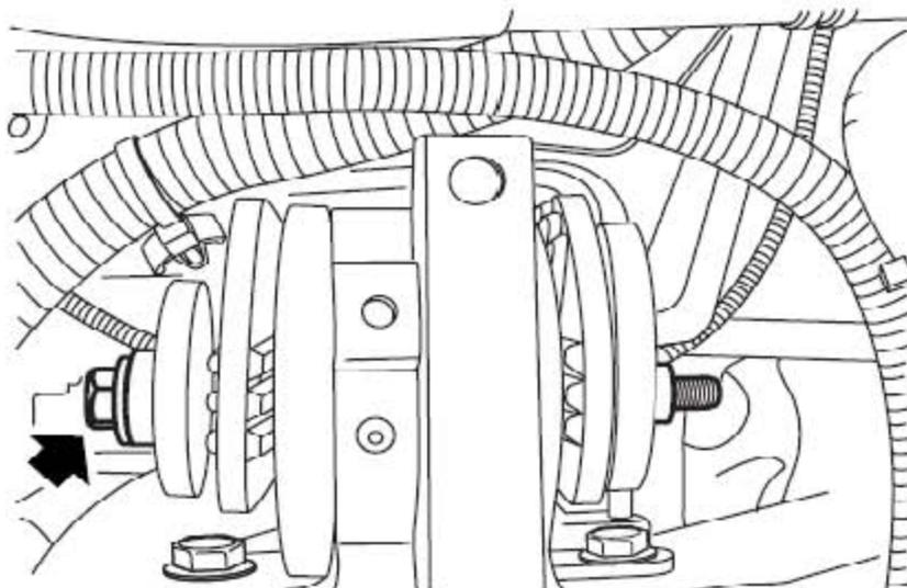
6). 拿开把发动机左安装支架固定到变速器左液压安装支架的贯穿螺栓。
