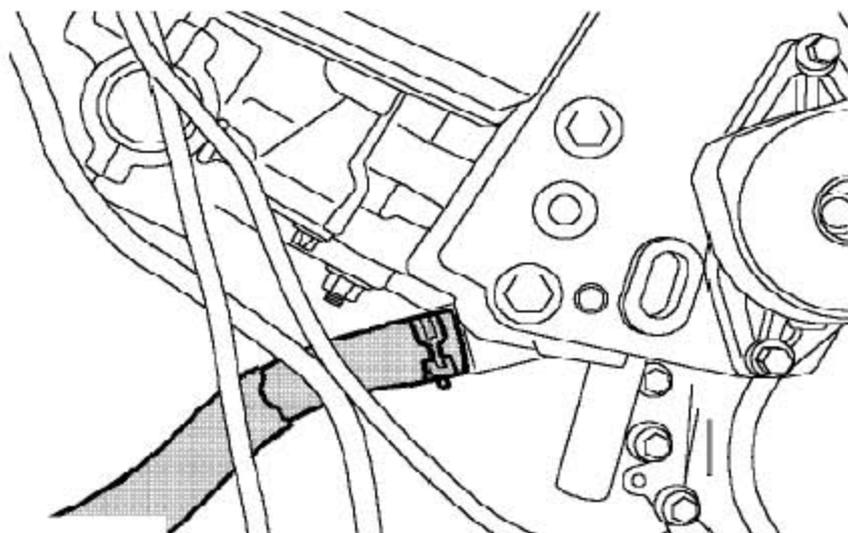
79). 提升单元，松开夹子，并从缸体后面断开加热器供给软管。
