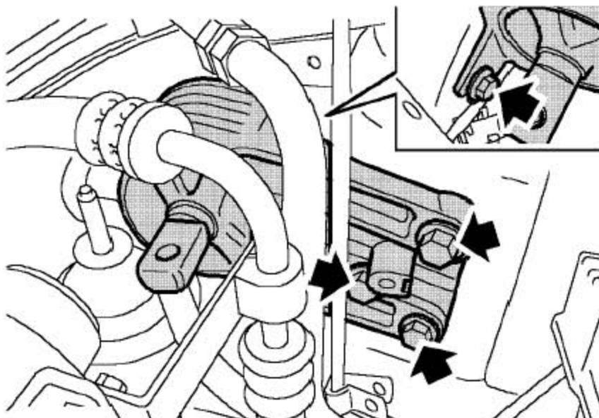
3). 拿开把发动机右系杆固定到车身上的4个螺栓，拿开右系杆。
