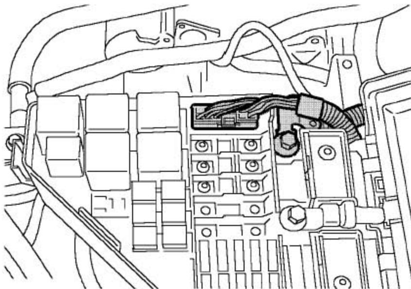
14). 拿开螺栓并从发动机罩下面的保险丝盒上断开蓄电池导线的连接。
