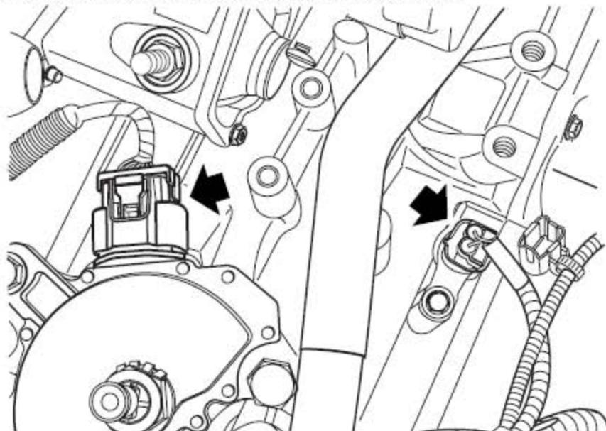
17). 松开并断开2个变速器线束连接器的连接。
