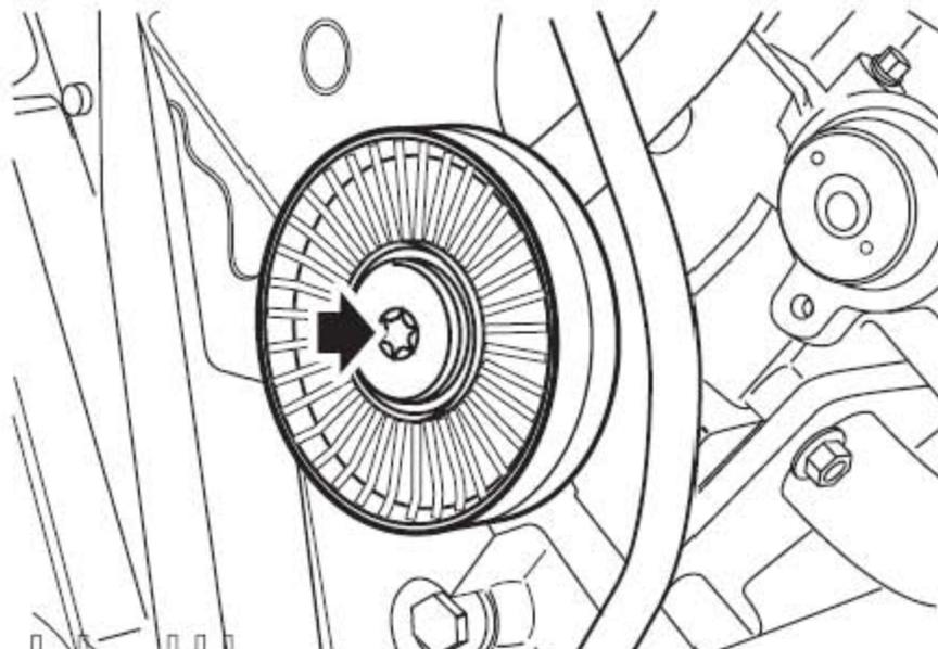
28). 拿开固定辅助皮带惰轮的Torn 螺栓，拿开皮带轮。
