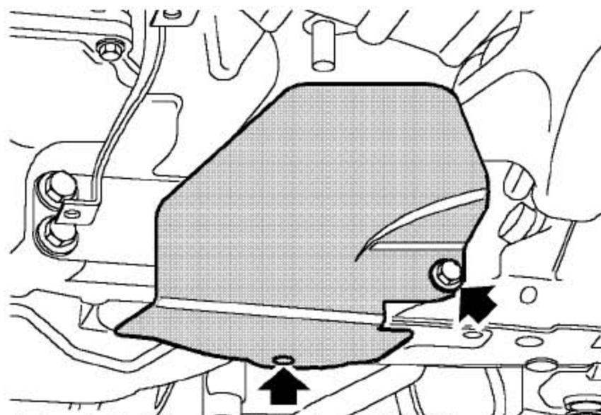
42). 拿开螺栓并松开固定发动机加强隔热罩的夹子，拿开隔热罩。
