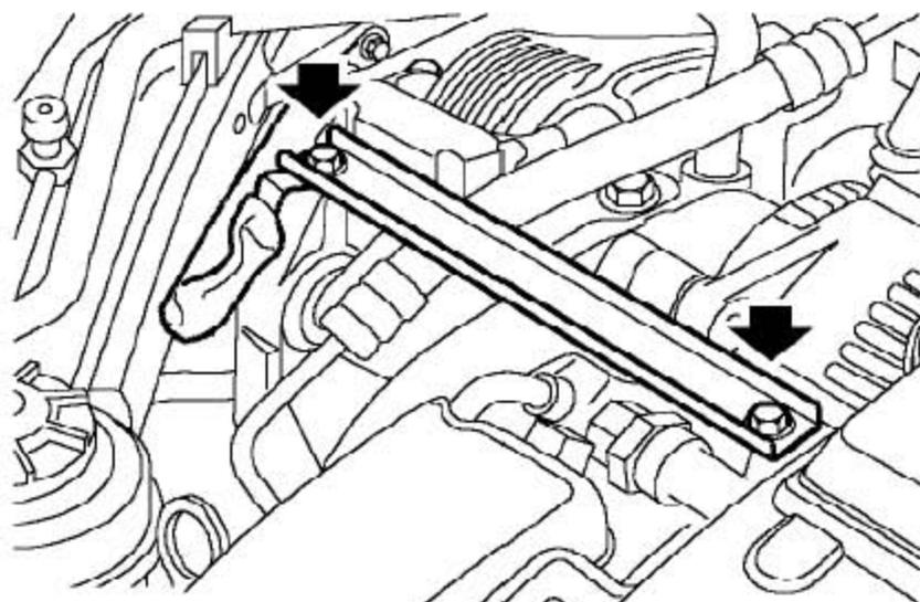
72). 拿开2 个固定发动机右跨接支架的螺栓，拿开支架并松开接地导线。
