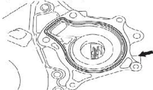
B). 用5个螺栓安装水泵总成。
