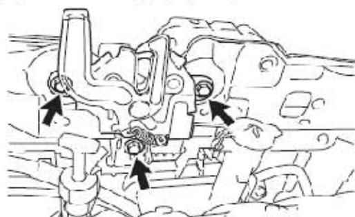
11). 拆卸散热器上支撑件减震器
