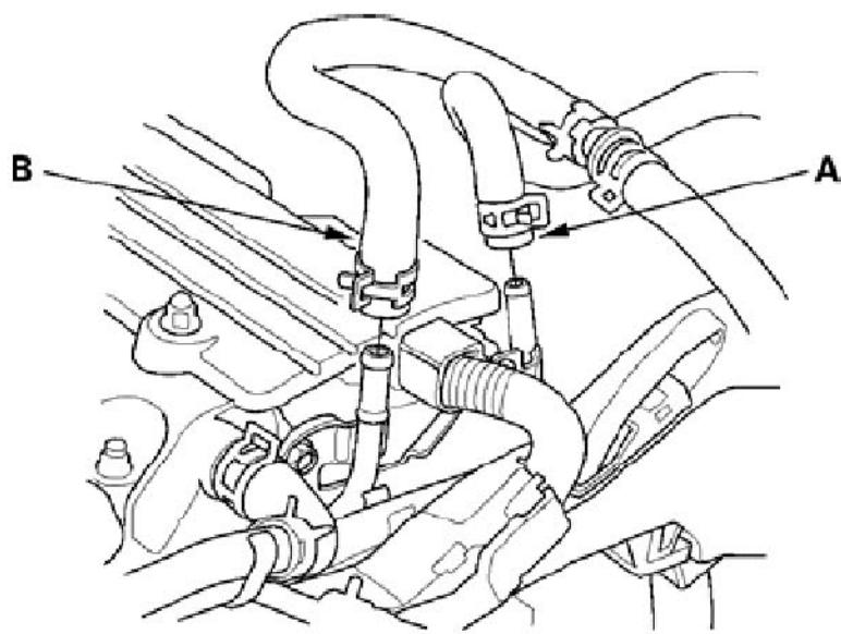
16) . 拆下快速接头盖(A)，然后断开供油软管。
