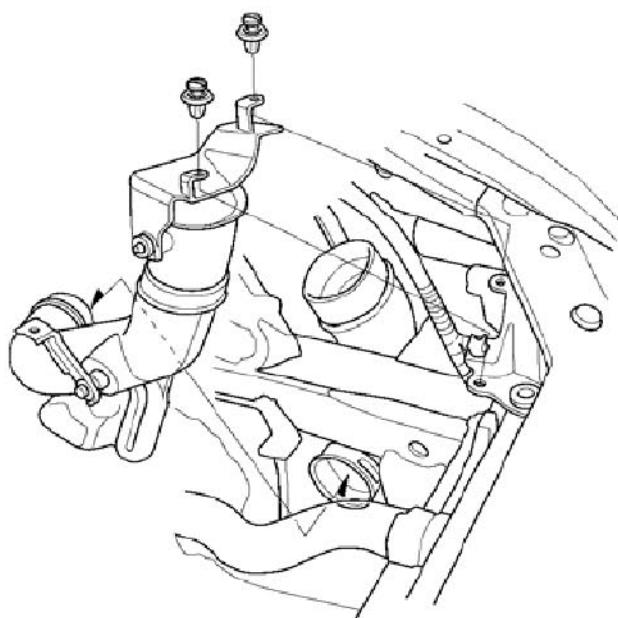
15) . 断开燃油蒸发排放(EVAP)活性炭罐软管(A)与制动助力器真空软管(B)。
