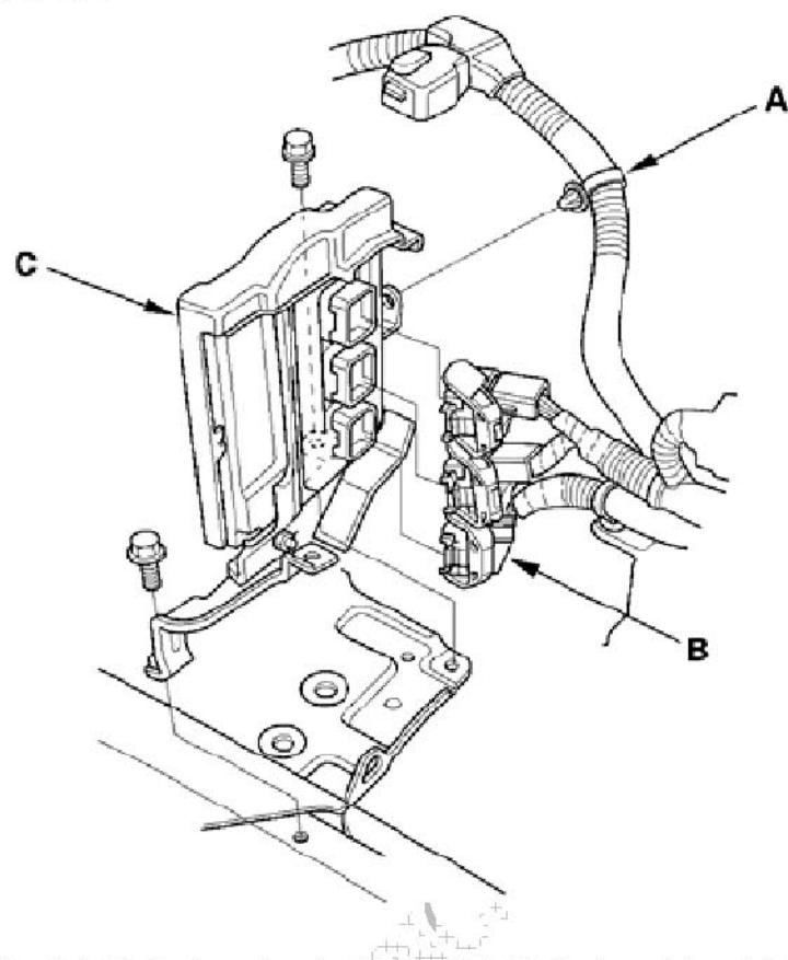
7) . 断开发动机控制模块( ECM)/动力系统控制模块( PCM)插头(B)。
