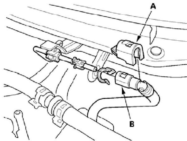
17) . M/T 型：拆下换档拉线。
