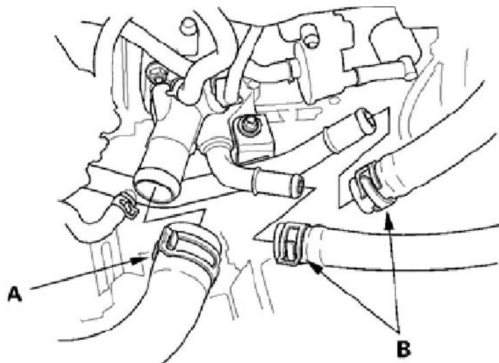
37) .清除快速接头、节温器罩和下部散热器软管上的污垢。拔出闭锁，然后将快速接头摇松并从节温器上拆下。不要使用任何工具拆卸快速接头。
