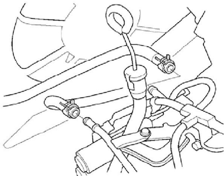
36) .拆下散热器上部软管(A)与加热器软管(B)。
