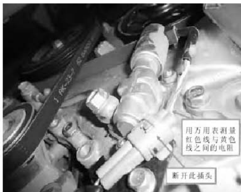
图 4 测量 VVT 控制阀电阻值
