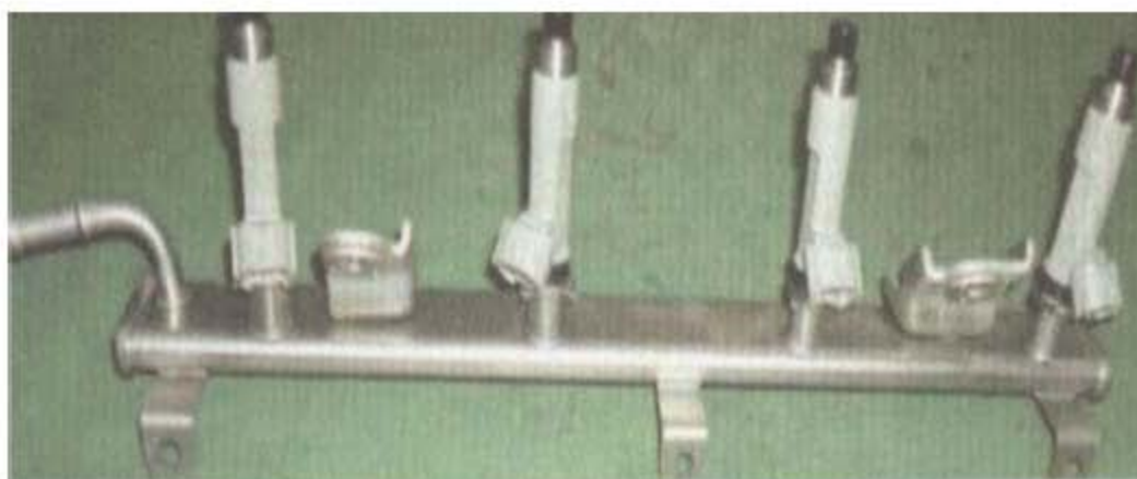
图 2 天语 1.6 L 车发动机的供油管总成和喷油器
