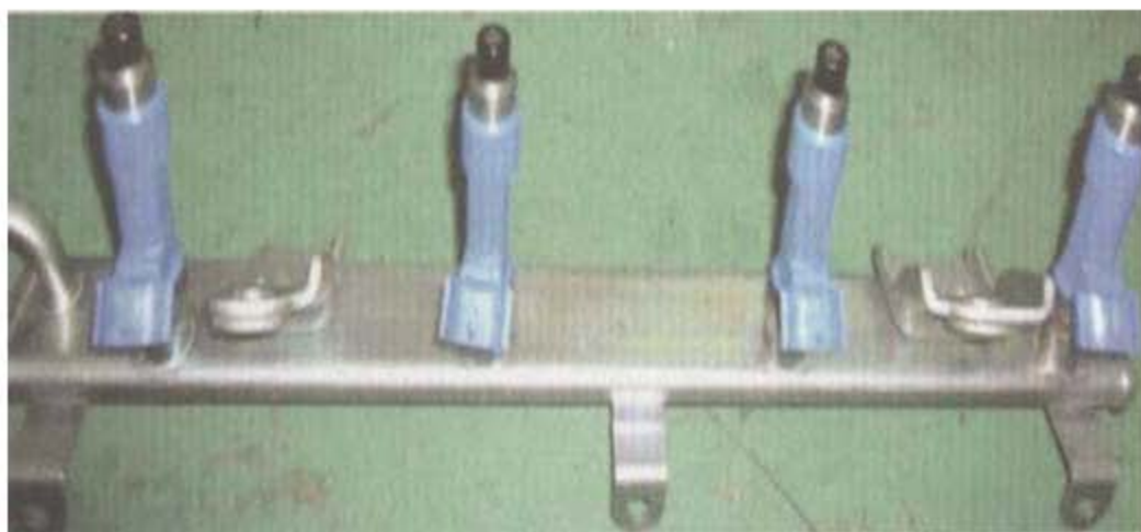
图 1 天语 1.8 L 车发动机的供油管总成和喷油器
