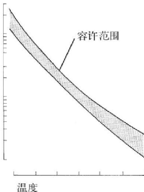
TCM通过TCM的端子OIL对温度传感器施加电压。传感器电阻随着变速器油温度的改变而改变。随着温度升高，传感器电阻减小。传感器的一个端子搭铁，所以随着温度升高，传感器电阻减小，电压降低。TCM根据电压信号计算油温。
