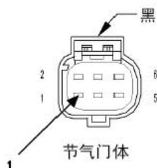
4). (K22) 1号节气门位置传感器信号电路断路
