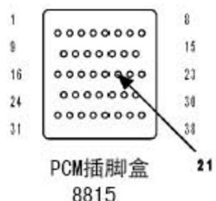
5). (K22) 1号节气门位置传感器信号电路对 (F855) 5伏特电源电路短路
