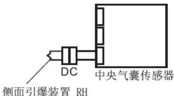
A). 将连接器 B 中已解除的激活防止机构恢复到初始状态。
