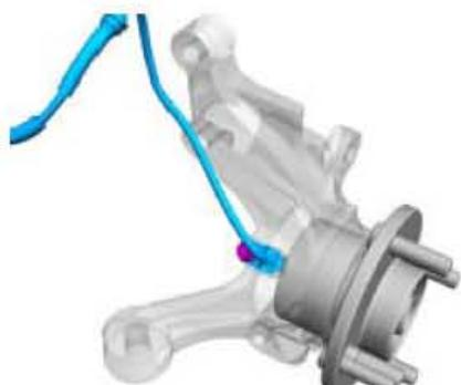
防抱死制动系统传感器环置于前轮轴承中的密封件内。使用一根单独的连接电缆，将车轮传感器连接至主线束。
