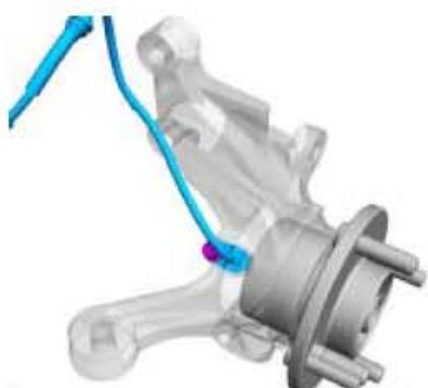
有源传感器用于测定轮毂处的车轮转速。点火接通之后，防抱死制动系统（ABS）模块将向传感器供电。传感器依照霍尔效应原理工作，并产生方波输出信号。信号活动与传感器环的转速成比例。防抱死制动系统（ABS）传感器环安装于前轮轴承密封内。防抱死制动系统（ABS）模块评估来自四个传感器的信号，以计算基于所有车轮转速的车速信号。路上速度被传输至控制器局域网（CAN）总线。动力控制模块将使用这一信号及程序化的轮胎尺寸来计算车速。计算出来的车速被送到控制器局域网（CAN）总线，并被需要该输入信息的其它控制单元获取。
