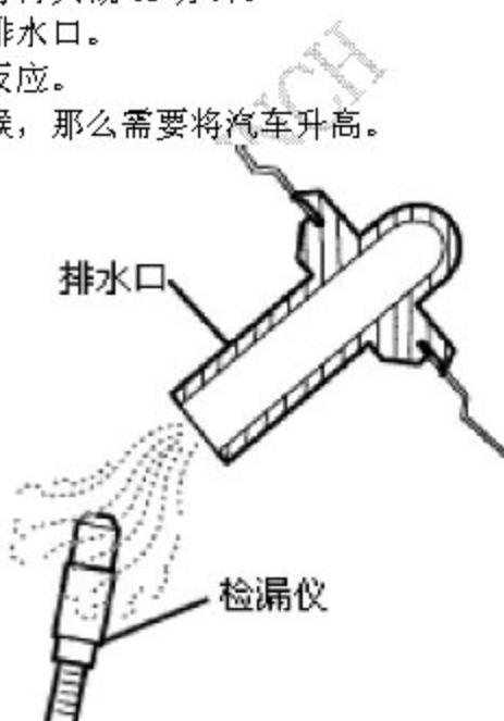
如果检漏仪在排水口无反应，将鼓风机从箱体上拆下来。将检漏仪插入箱体
