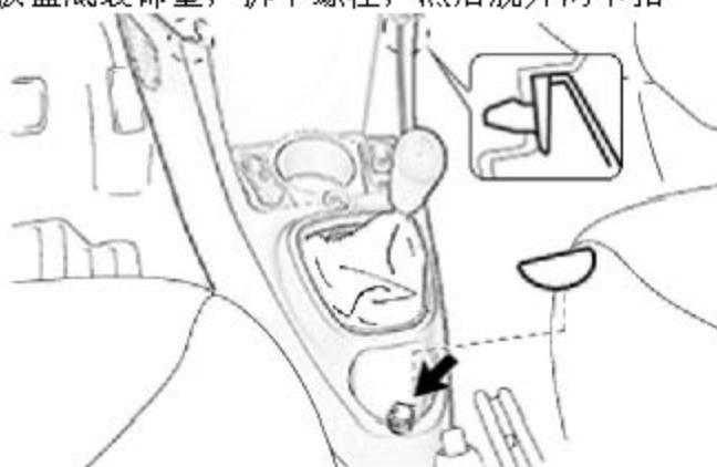
C).脱开电动窗开关接插件，并将副仪表板拆卸下来
