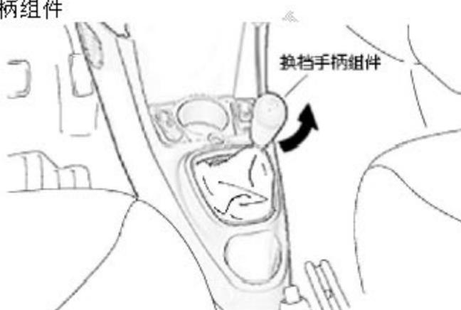
B).取下副仪表板盒底装饰垫，拆下螺栓，然后脱开两卡扣
