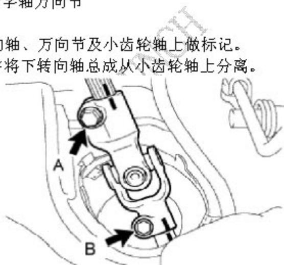
27). 拆除转向管柱总成
