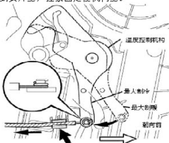
14). 连接内外循环风门控制拉索
