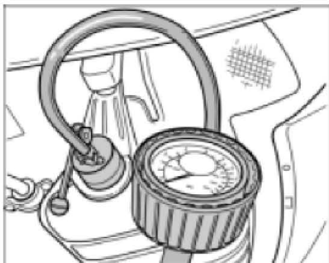
测试阀上的轮胎充气设备
