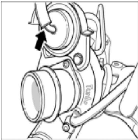
从旁通阀的真空单元上拆下软管
