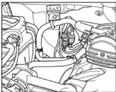
放水板处的氧传感器接头
