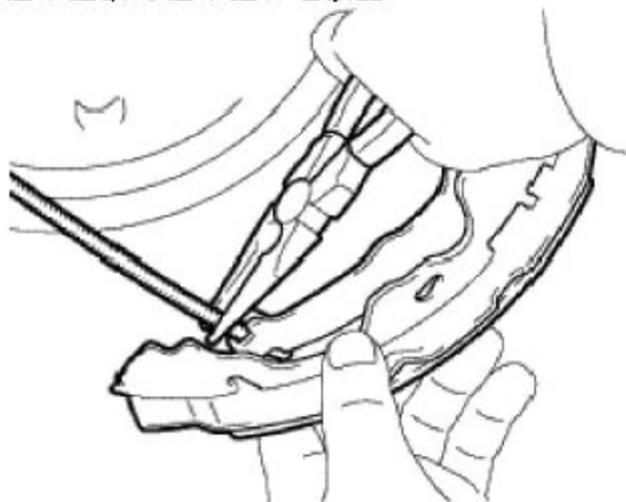
B). 用钳子安装上制动蹄 销 支撑弹簧和支撑弹簧座。
