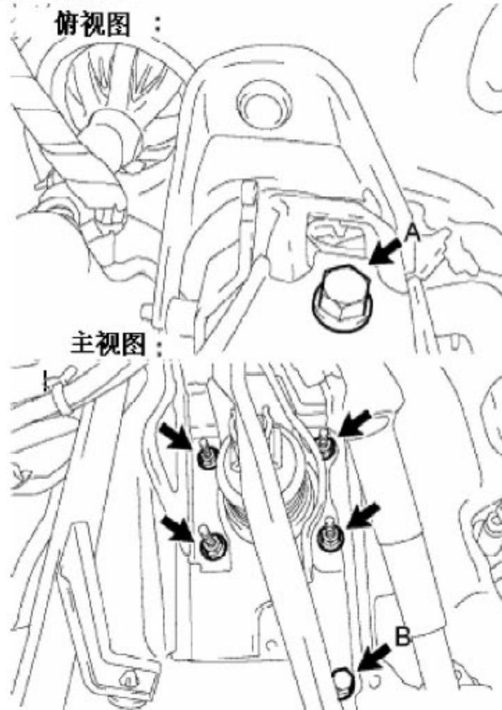
3).安装真空助力器推杆 U 形铁
