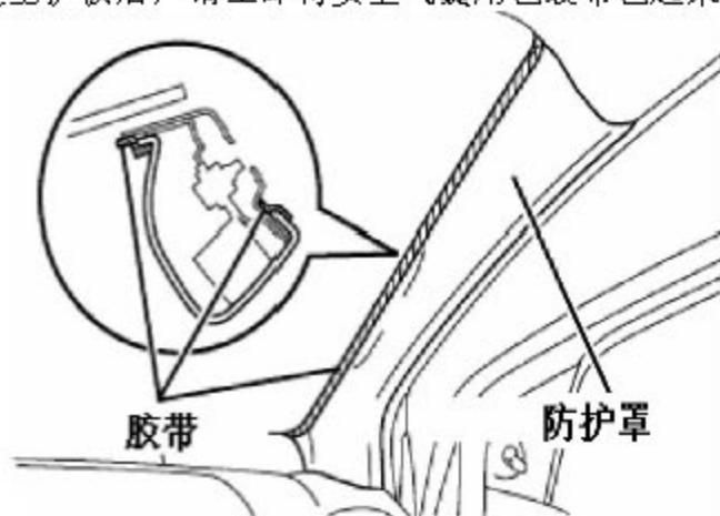
6).用缠好胶布的平口螺丝刀撬开音响罩
