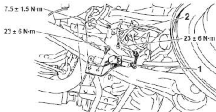
1. 后部高度传感器 2. 后部高度传感器支架
