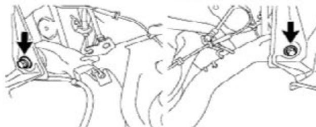
17). 充分拧紧左后减振器总成充分拧紧两个螺栓。
