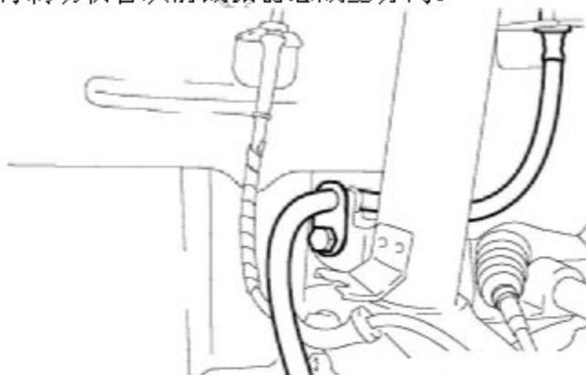
B). 拆除两个螺母并将盘式制动器卡钳从转向节上分离。
