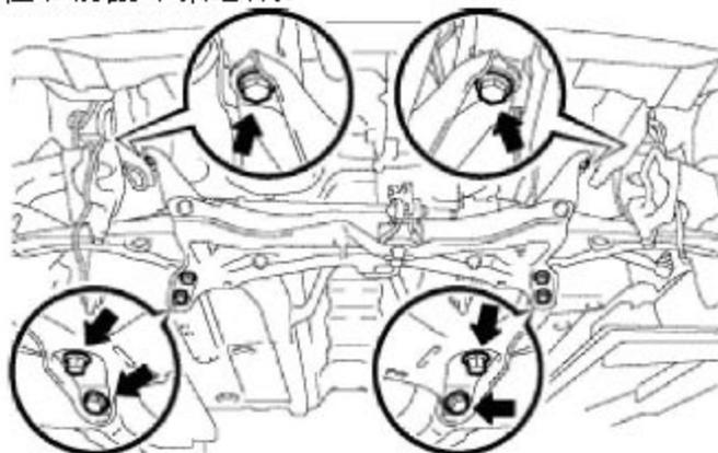
12). 拆除转向器总成方法参照转向系统转向器的拆卸一节。
