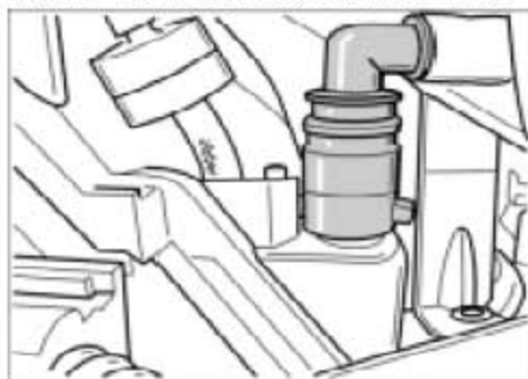
吸气模块后侧的真空管路
