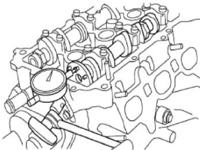
如果测量的间隙超过允许的最大间隙，则检查凸轮轴和凸轮轴轴承盖，如果凸轮轴轴承盖磨损，则更换缸盖，如果是凸轮轴止推面磨损，则更换凸轮轴。
