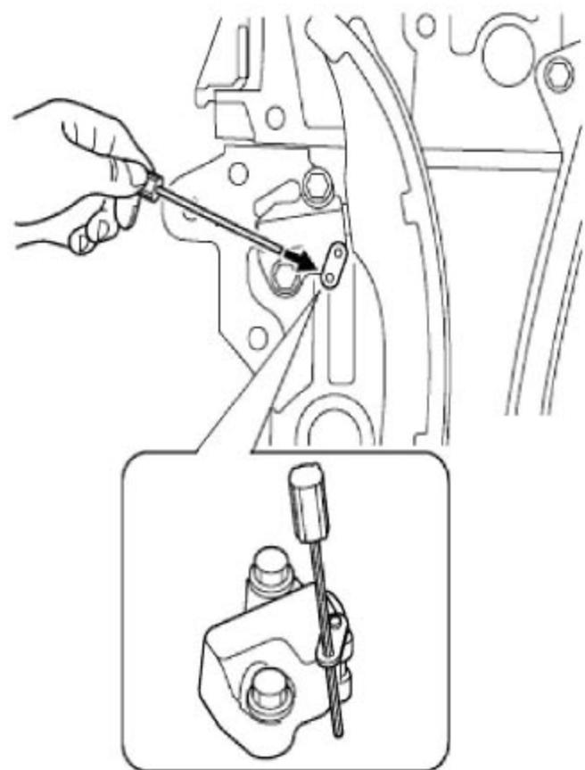
C). 卸下张紧板螺栓，取出张紧板，取下正时链条。
