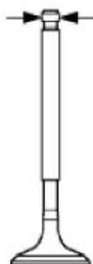
C).用游标卡尺测量气门头部边缘的厚度，如果厚度低于下列要求数值，则更换气门。
