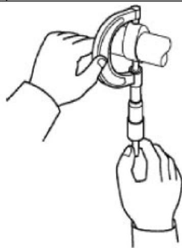
C). 测量凸轮轴的轴向间隙：
