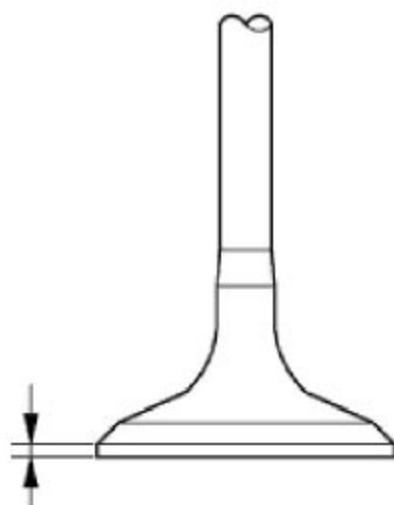
D).用游标卡尺测量气门头部的直径，如不符合下表的数值，则更换气门。
