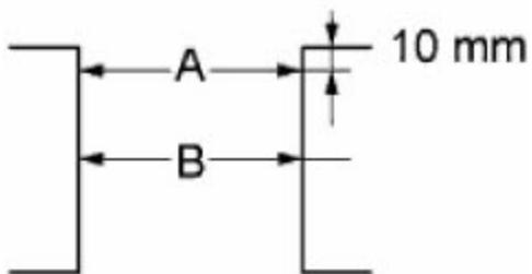
B). 在下图所示位置测量气缸直径，计算气缸的椭圆度和锥度。
