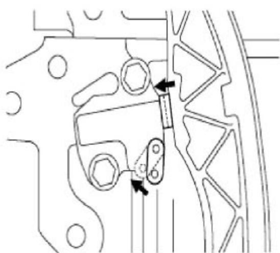
B).按紧柱塞的同时，把专用工具插入锁片中的小孔，锁定柱塞，不让其弹出；
