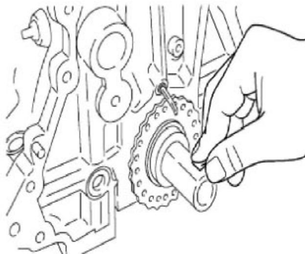
13).临时装上皮带轮螺栓，顺时针旋转曲轴约 90 度；
