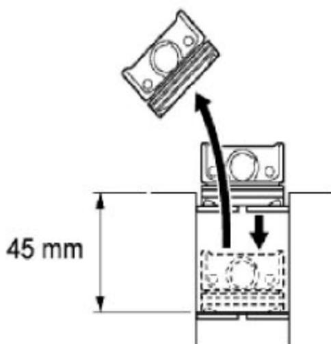
B).用塞尺，测量活塞环缺口的间隙。
