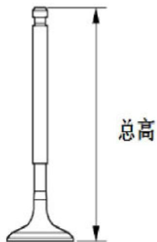
B).用千分尺测量气门尾部的直径，如果直径低于 3.9~4.5mm，则更换气门。
