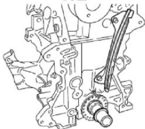
12). 卸下曲轴链轮，注意取下曲轴上的半圆键；
