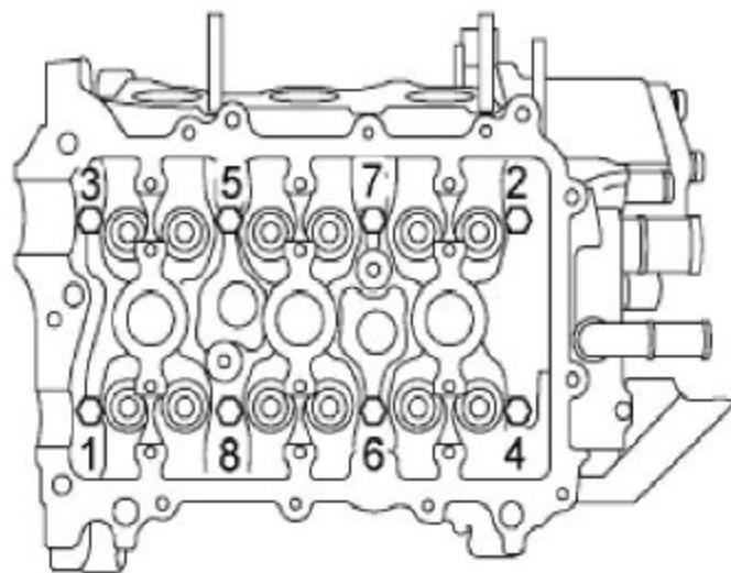
B) 然后卸下气缸盖和气缸垫。
