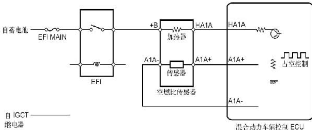
混合动力车辆控制 ECU 监视空燃比
